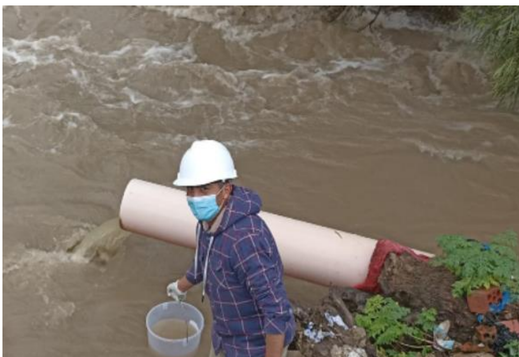
Se muestra la medición de caudal del agua residual en el punto de descarga.
