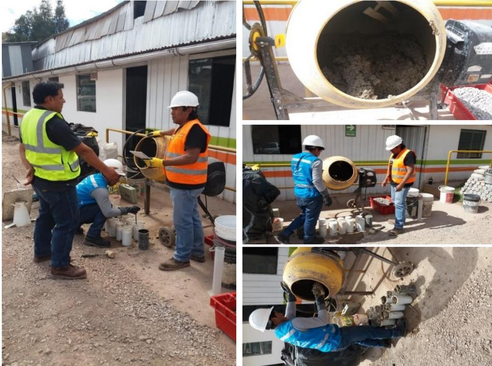
**Foto 9.** *Proceso de rotulado y curado de probetas concreto patrón y reciclado de  $f''c = 210 \text{ kg/cm}^2$  con agregado grueso reciclado en la planta Conarena – Cusco*
