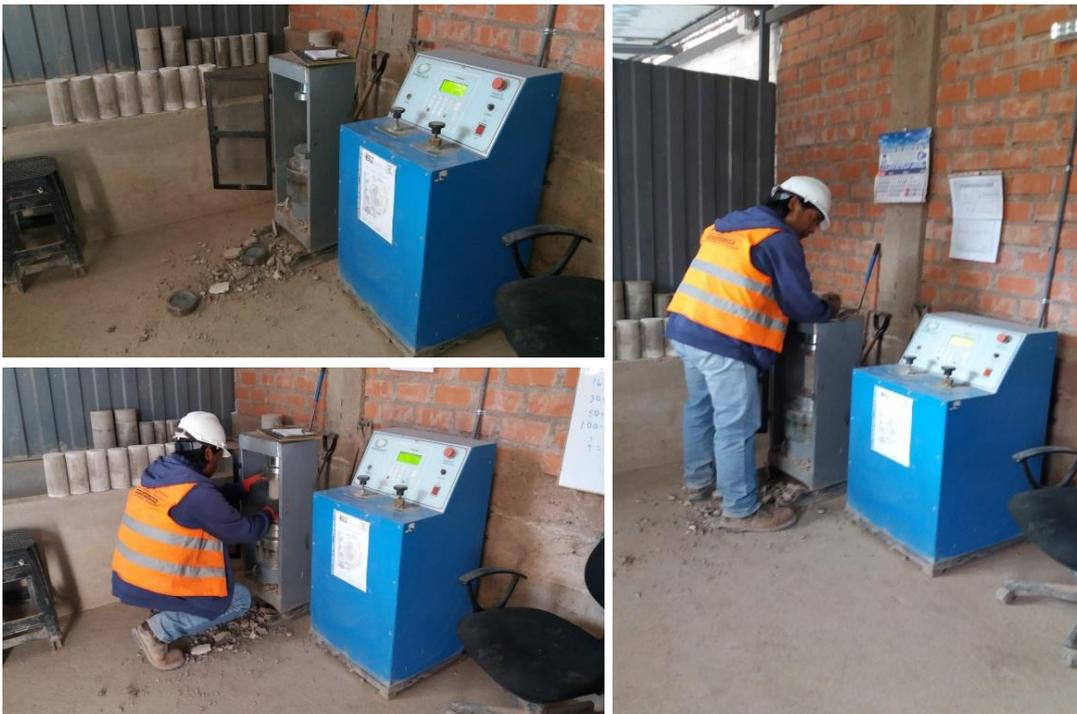
**Foto 3.** *Proceso de trituración de briquetas en la Planta de agregados SERTRAC – Huasao - Cusco*
