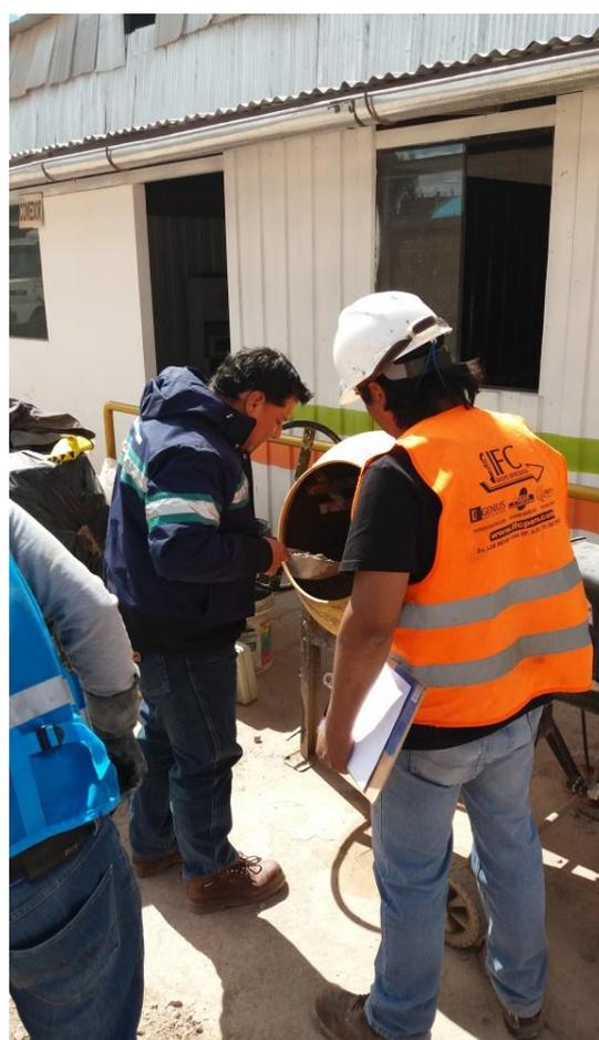
**Foto 7.** Proceso de pruebas y control cono de abrams y prueba de contenido de aire, por el método a presión del concreto patrón y reciclado de  $f'c = 210 \text{ kg/cm}^2$  con agregado grueso reciclado en la planta Conarena – Cusco
