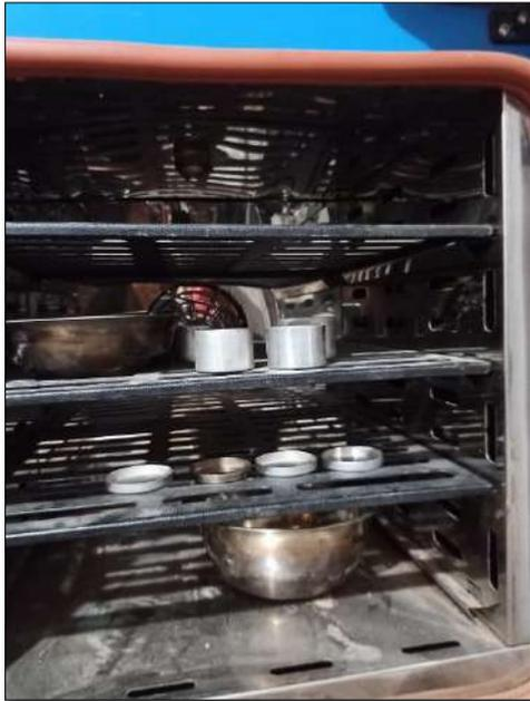
Figura 05: Proctor modificado con adiciones
