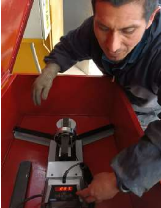
Figura 9. Calentamiento de Rodamientos por Inducción. Fuente. Empresa SELCAF S.A.C.
