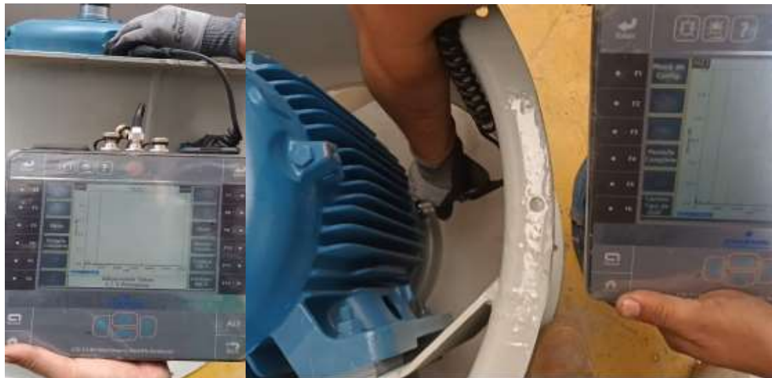
Figura 12. Conjunto de vistas en Revisión Inicial del Estado del Motor Fuente. Empresa SELCAF S.A.C.
