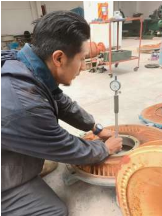
Figura 10. Medida de Tapas del Motor. Fuente. Empresa SELCAF S.A.C.
