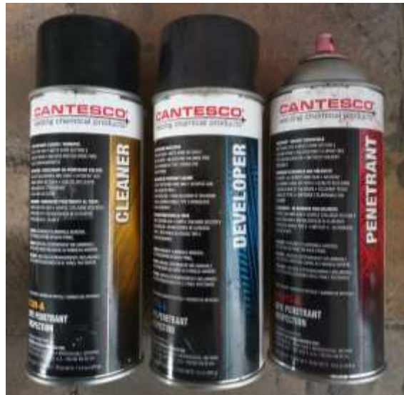
Figura 30. Identificador de Grietas, Líquidos Penetrantes.
