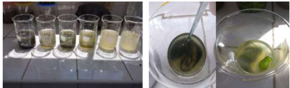
Figura 34. Muestra después de la dosificación y formación de flóculos al aplicar el mucílago de nopal.
