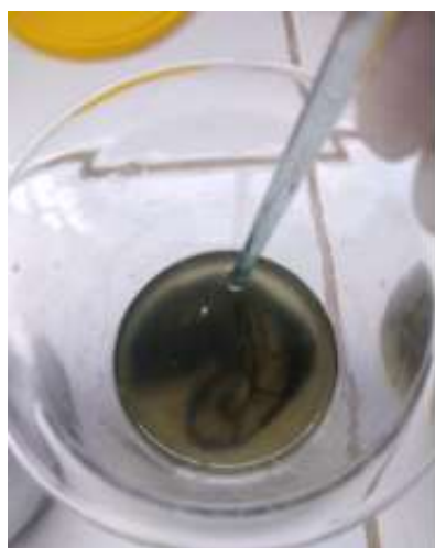
Adición del mucílago de nopal y formación de flóculos.
