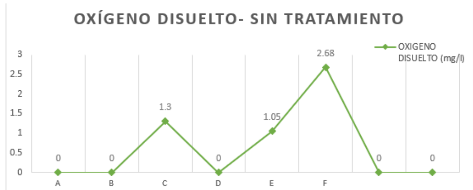
Figura 30. Resultado del análisis de oxígeno disuelto sin tratamiento.
