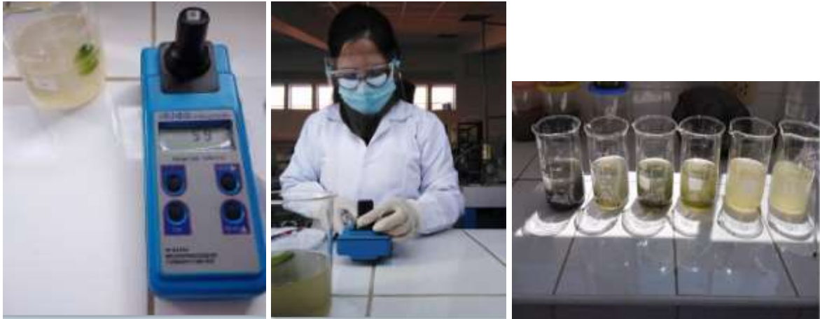
Medición de la turbidez - muestras con tratamiento y reducción de la turbidez.
