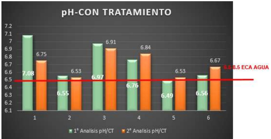
Figura 42. Resultado del análisis del pH con tratamiento.
