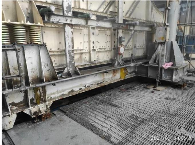
**Figura N°8.** *Conjunto Bastidor - Zaranda Húmeda.*
