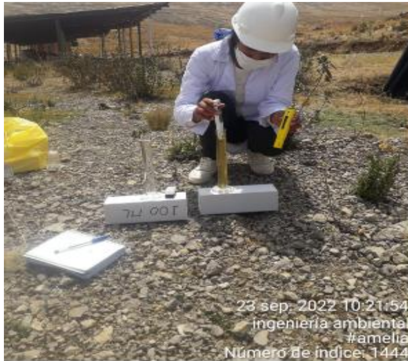
Uso de los equipos como el pH-metro y conductímetro en los lixiviados
