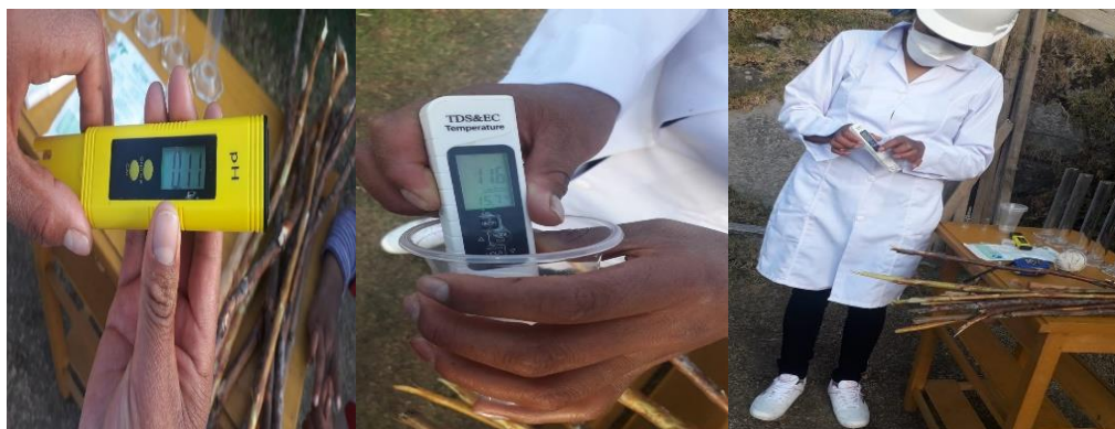
Calibración de los equipos pH-metro y el conductímetro con agua destilada.
