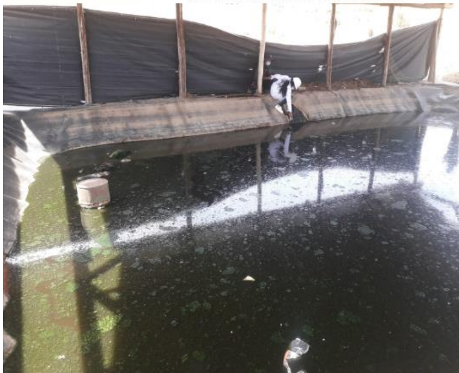
Colocación de las estacas para realizar los trazos en zigzag y toma de muestras.
