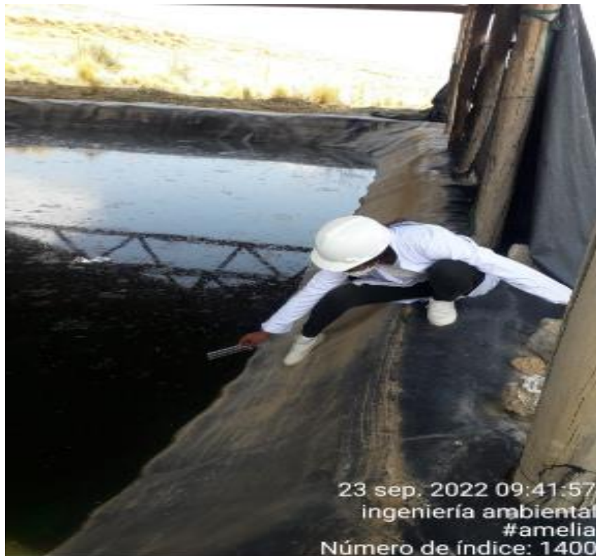
Toma de muestras en el pozo de lixiviado en el punto de origen (punto N°1)
