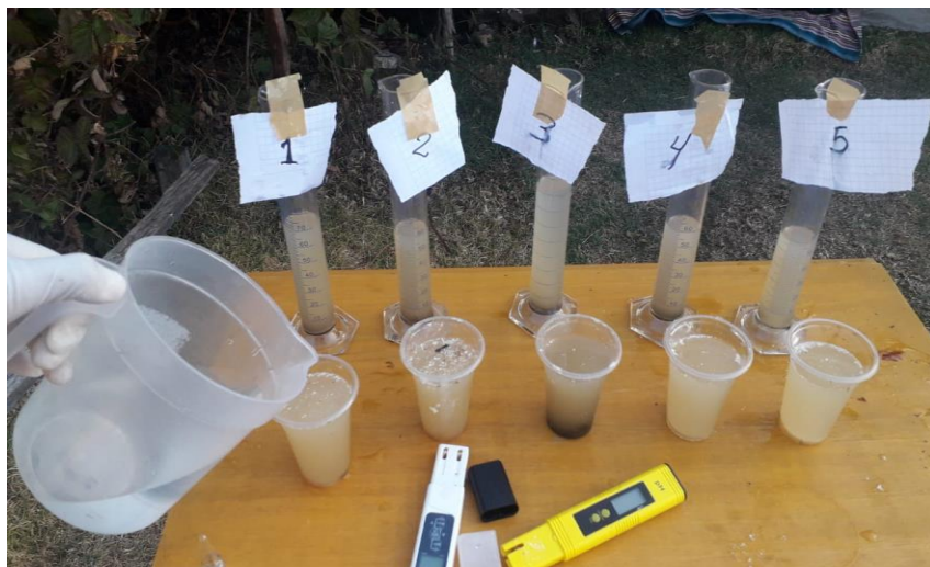
Las muestras separadas con lixiviado se mezclan con agua natural
