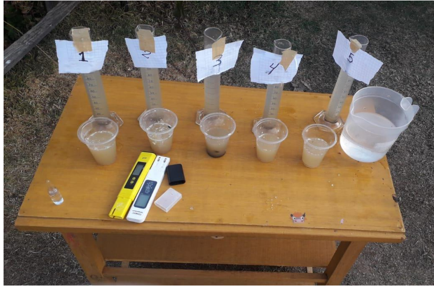
De las muestras que están en las probetas de 100 mililitros se separa 1/3 de lixiviado de relleno sanitario en los vasos
