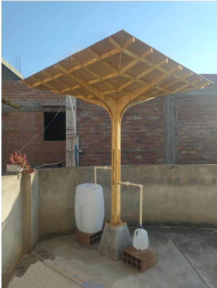
Fotografía que muestra el modelo a escala de CUS instalado en campo para captación y registro de las precipitaciones.
