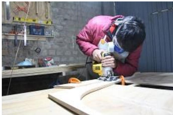
Fotografía que muestra los cortes a detalle para el encaje de las piezas del soporte central
