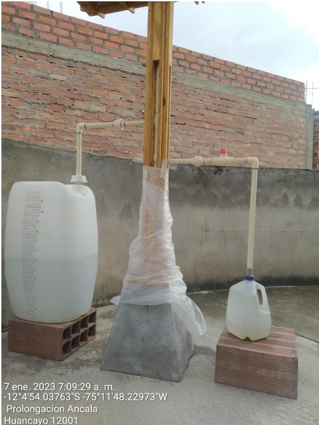
Anexo 1.10. Pluviómetro artesanal instalado
