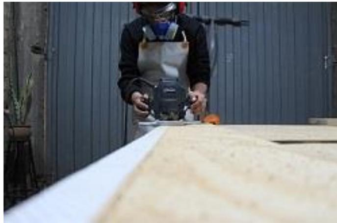
Fotografía que muestra el inicio de cortes rectos de las piezas apoyados con ruteador.
