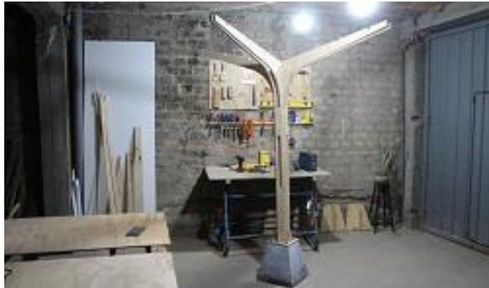
Fotografía que muestra una vista general del soporte anclado a la base de concreto como una prueba de estabilidad.
