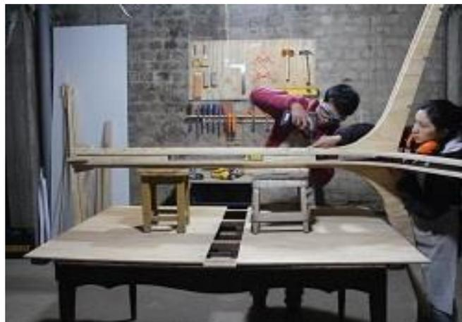
Fotografía que muestra el ensamble del soporte central.
