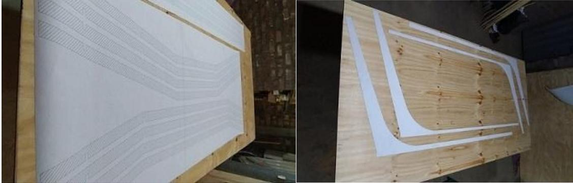
Fotografías que muestran la presentación de las piezas impresas a escala de la trama estructural y soporte sobre las planchas de contrachapado de pino de 15 mm.
