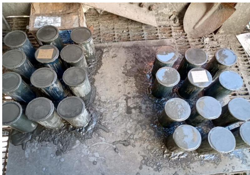
Figura 20. Toma de muestras de relleno en probetas Tomada de Operaciones mina
