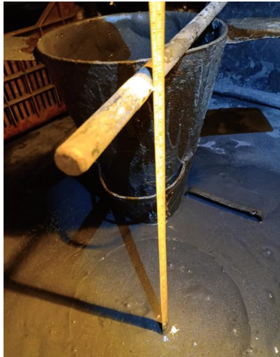
Figura 19. Cono de Abraham's para el ensayo del slump Tomada de Operaciones mina
