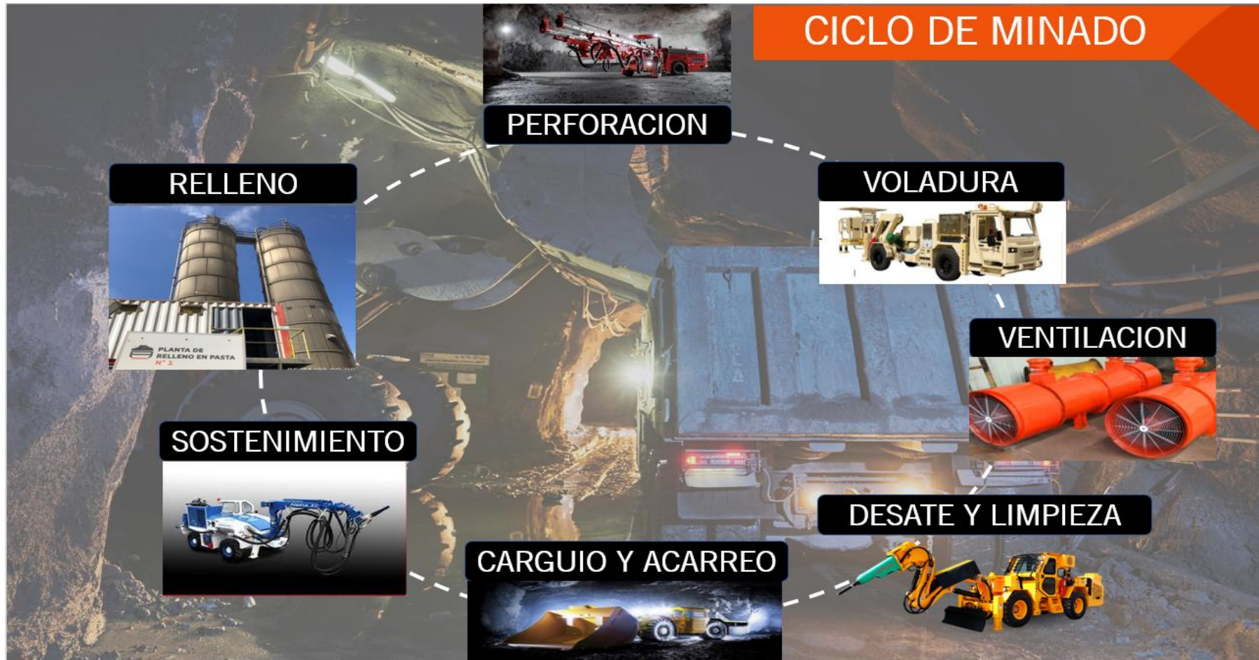
Figura 8. Ciclo de minado en la unidad minera Cerro Lindo Tomada del departamento de Planeamiento
