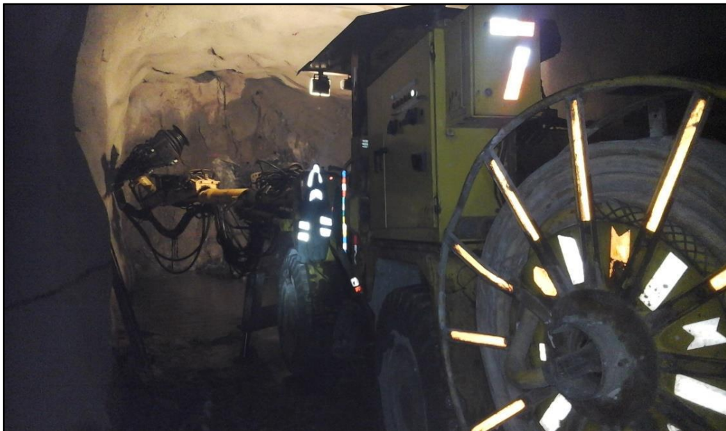
Figura 9. Jumbo hidráulico de 2 brazos, en la unidad minera Cerro Lindo Tomada del departamento de Geomecánica
