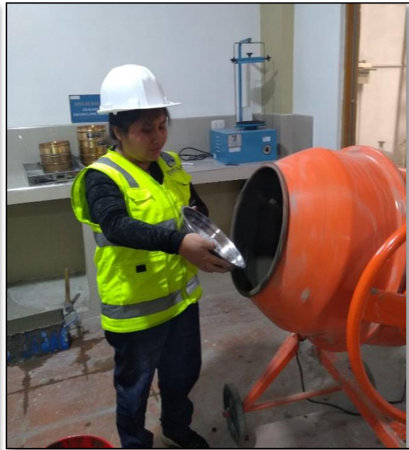
Anexo 50A. Adición de la ceniza de cabuya al concreto.
