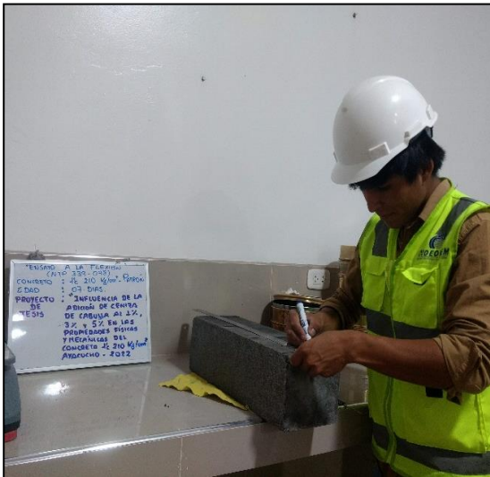
Anexo 57A. Medición de viguetas para posteriormente realizar en ensayo a flexión.
