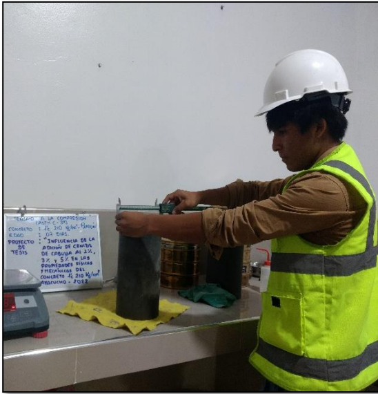
Anexo 56A. Medición del diámetro para posteriormente realizar el ensayo a compresión.
