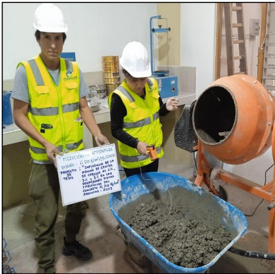
Anexo 51A. Ensayo de temperatura del concreto en estado fresco.
