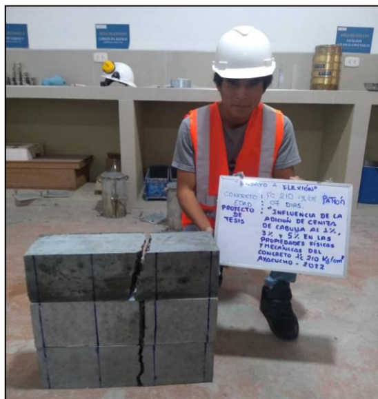
Anexo 58A. Fallas de probetas y viguetas.
