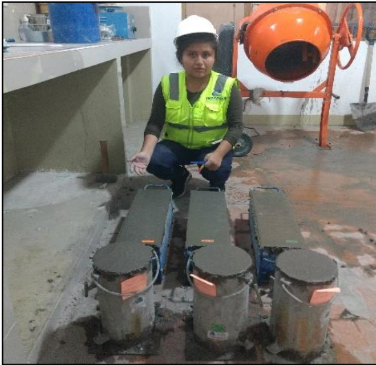
Anexo 54A. Preparación de probetas cilíndricas y vigas de concreto.
