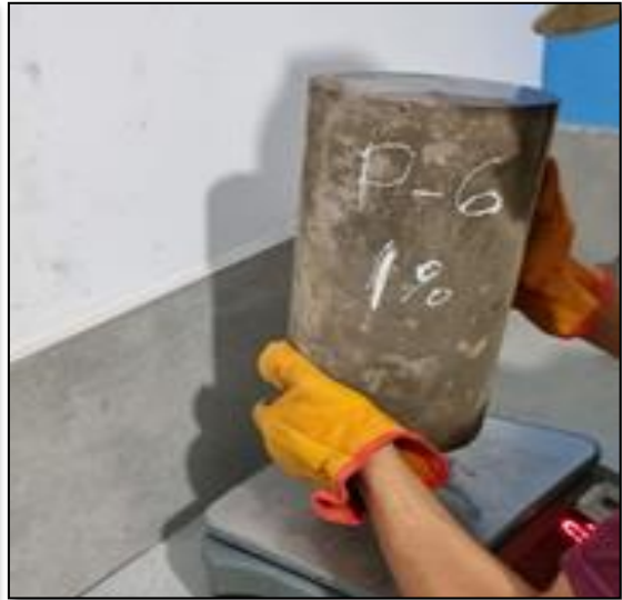
Anexo 59A. Término del proceso de saturación y pesado de probetas.
