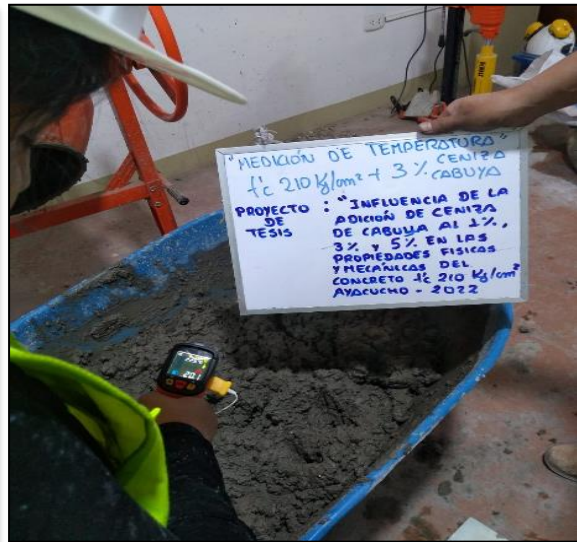
Anexo 51A. Ensayo de temperatura del concreto en estado fresco.
