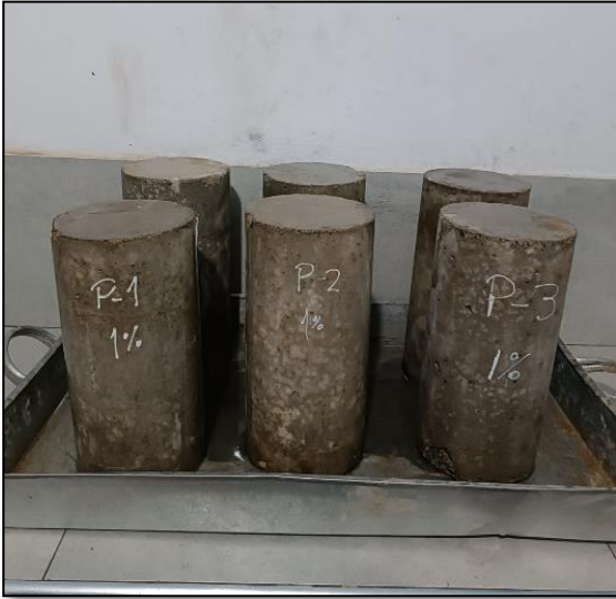
Anexo 59A. Término del proceso de saturación y pesado de probetas.
