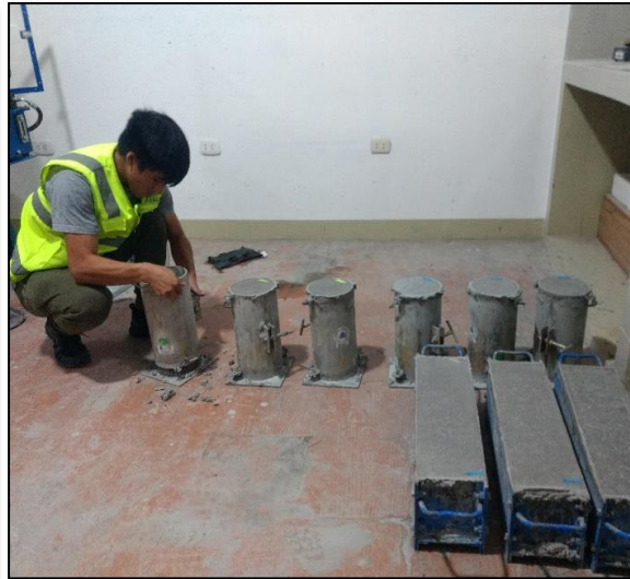
Anexo 54A. Preparación de probetas cilíndricas y vigas de concreto.
