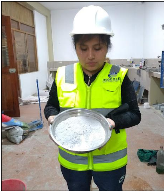
Anexo 50A. Adición de la ceniza de cabuya al concreto.
