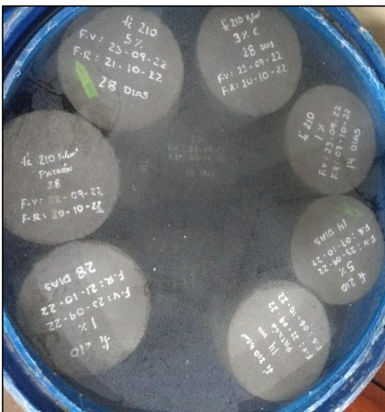
Anexo 55A. Curado de probetas y viguetas.
