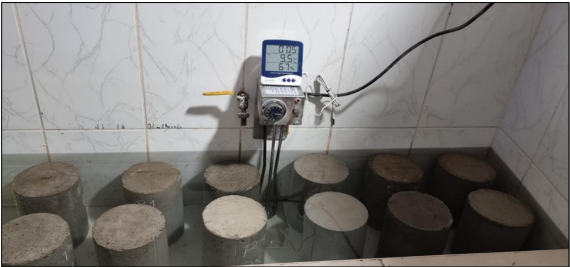
Anexo 60A. Cámara climática para hielo/deshielo.
