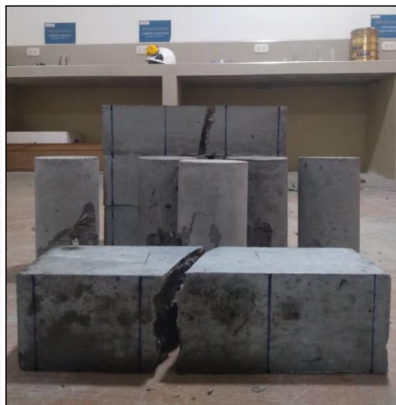
Anexo 58A. Fallas de probetas y viguetas.
