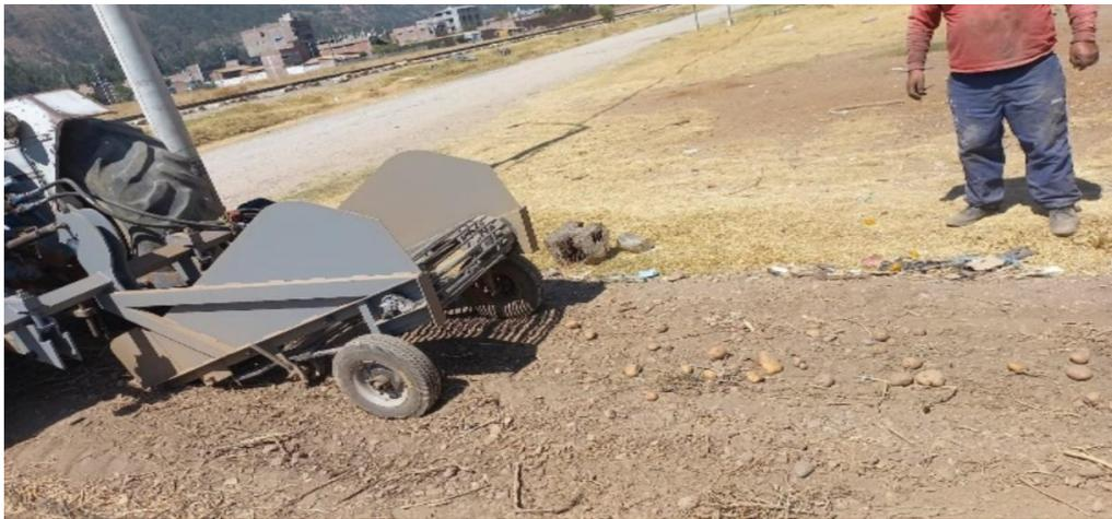
*Figura 81. Se realiza la primera prueba del prototipo donde se evidencia el descubrimiento de las papas, pero se tubo dificultad con la válvula reguladora de caudal (no controlada)*
