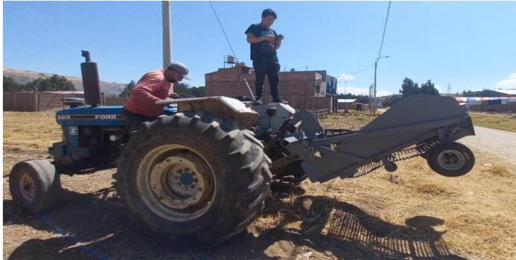
*Figura 80. Se realiza el ensamblaje de los tres puntos al tractor de 65HP*
