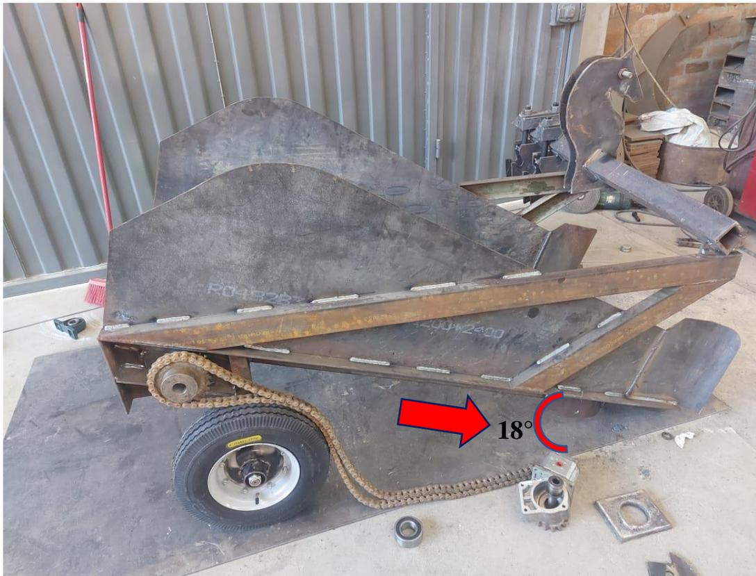
*Figura 79. Se realiza el armado del bastidor respetando los 18° de inclinación*
