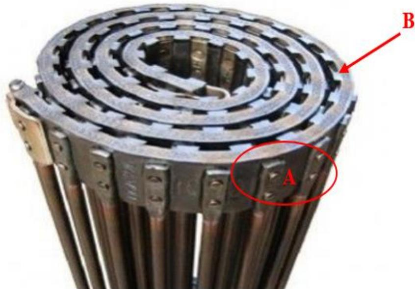
*Figura 22. Modelo de cadena transportadora de varillas de superficie lisa unidas por una cinta de lona
