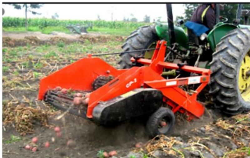
*Figura 4. Máquina cosechadora de papa de cadenas metálicas modelo CP-1
