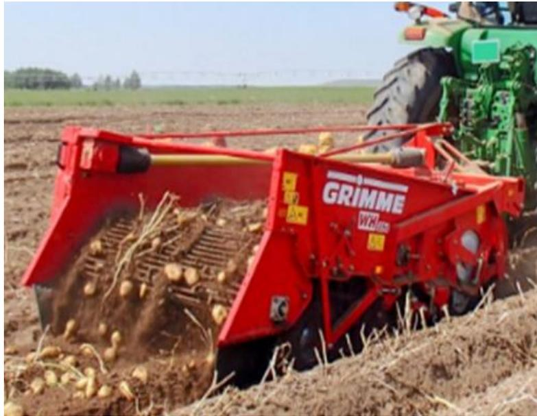
*Figura 36. Máquina recolectora de papas de 2 hileras modelo WH-200 Tomada de Grimme (59)*
