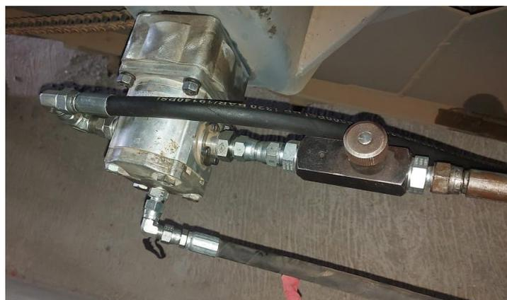
*Figura 82. Se realiza el mantenimiento de la válvula reguladora de caudal*
