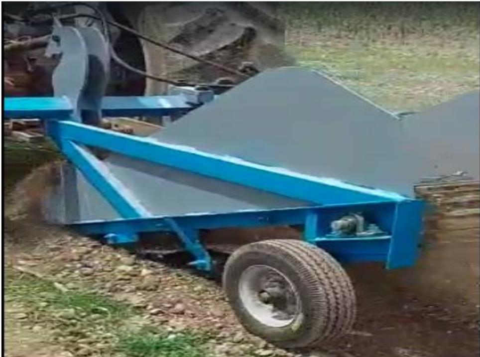
*Figura 84. Se realiza la segunda prueba del prototipo evidenciado el funcionamiento de la válvula reguladora de caudal teniendo un control de la velocidad de la cadena transportadora*
