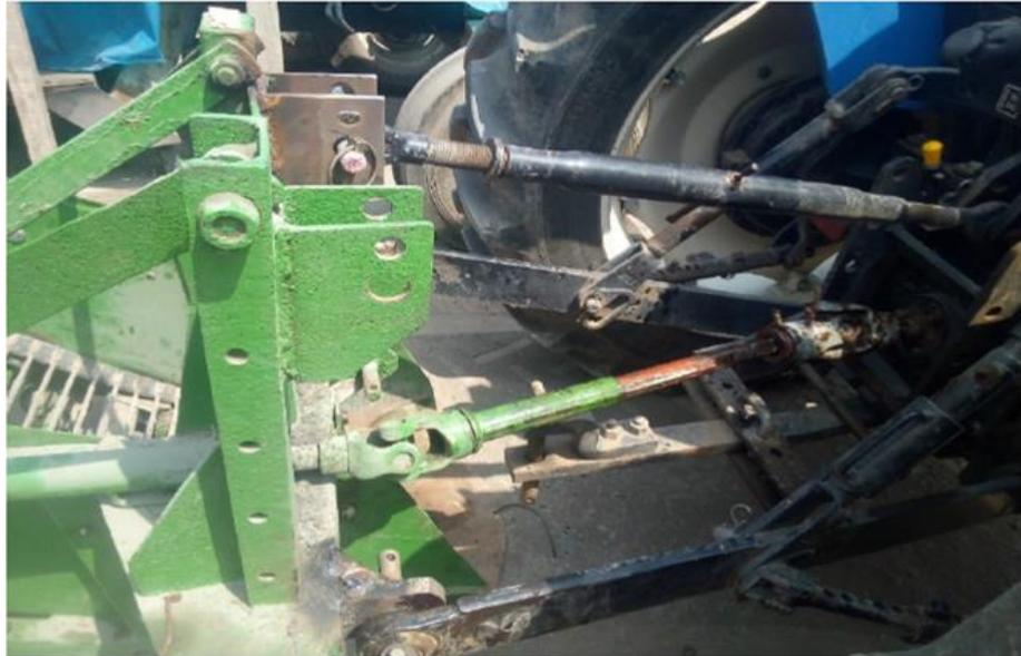
*Figura 11. Se muestra la modificación del anclaje de 3 puntos con el tractor Tomada de Garro (19)*
