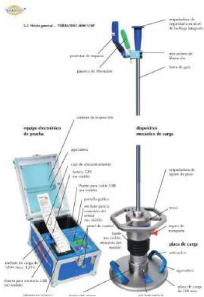
Figura 2. Equipo de deflectómetro de impacto liviano LWD. Tomada de «Manual de instrucciones de la placa de carga dinámica TERRATEST 4000 y 5000 US00 USB'B'», por TERRATEST, p. 29.
