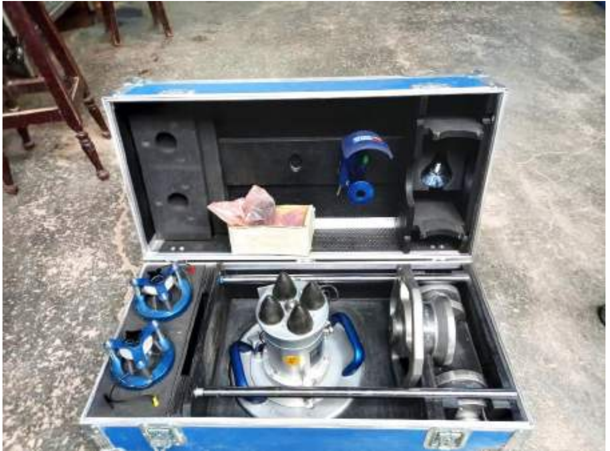
Figura 5. Equipo de deflectómetro de impacto liviano TERRATEST 9000
