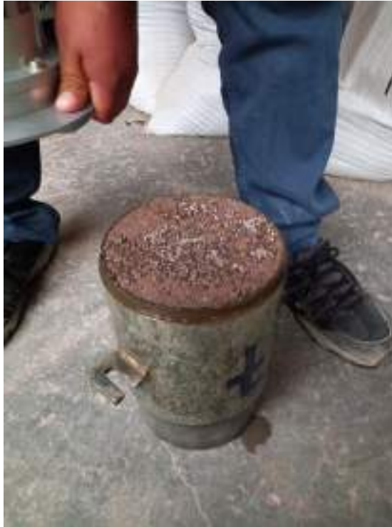
Figura 26. Preparación del molde de CBR para el ensayo de LWD
