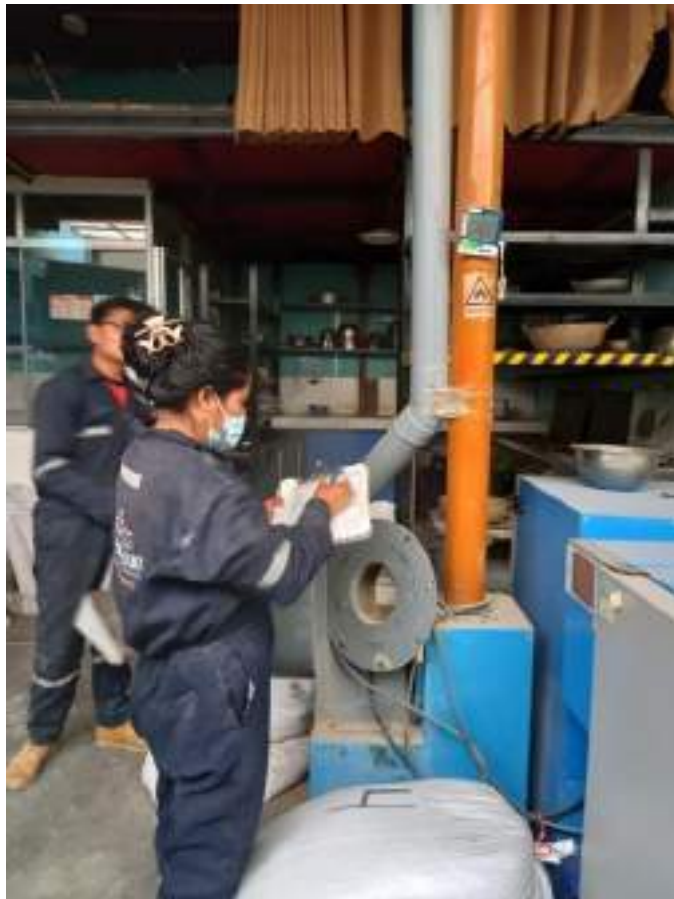
Figura 30. Vista de toma de temperatura y humedad con el equipo del termohigrómetro calibrado
