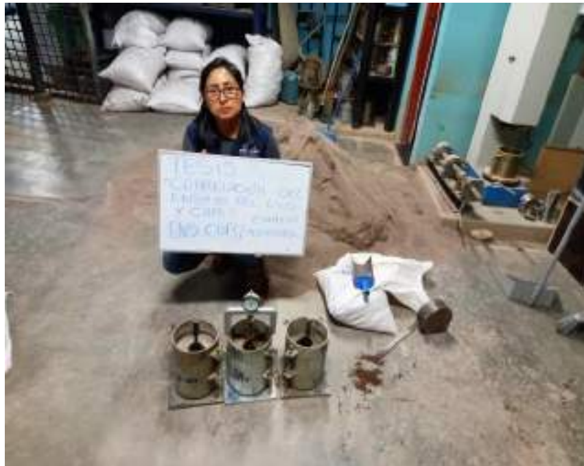
Figura 23. Vista de los moldes preparados para el ensayo de CBR
