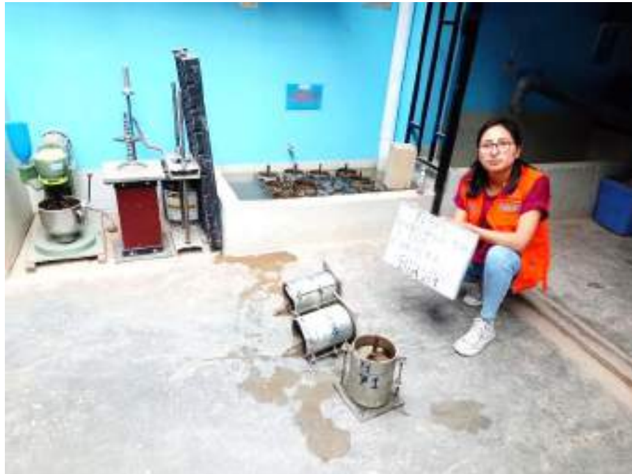
Figura 25. Reposo de los moldes de CBR luego de la sumersión
