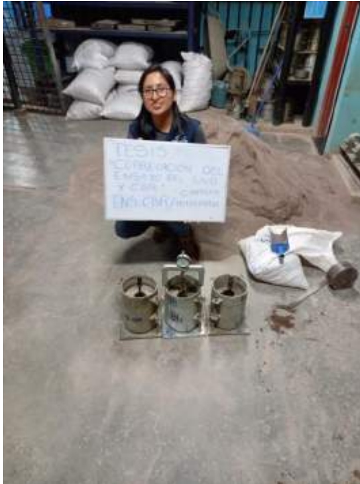
Figura 29. Moldes de CBR listos para ser sometidos a la prensa
