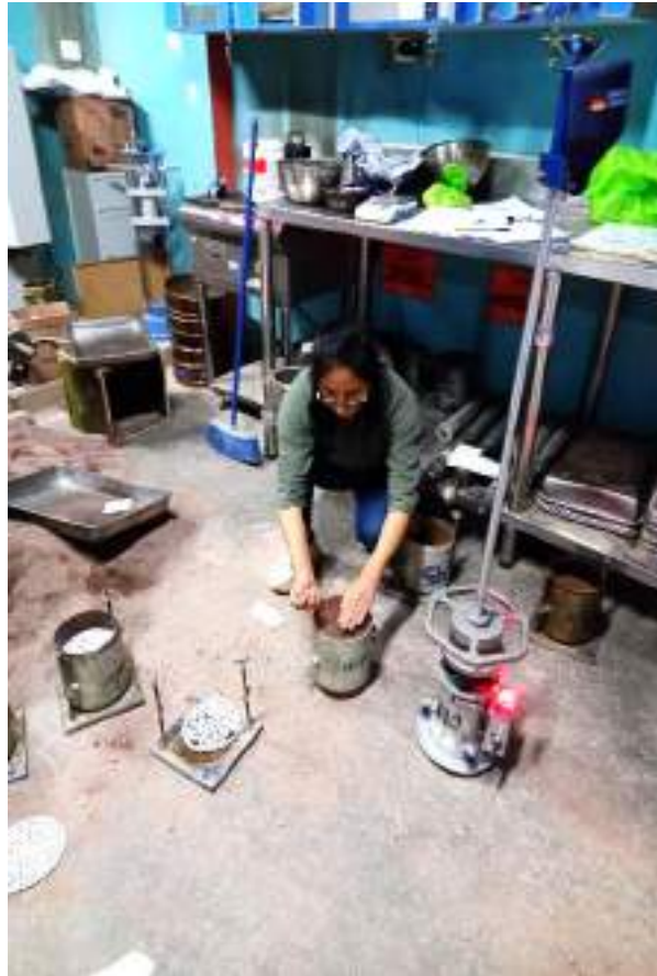
Figura 27. Vista de colocación de arena fina en los moldes de CBR
