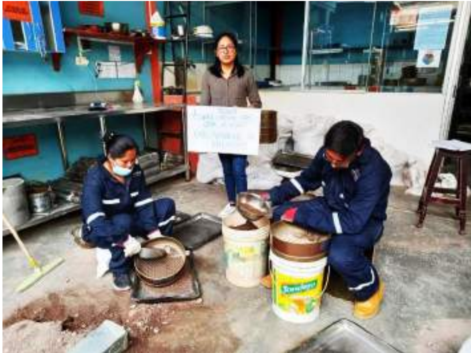
Figura 21. Vista de la preparación del material para ensayos a partir de los resultados de la granulometría de cada cantera
