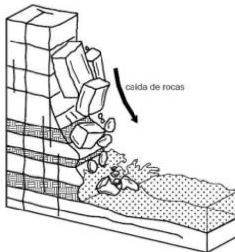
Figura 8. Desprendimiento de masas y rocas en taludes. Tomado de INGEMMET, 2021, p. 28.
