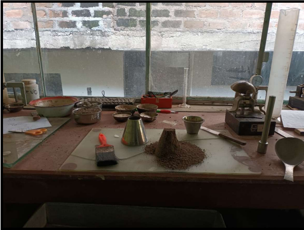
Fotografía 09. Ensayo de peso específico de agregado fino.
