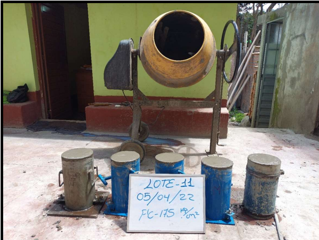
Fotografía 30. Elaboración del Lote 11 de testigos de concreto.
