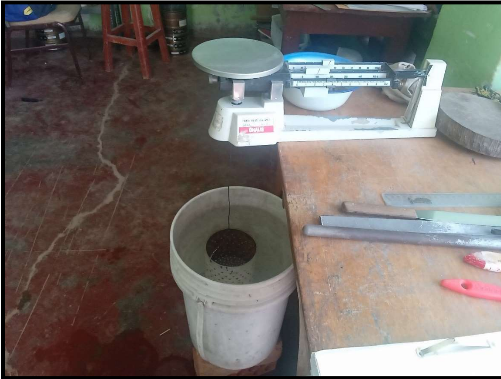
Fotografía 11. Ensayo de peso específico del agregado grueso.
