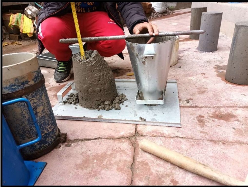
Fotografía 15. Asentamiento de 3 a 4 pulgadas según diseño de mezcla.
