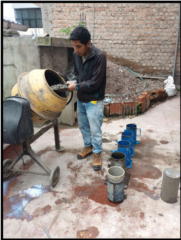
Fotografía 17. Colocación de la mezcla de concreto en moldes.
