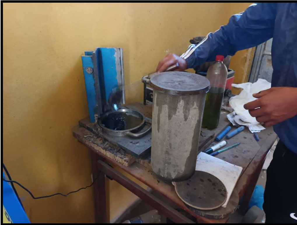
Fotografía 41. Preparación de testigos previos empleo de maquina a compresión.
