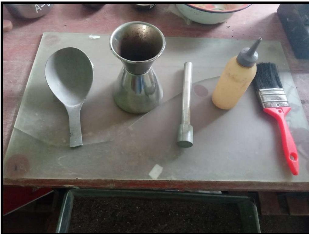
Fotografía 08. Instrumentos empleados para ensayo de peso específico de agregado fino.
