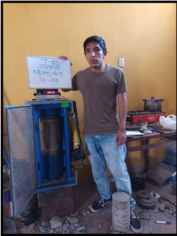
Fotografía 43. Ensayo de rotura de testigos de concreto a compresión
