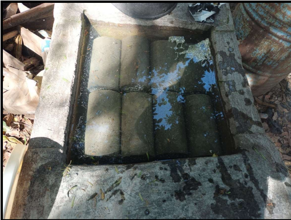
Fotografía 38. Curado tradicional por inmersión de testigos cilíndricos
