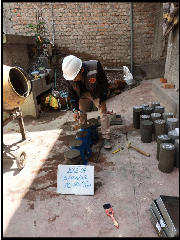
Fotografía 19. Acabado de la superficie de los testigos.
