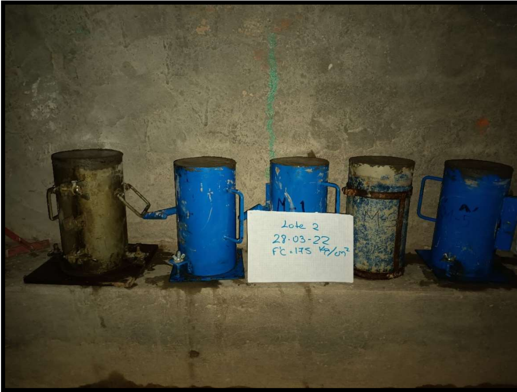
Fotografía 21. Elaboración del Lote 2 de testigos de concreto.
