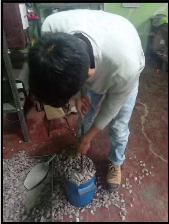
Fotografía 05. Ensayo de peso unitario varillado o compactado seco del agregado grueso.
