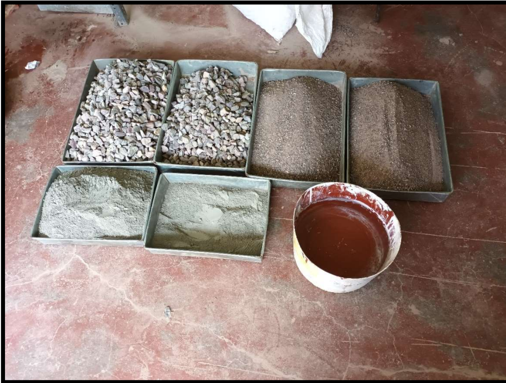
Fotografía 13. Dosificación por peso de materiales para la elaboración de concreto f'c 175 kg/cm 2 .
