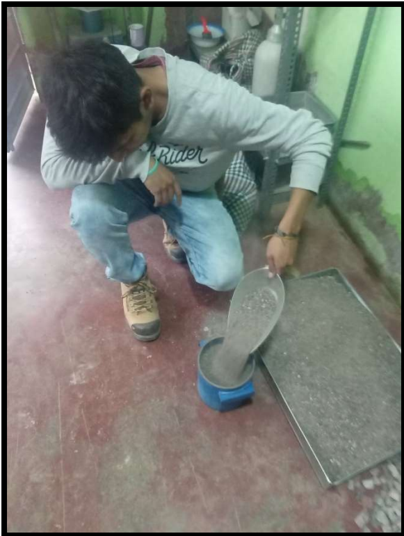
Fotografía 06. Ensayo de peso unitario suelto seco del agregado fino.
