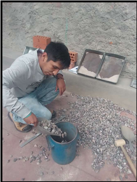
Fotografía 04. Ensayo de peso unitario suelto seco del agregado grueso.
