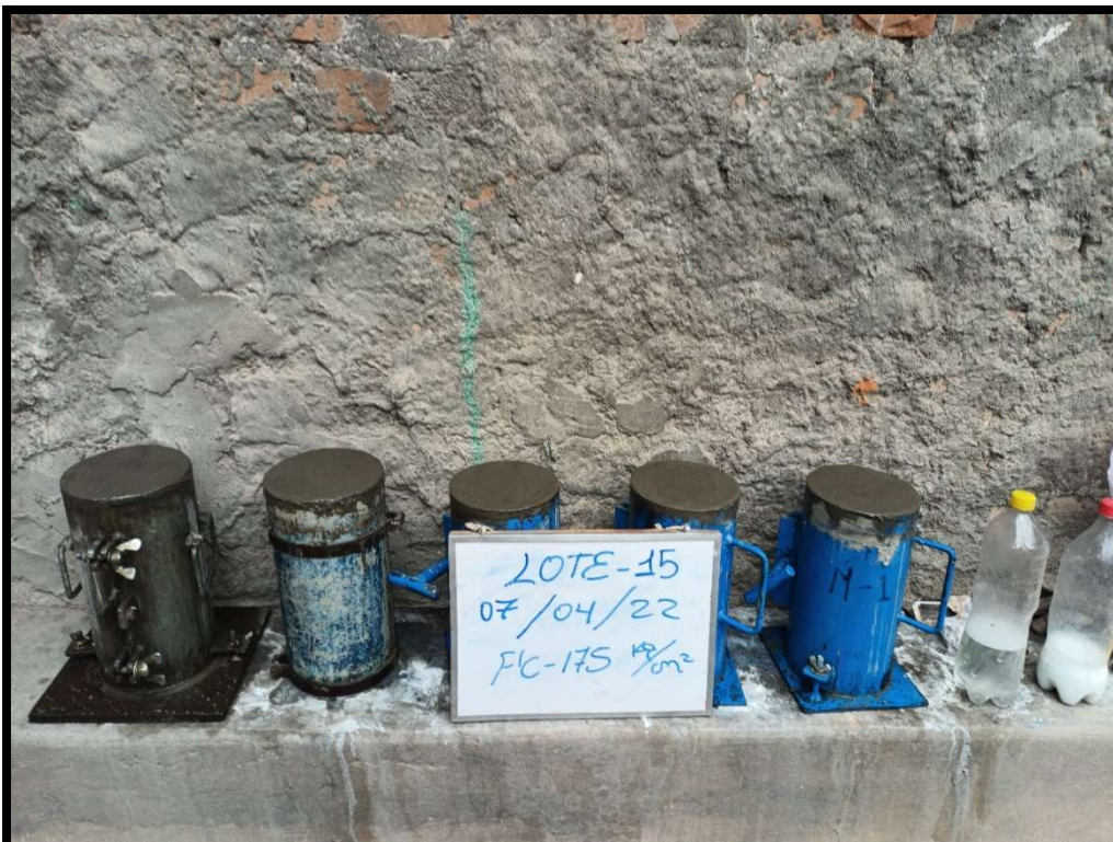
Fotografía 34. Elaboración del Lote 15 de testigos de concreto.
