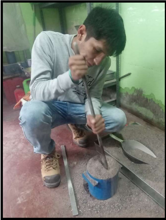
Fotografía 07. Ensayo de peso unitario varillado o compactado seco del agregado fino.
