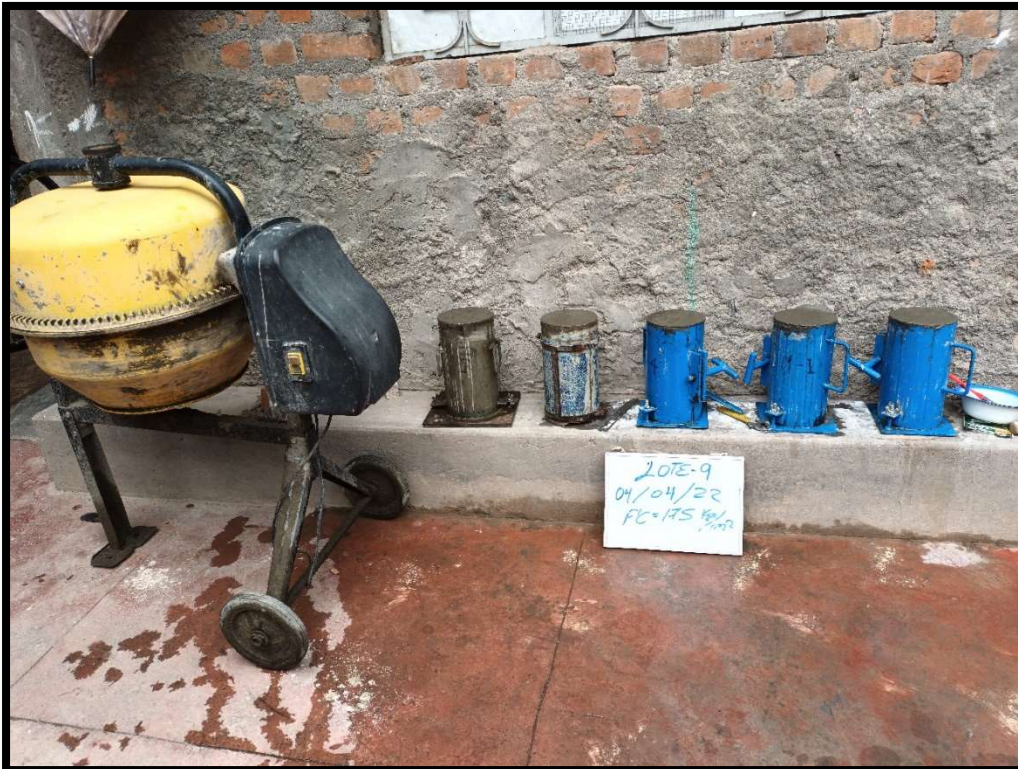
Fotografía 28. Elaboración del Lote 9 de testigos de concreto.
