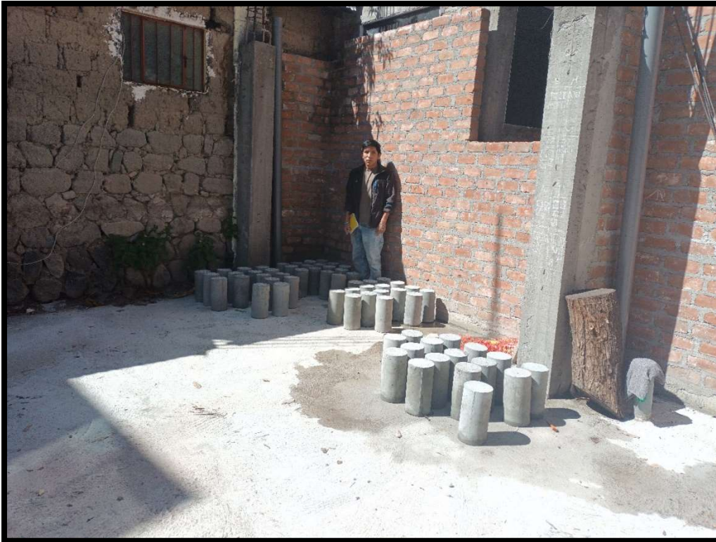
Fotografía 37. Colocación por grupos para su respectivo curado por los diferentes métodos.
