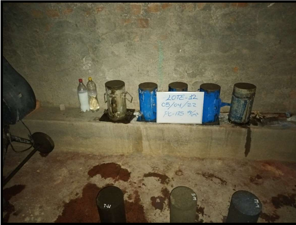
Fotografía 31. Elaboración del Lote 12 de testigos de concreto.
