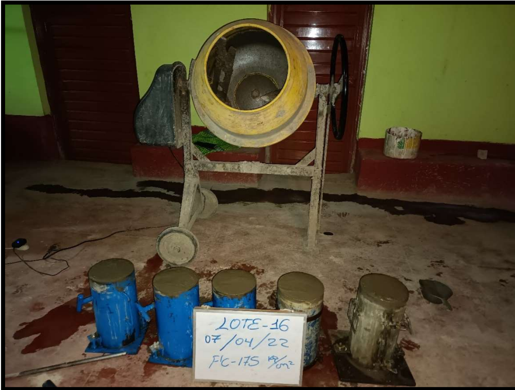
Fotografía 35. Elaboración del Lote 16 de testigos de concreto.
