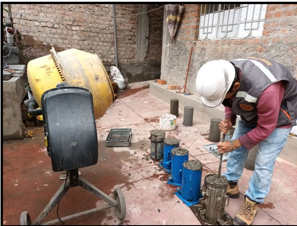
Fotografía 18. Proceso de compactación con varilla por capas en testigos de concreto.
