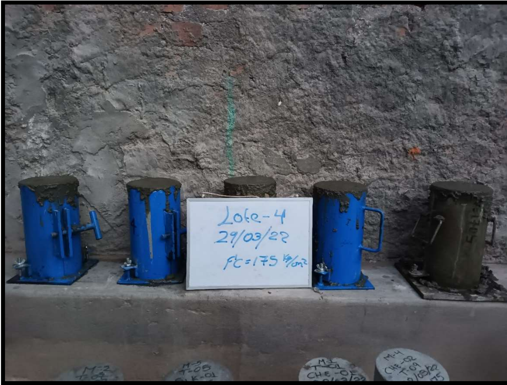
Fotografía 23. Elaboración del Lote 4 de testigos de concreto.
