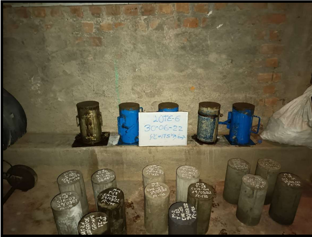
Fotografía 25. Elaboración del Lote 6 de testigos de concreto.
