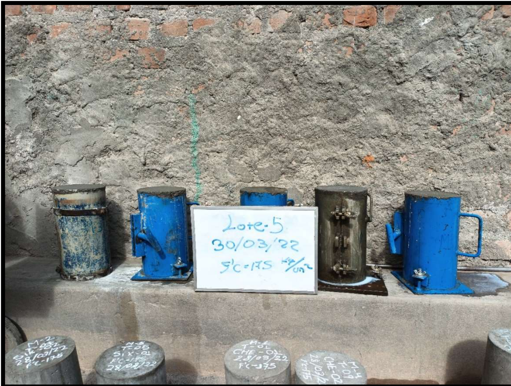
Fotografía 24. Elaboración del Lote 5 de testigos de concreto.
