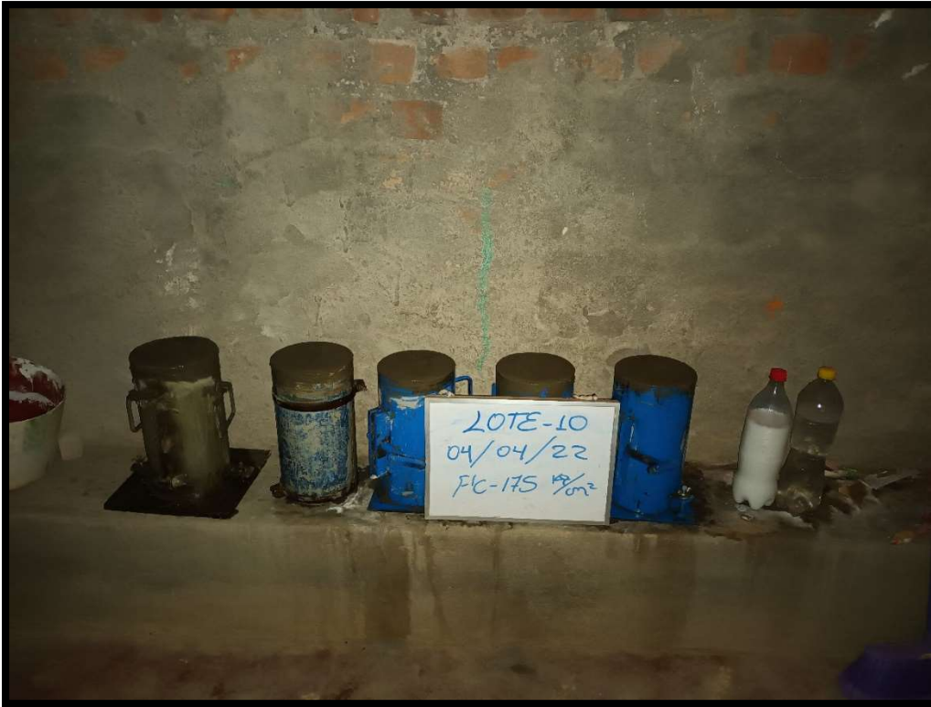
Fotografía 29. Elaboración del Lote 10 de testigos de concreto.
