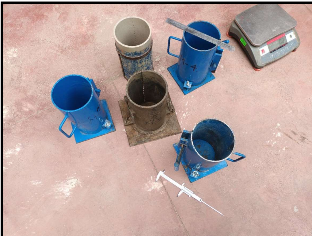
Fotografía 16. Instrumentos empleados para la elaboración de testigos de concreto.
