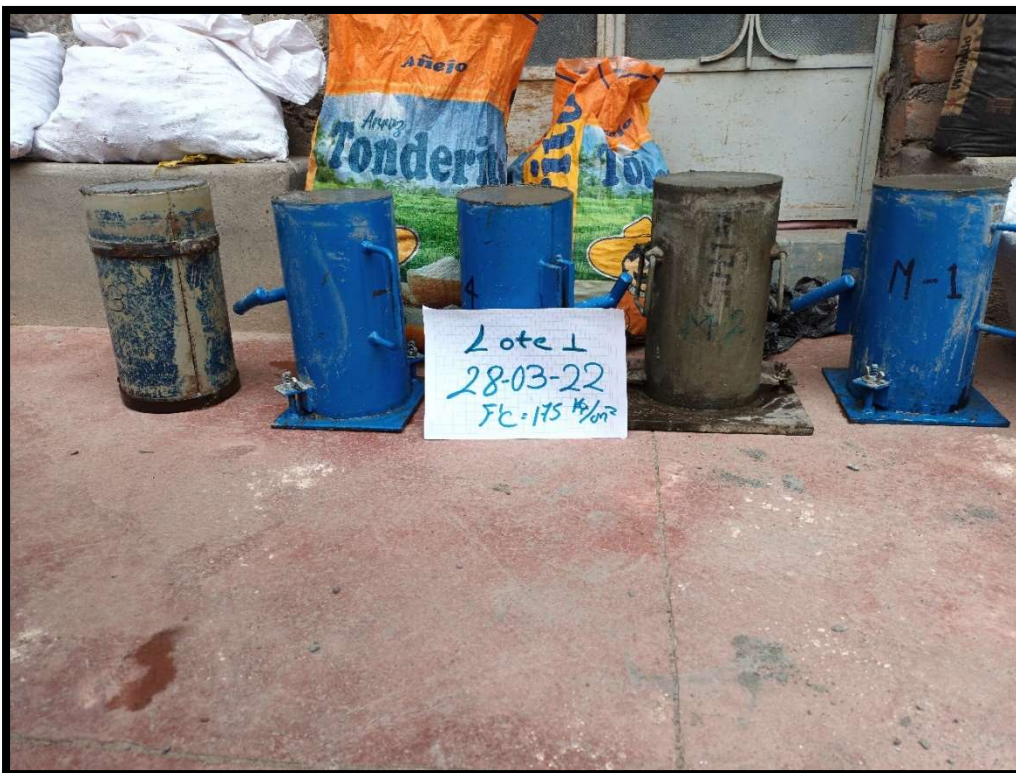
Fotografía 20. Elaboración del Lote 1 de testigos de concreto.
