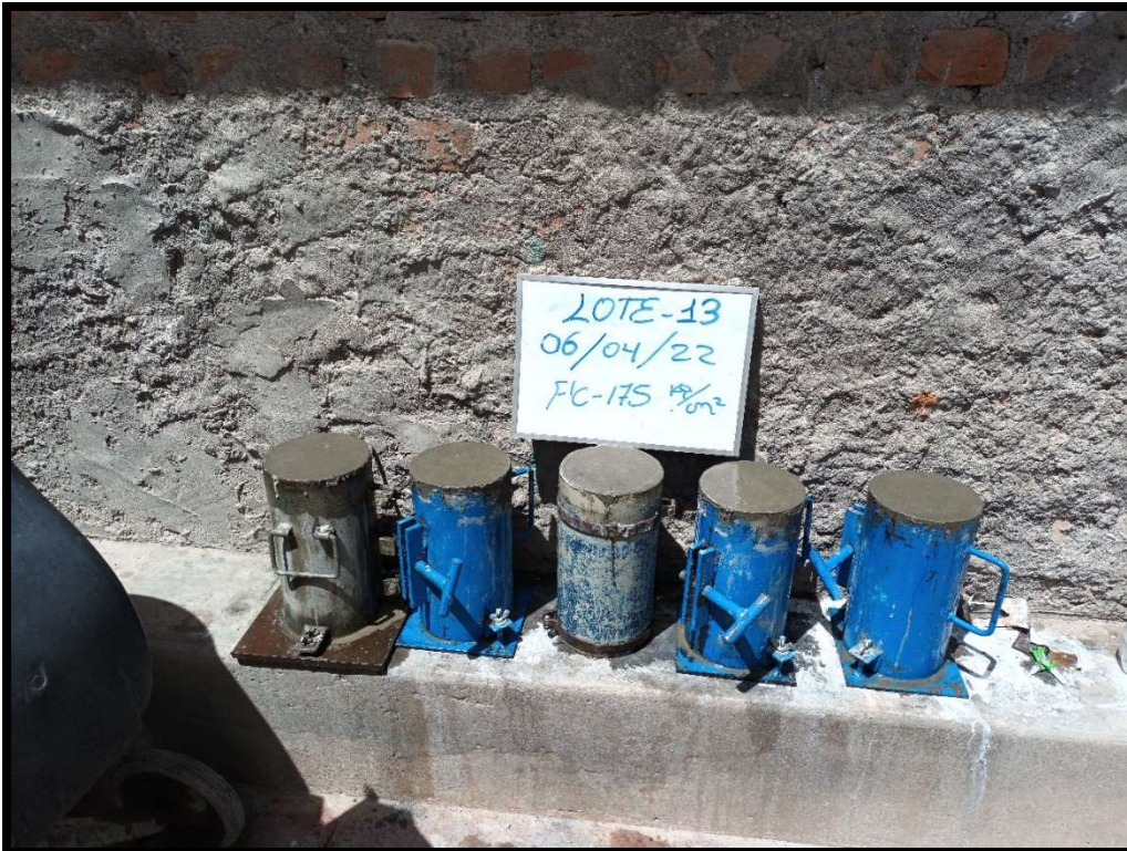
Fotografía 32. Elaboración del Lote 13 de testigos de concreto.
