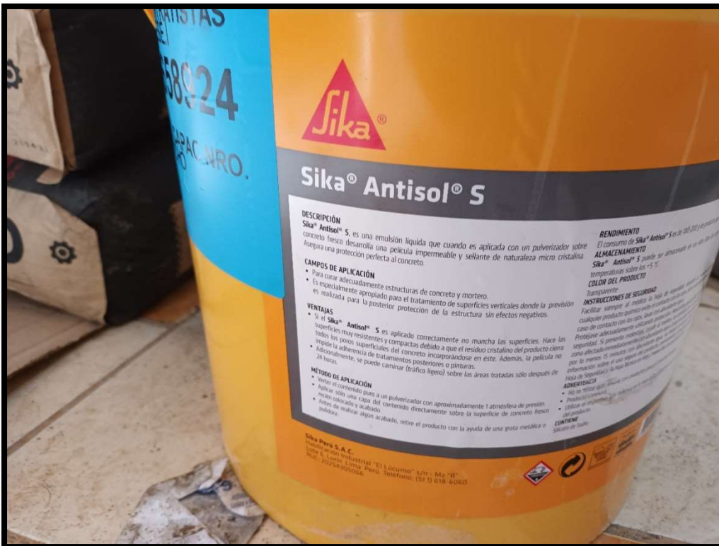
Fotografía 40. Empleo de aditivo Sika Antisol S para curado de concreto.
