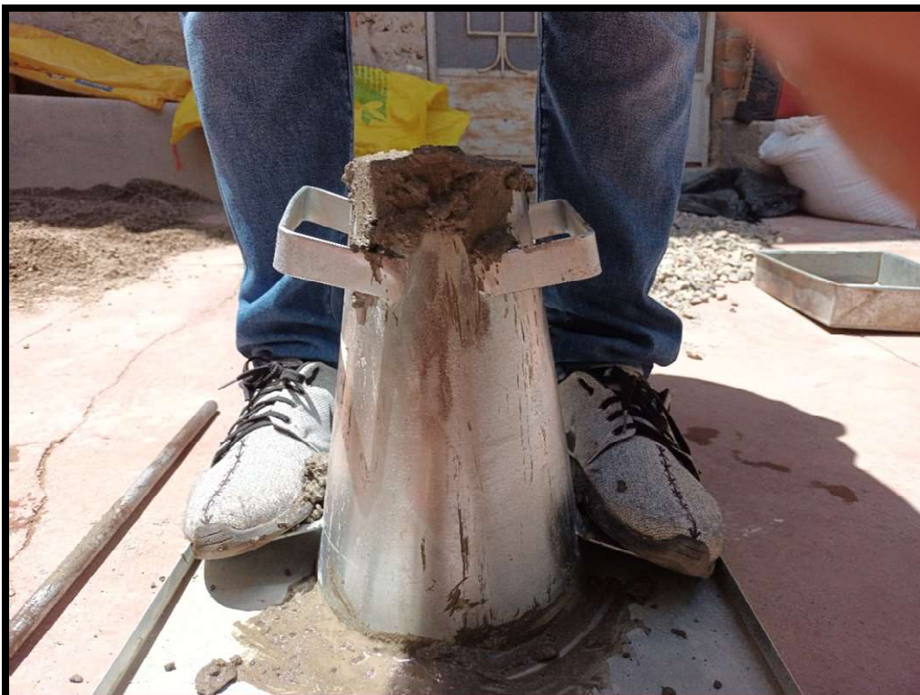
Fotografía 14. Elaboración del ensayo de asentamiento.
