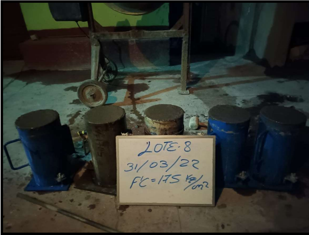
Fotografía 27. Elaboración del Lote 8 de testigos de concreto.
