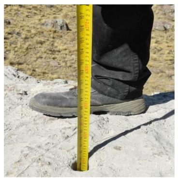
Figura 33: Verificación de la profundidad de la perforación
