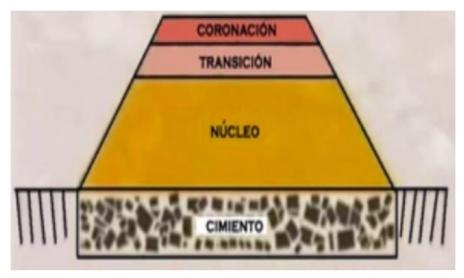
Figura 11: Estructura de un pedraplén
