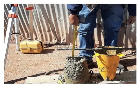
Figura 83: Vista de las pruebas de asentamiento del concreto para veredas
