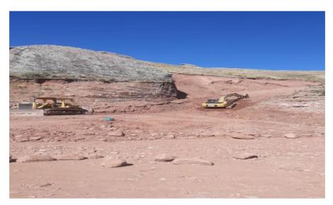
Figura 45: Extracción y acumulación de material ligante de la cantera Salcedo
