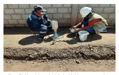
Figura 79: Vista de la prueba de la densidad de campo en veredas
