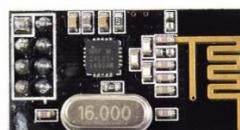
**Figura 26. Módulo transceptor nRF24L01**
