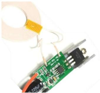
**Figura 22. Generador de pulsos y bobina emisora**
