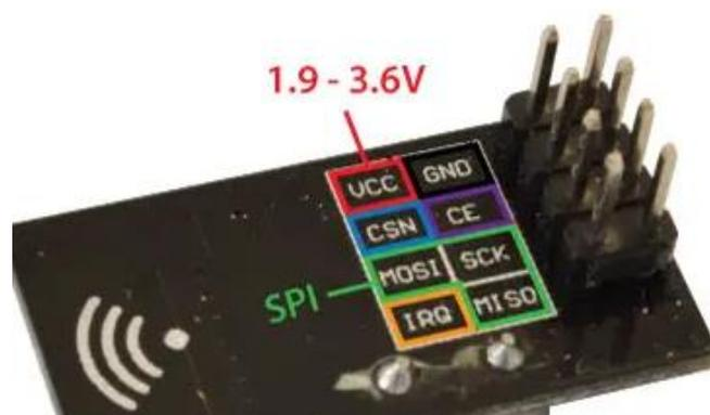
**Figura 27. Pines del módulo transceptor nRF24L01**
