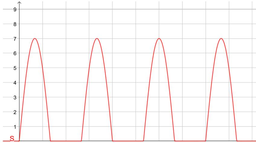
**Figura 34. Señal de voltaje rectificadora obtenida después del diodo Schottky**
