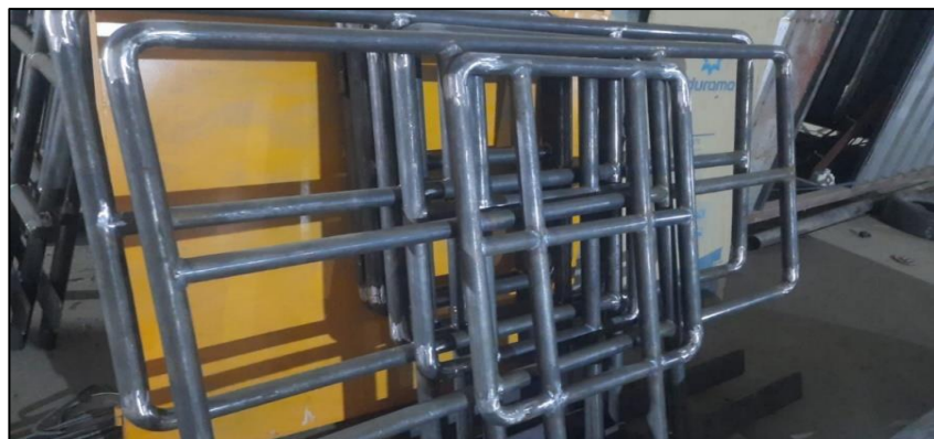
Figura 30. Acabado de las barandas
