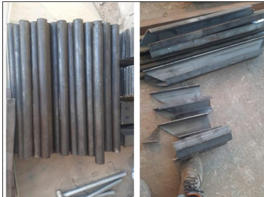
Figura 25. Tubos y perfiles cortados
