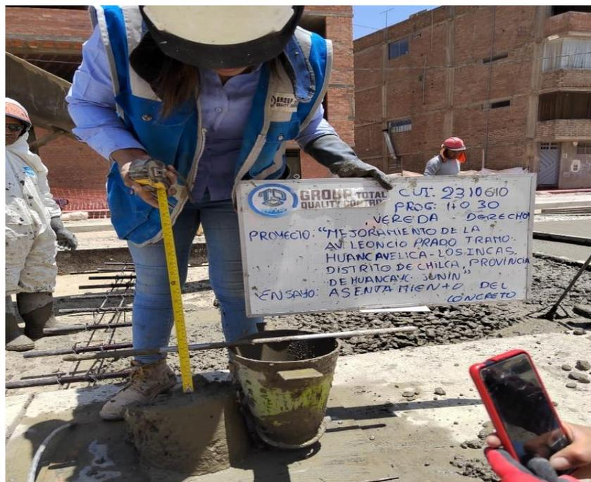
Figura 126. Ensayo de cono de Abrams - slump
