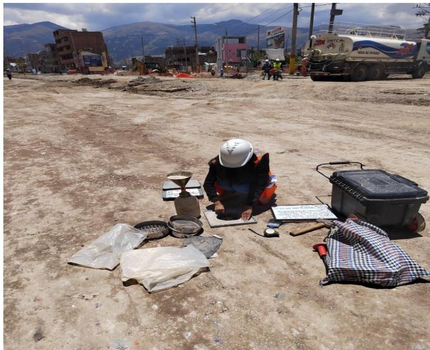
Figura 120. Ensayo de densidad de campo
