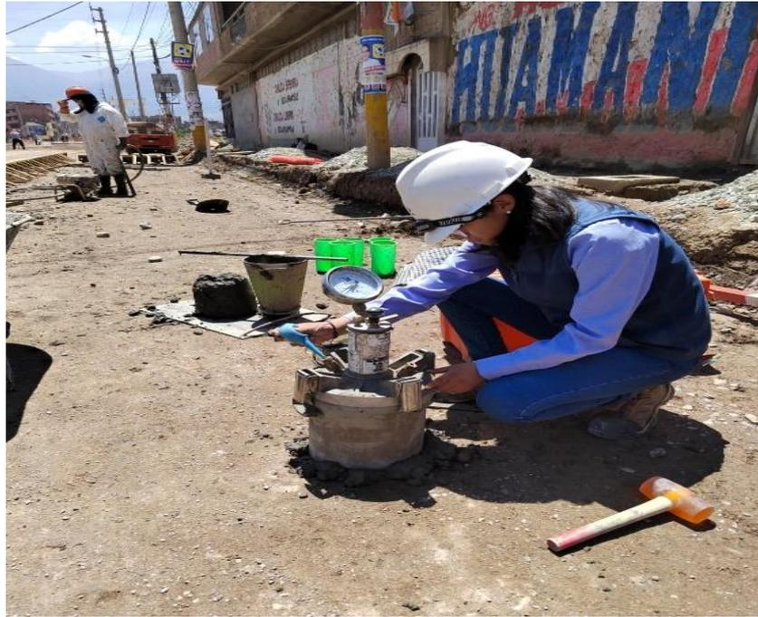
Figura 121. Ensayo de contenido de aire
