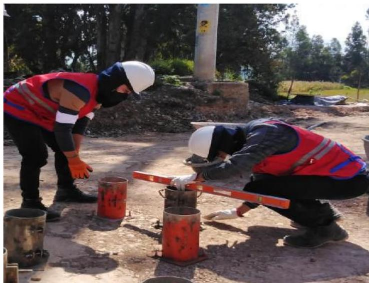
Figura 94. Ensayo cono de Abrams in-situ.
