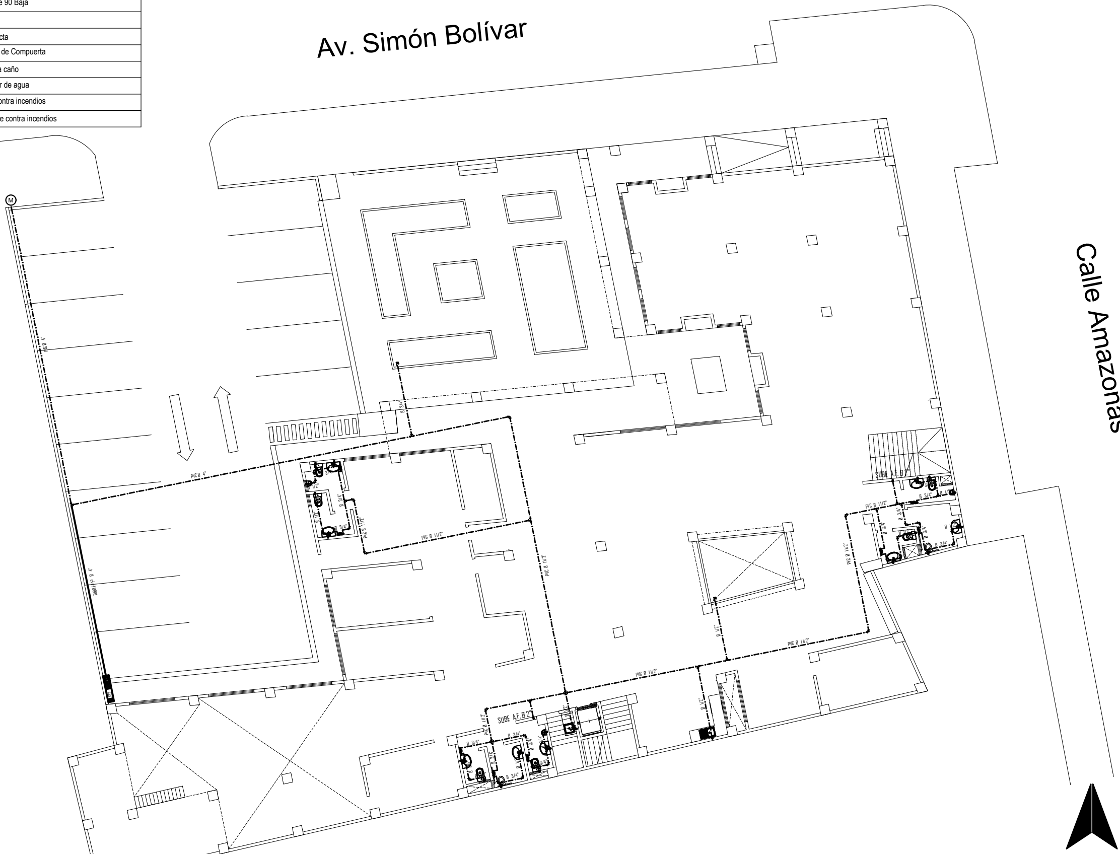
1 Instalación Hidráulica Primera Planta ESC: 1/200
