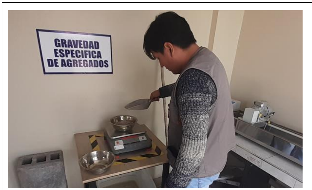
Anexos 2. Según las especificaciones de la norma MTC E 204, se obtuvieron 1.5 kg de muestra de arena zarandeada y 1.5 kg de arena chancada, las cuales fueron seleccionadas de un cuarteo realizado según lo indica la norma MTC E 201.
