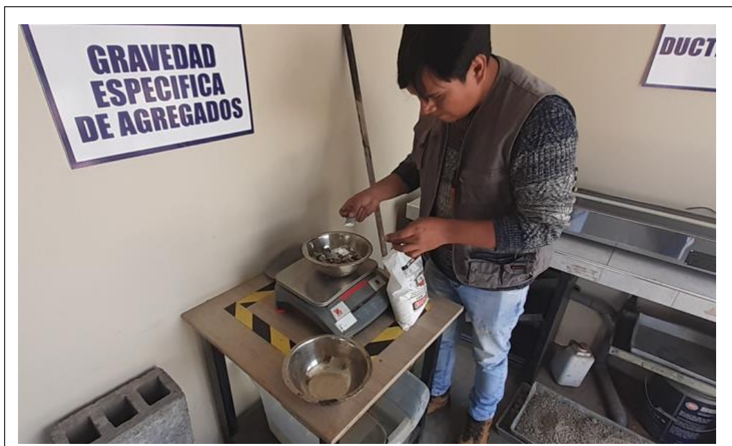
Anexos 10. Se adiciona la cal hidratada como filler para la combinación de los agregados.
