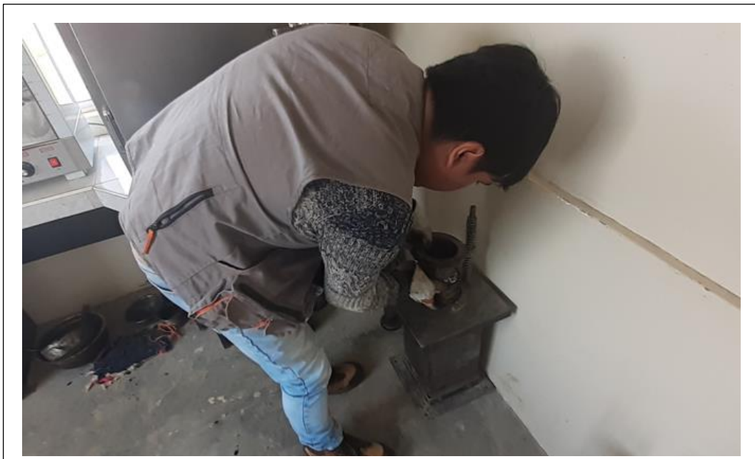
Anexos 14. Según lo especificado en el ensayo MTC E 504, se emplearon moldes, collarines y placas base para moldear las briquetas; también es necesario el empleo de papel filtro en la base y parte superior de la briqueta.
