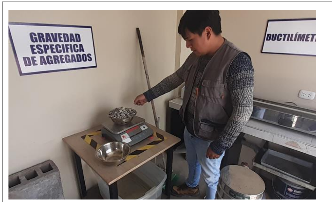
Anexos 5. Según las especificaciones de la norma MTC E 204, se obtuvieron 3.0 kg de piedra chancada de \frac{1}{2} " , las cuales fueron seleccionadas de un cuarteo realizado según lo indica la norma MTC E 201.
