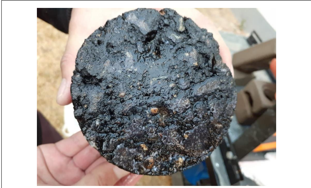
Anexos 43. Briquetas resultantes tras realizar el ensayo por una hora y haber sido sometida a pulverizado de agua a 1.5 kPa de presión, demostrando que a 5 cm de distancia hay desprendimiento de material.
