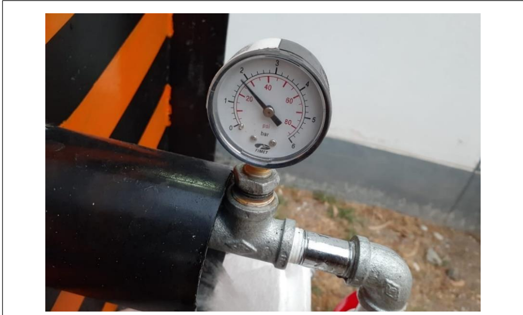
Anexos 39. Se someterán 12 briquetas a una presión de agua pulverizada de 2.0 kPa, a 5 cm, 10 cm, 15 cm y 18 cm de distancia entre la salida del agua y la cara de la briqueta.
