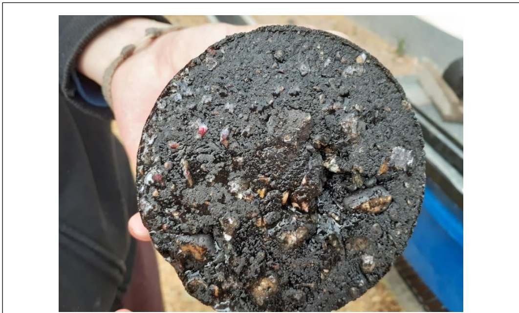
Anexos 44. Briquetas resultantes tras realizar el ensayo por una hora y haber sido sometida a pulverizado de agua a 2.0 kPa de presión, demostrando que a 5 cm de distancia hay desprendimiento de material.
