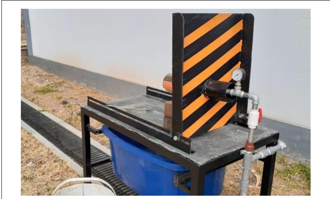
Anexos 35. Máquina de pulverizado de agua a presión por chorro para el ensayo en las briquetas elaboradas.
