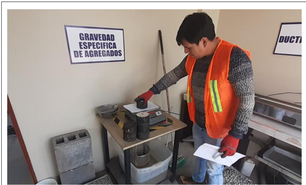
Anexos 20. Las briquetas resultantes al variar los porcentajes de cemento asfáltico de 4% al 6.5% fueron pesadas para registrar sus pesos secos.
