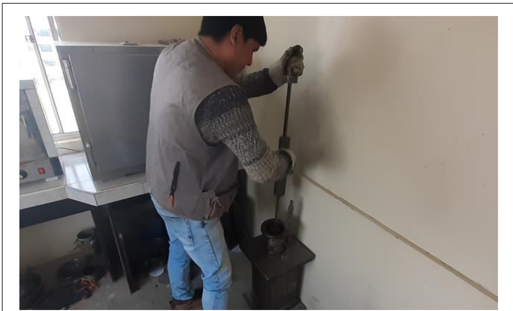
Anexos 16. Tras colocar la mezcla obtenida, se realiza la compactación de ambas caras de la briqueta a 75 golpes empleando un pisón de compactación que cumpla con las especificaciones de la norma MTC E 504.
