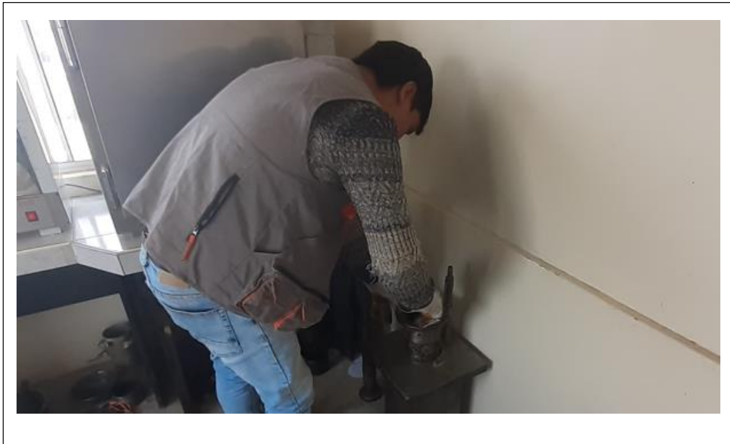
Anexos 15. Se procede a colocar la mezcla asfáltica en los moldes precalentados, habiendo colocado antes un papel filtro en la base del molde.
