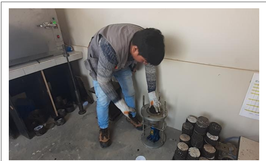
Anexos 18. Después de dejar a temperatura ambiente las briquetas obtenidas, se pasa a desmoldarlas con cuidado de no perder material y etiquetándolas correctamente según el porcentaje de cemento asfáltico empleado.
