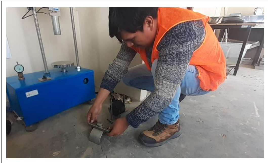
Anexos 25. Las briquetas acondicionadas son colocadas en la mordaza que se colocará en la prensa de Marshall para las lecturas de los diales.
