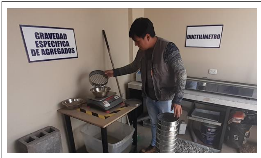
Anexos 4. Se tomará el peso retenido en cada malla empleando una balanza de 0.5 gr para más precisión en la toma de resultados.
