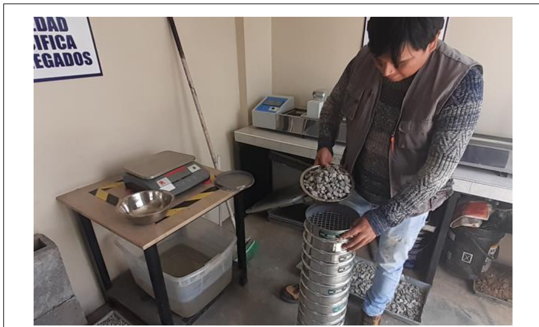
Anexos 6. Tras tener las muestras representativas del agregado grueso, se procede a realizar el ensayo de granulometría; para ello, es necesario emplear las mallas de 1", 3/4", 1/2", 3/8", N°4, N°8, N°10, N° 16, N°30, N°40, N°50, N°80, N°100, N°200, tapa y fondo.
