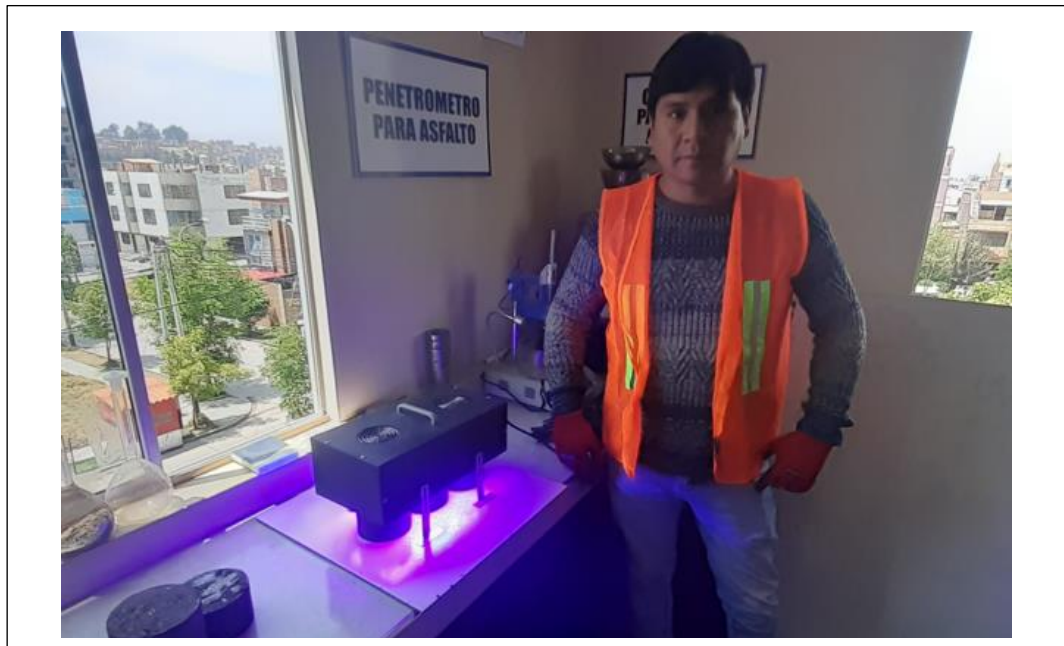
Anexos 29. Tras colocar las briquetas en un horno especial para el proceso de envejecimiento, se expuso cada muestra a radiación ultravioleta por un tiempo de 45 horas.
