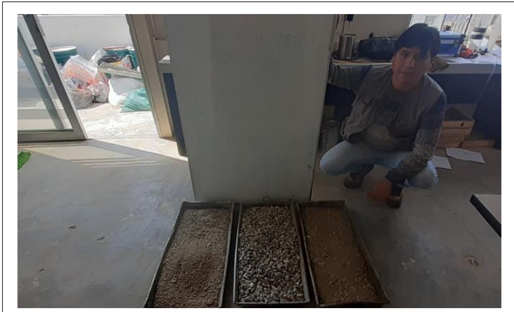
Anexos 1. Se extrajeron agregados gruesos y finos de la cantera de Matahuasi, los cuales deberán cumplir con las especificaciones de la norma MTC E 201.
