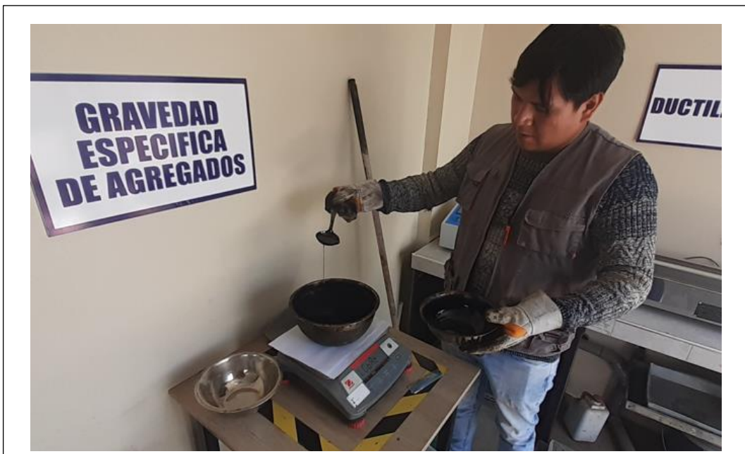
Anexos 12. Tras preparar la mezcla de agregados, se añadió el cemento asfáltico caliente variando su porcentaje de un 4% a 6%, logrando cumplir el peso de la mezcla asfáltica de 1250 gramos.
