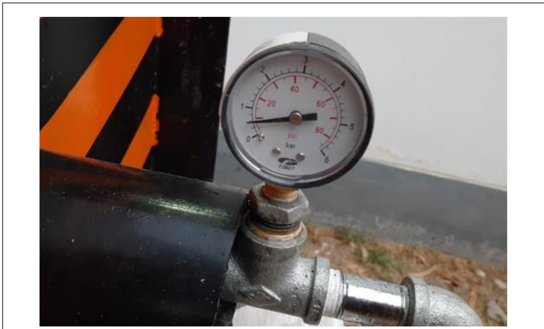
Anexos 36. Se someterán 12 briquetas a una presión de agua pulverizada de 0.5 kPa, a 5 cm, 10 cm, 15 cm y 18 cm de distancia entre la salida del agua y la cara de la briqueta.
