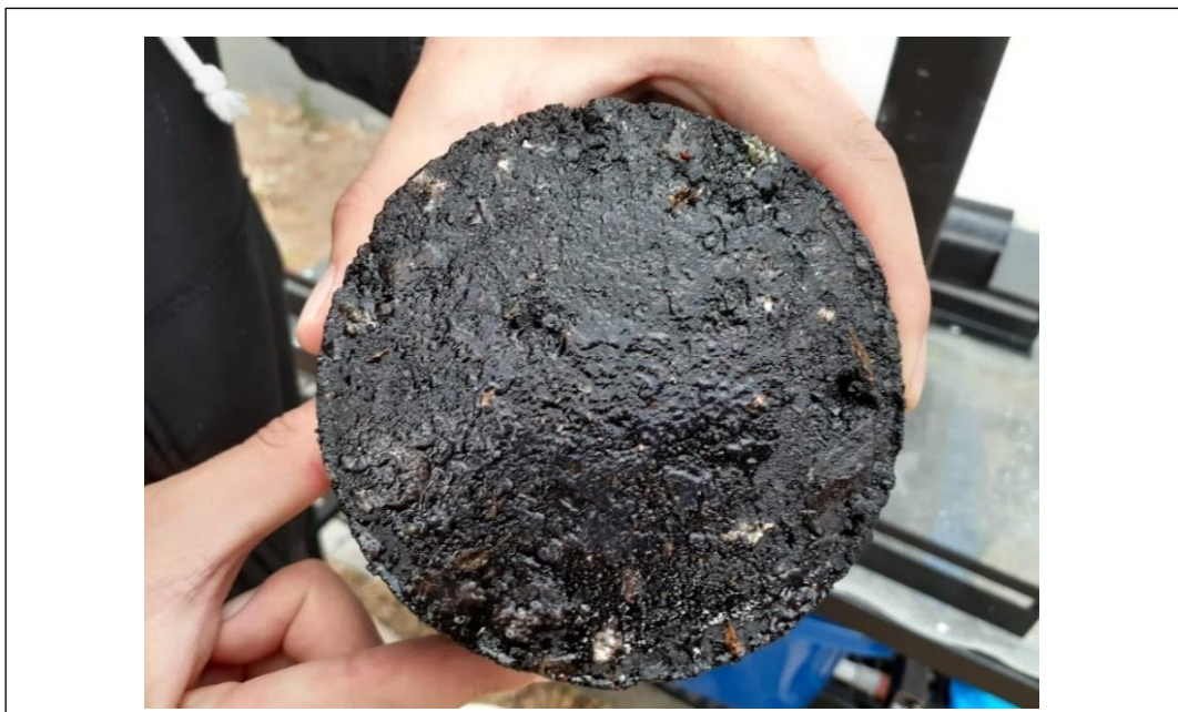
Anexos 42. Briquetas resultantes tras realizar el ensayo por una hora y haber sido sometida a pulverizado de agua a 1.0 kPa de presión, demostrando que a 5 cm de distancia hay desprendimiento de material.
