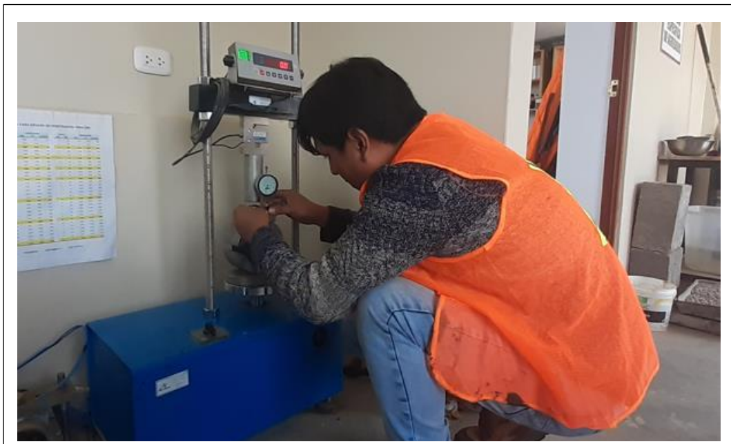
Anexos 26. Se empleó el aparato de Marshall para aplicar una carga a cada briqueta y así registrar las lecturas de los diales, también se optó por grabar todo el ensayo para tener el registro preciso de la data obtenida. El ensayo se realizará para tres briquetas por cada porcentaje de ligante asfáltico empleado.
