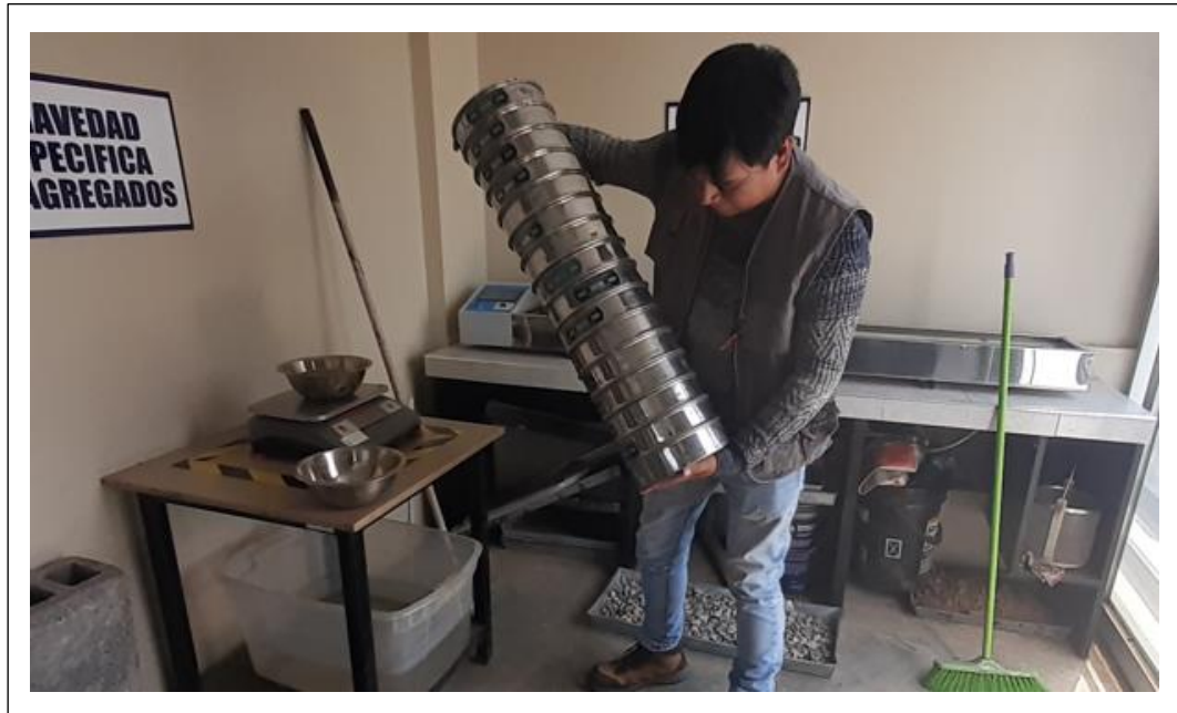
Anexos 3. Tras tener las muestras representativas del agregado, se procede a realizar el ensayo de granulometría, para ello es necesario emplear las mallas de 1", 3/4", 1/2", 3/8", N°4, N°8, N°10, N° 16, N°30, N°40, N°50, N°80, N°100, N°200, tapa y fondo.
