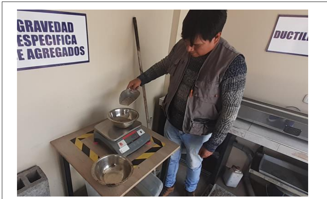
Anexos 9. Tras realizar la combinación teórica de agregados por MAC2, se tomaron los pesos retenidos en cada malla especificada para obtener la mezcla de agregados.
