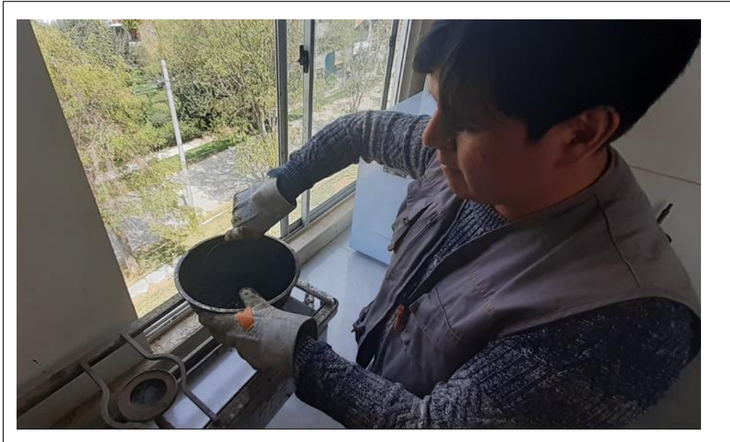
Anexos 13. Manteniendo la mezcla de agregados a una temperatura elevada empleando una hornilla, se realiza la mezcla asfáltica, verificando la temperatura con un termómetro de laboratorio.
