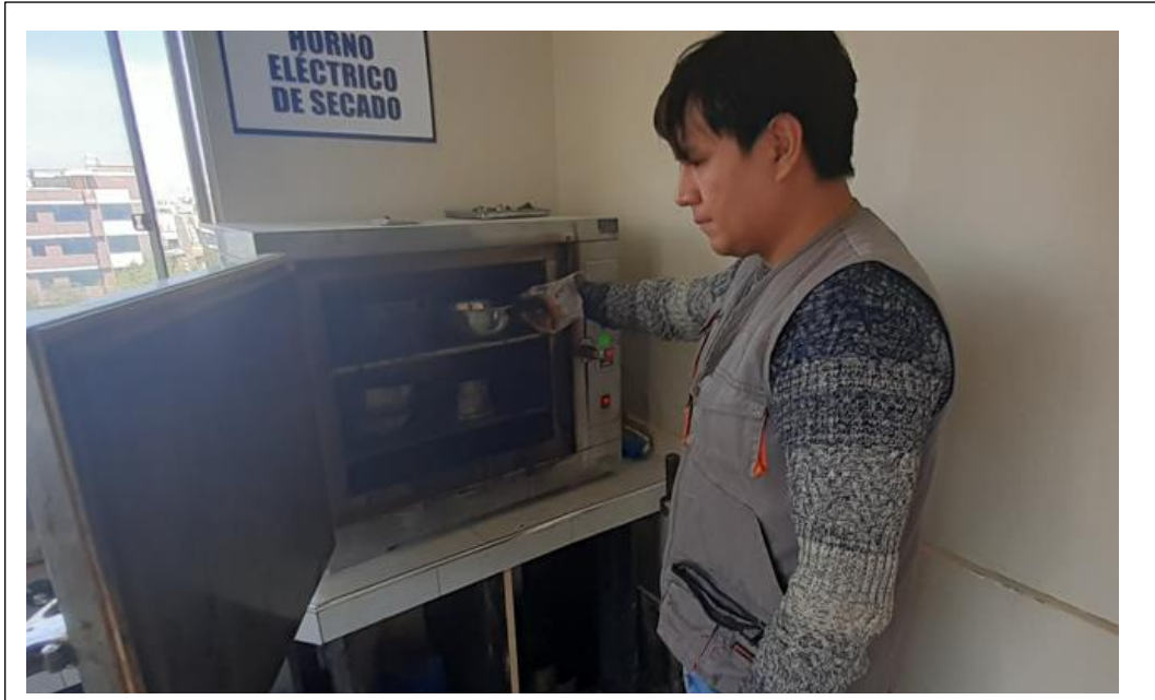
Anexos 11. Para una mezcla entre los agregados y el cemento asfáltico, se mantuvieron calientes estos materiales a una temperatura inferior a la temperatura de mezcla según lo especificado en el ensayo MTC E 504.
