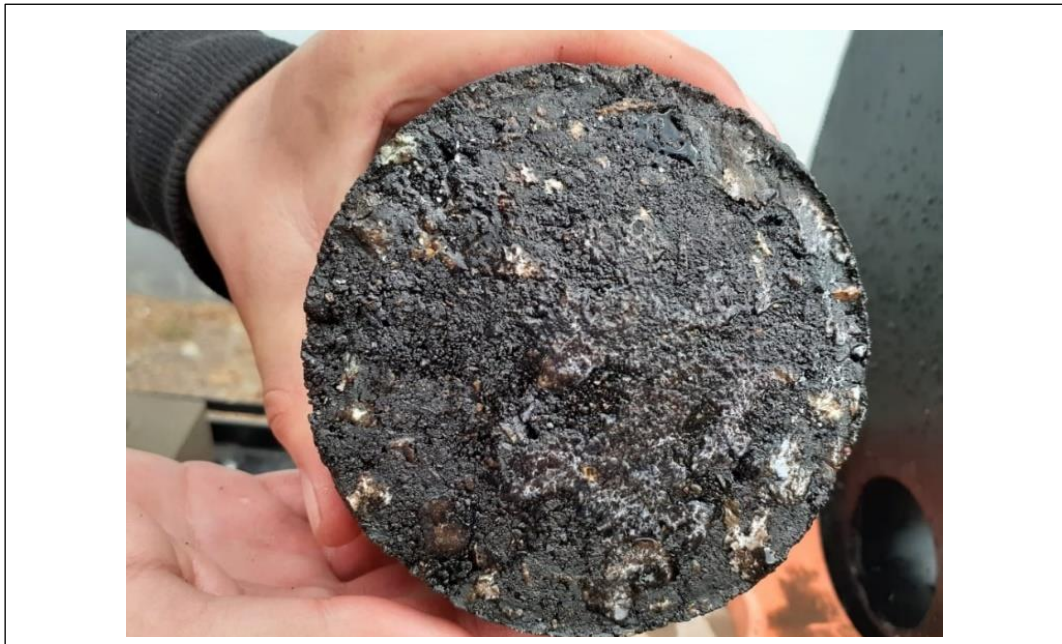
Anexos 41. Briquetas resultantes tras realizar el ensayo por una hora y haber sido sometida a pulverizado de agua a 0.5 kPa de presión, demostrando que a 5 cm de distancia hay desprendimiento de material.
