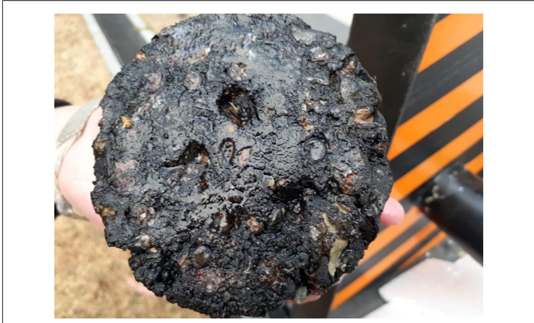
Anexos 45. Briquetas resultantes tras realizar el ensayo por una hora y haber sido sometida a pulverizado de agua a 2.15 kPa de presión, demostrando que a 5 cm de distancia hay desprendimiento de material.
