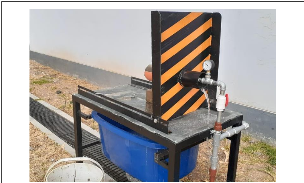
Anexos 40. Se someterán 12 briquetas a una presión de agua pulverizada de 2.15 kPa, a 5 cm, 10 cm, 15 cm y 18 cm de distancia entre la salida del agua y la cara de la briqueta.
