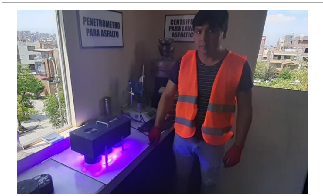
Anexos 30. Tras colocar las briquetas en un horno especial para el proceso de envejecimiento, se expuso cada muestra a radiación ultravioleta por un tiempo de 90 horas.
