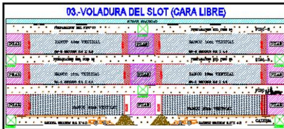
Figura 7. Voladura del Slot (cara libre), unidad minera San Cristóbal Tomada del departamento de Geología y Planeamiento de la unidad minera San Cristóbal (6)
