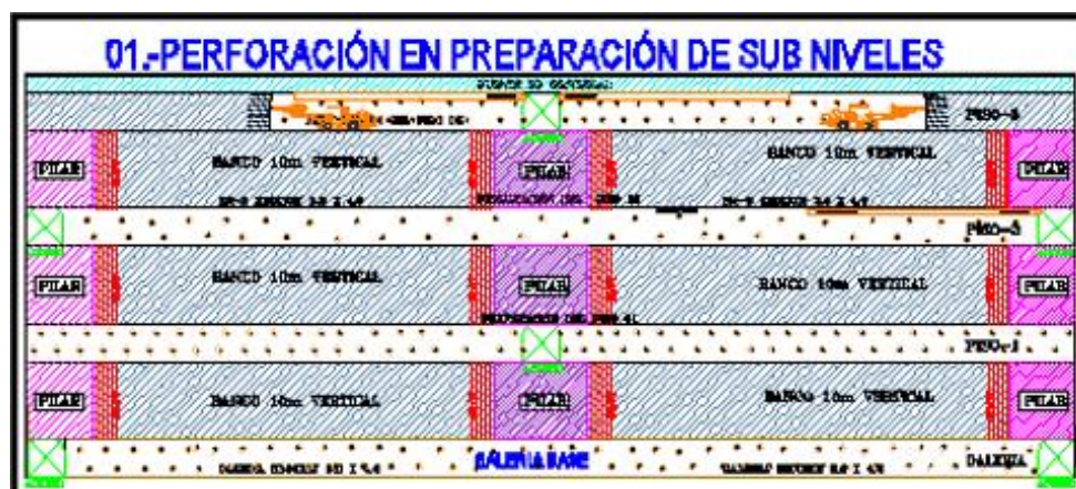
Figura 5. Perforación en preparación de subnivel, unidad Minera San Cristóbal Tomada del departamento de Geología y Planeamiento de la unidad minera San Cristóbal (6)
