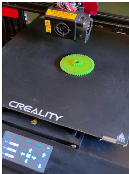
Figura 64. Impresión 3D engranes.
