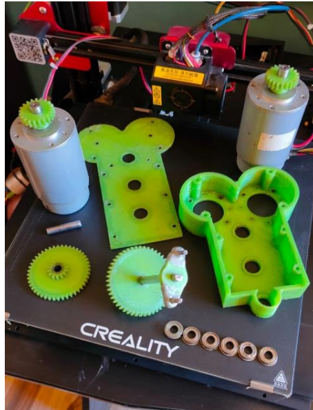
Figura 67. Piezas del multiplicador de velocidad terminadas.
