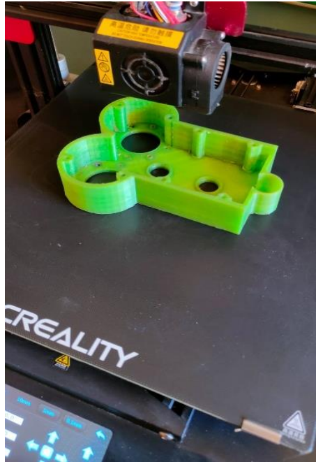
Figura 65. Impresión 3D base del tren de engranes
