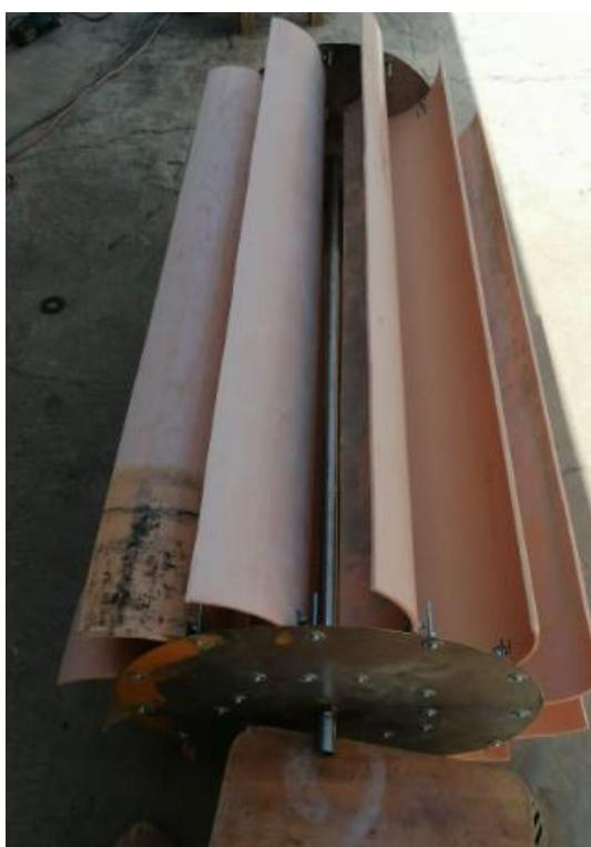
Figura 60. Construcción de la turbina Savonius.
