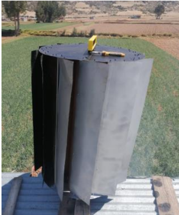
Figura 62. Instalación de la Turbina Savonius modificado.
