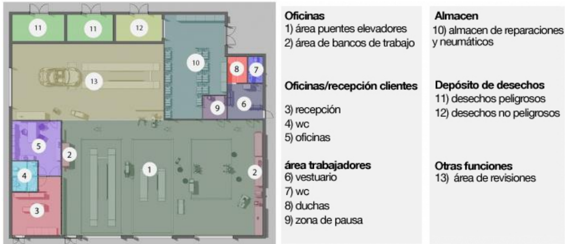
Figura 2.4 Ejemplo de la organización que puede existir en un taller mecánico. Tomado de www.biblus.accasoftware.com
