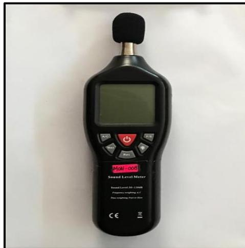
**Figura 2.**Sonómetro Integrador Clase II
