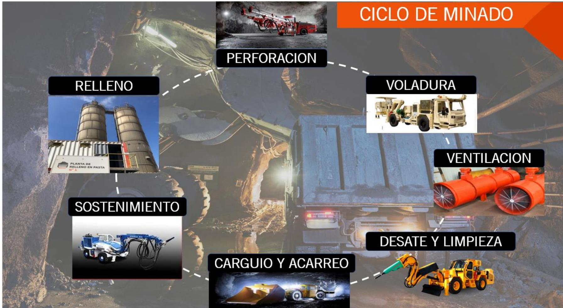
**Figura 8. Ciclo de minado del método de explotación sublevel stoping, en la unidad minera Cerro Lindo Tomada del área de Planeamiento**
