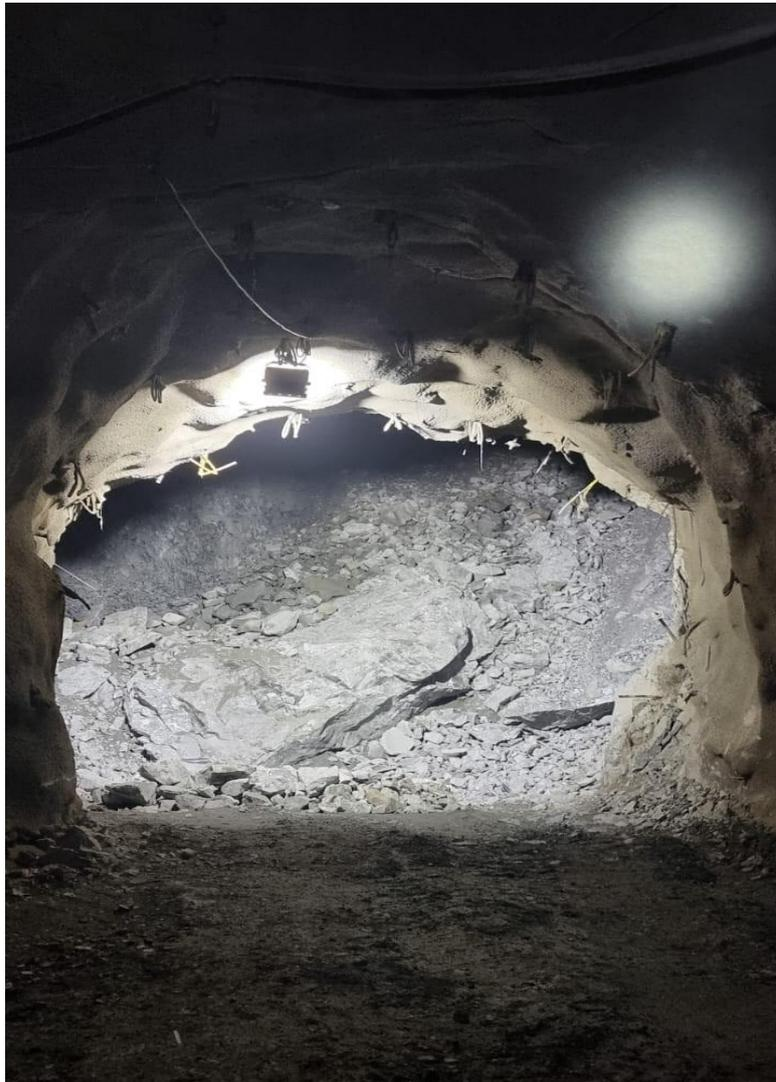
*Figura 7. Drift de extracción, método sublevel stoping, Tj 320, Nv 1850, OB2B*
