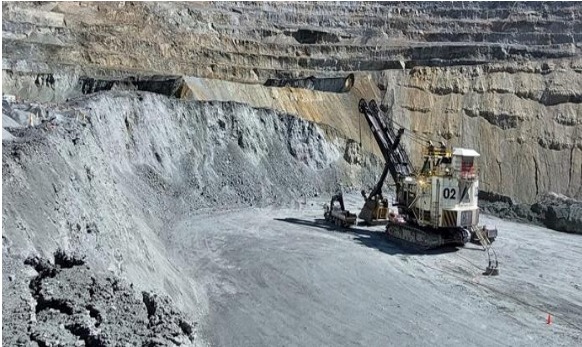
Figura 57. Proceso carguío, pala eléctrica PL02 Tomada del Departamento de Planeamiento
