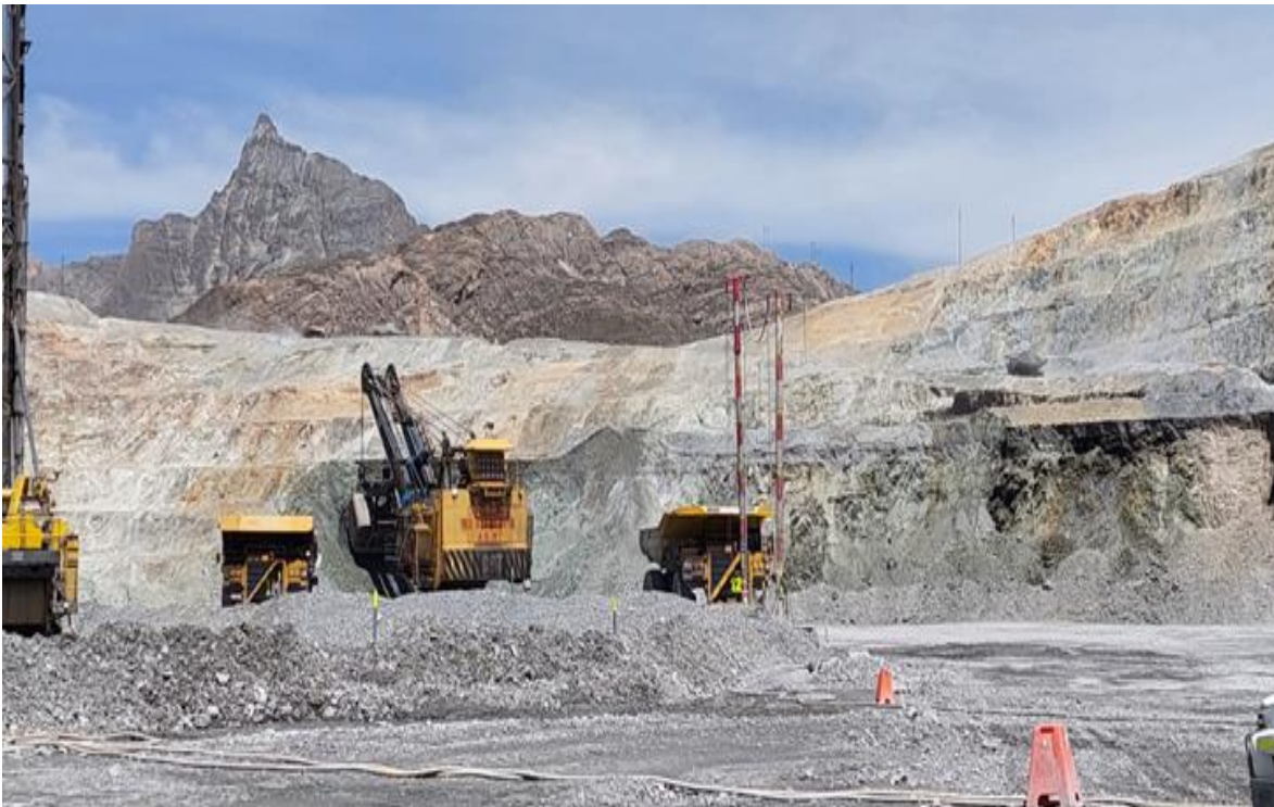
Figura 58. Proceso de carguío, pala eléctrica PL03 y equipos de acarreo. Tomada del Departamento de Planeamiento
