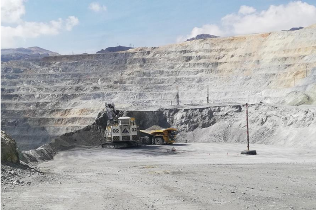
Figura 55. Pala eléctrica 02, polígono 4440, CAT - modelo 7495 HF Tomada del Departamento de Planeamiento
