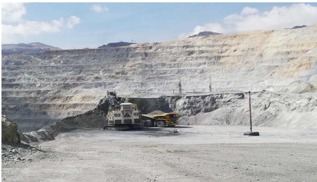
Figura 7. Pala eléctrica 02, polígono 4440, CAT – Modelo 7495 HF Tomada del Área de Planeamiento
