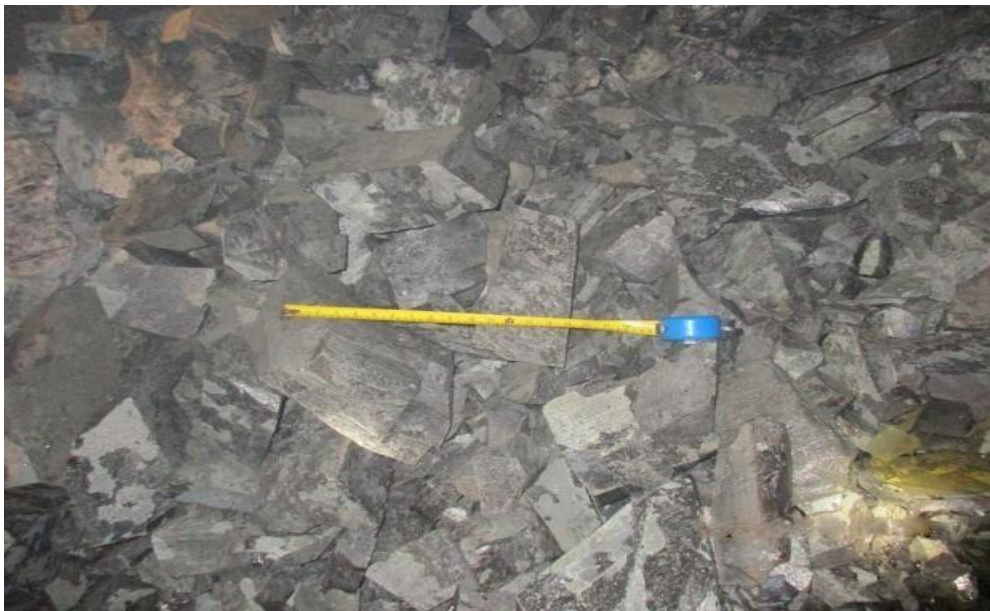
Figura 32. Material post voladura, escenario anterior Tomada del departamento de Planeamiento
