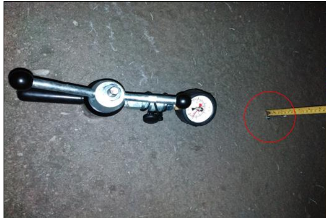
Figura 6. Resistencia temprana del shotcrete vía húmeda
