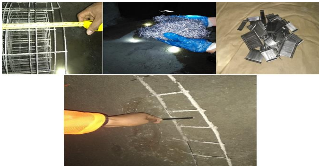
Figura 10. Tipos de refuerzos del shotcrete Tomada de información brindada por la empresa
