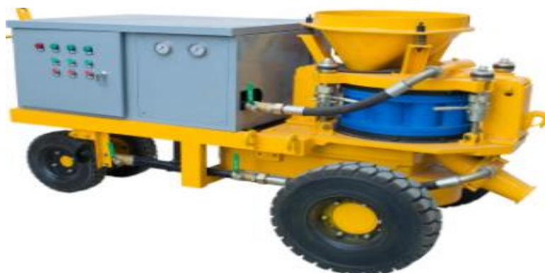
Figura 2. Equipo shotcrete vía húmeda Tomada de Túneles y obras subterráneas - Rey A. et al., Sika S.A.U, Madrid, España, 2010, p 145
