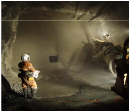
Figura 17. Generación de polvo por vía seca
