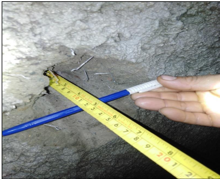
Figura 11. Control de espesor de la capa de shotcrete Tomada de información brindada por la empresa
