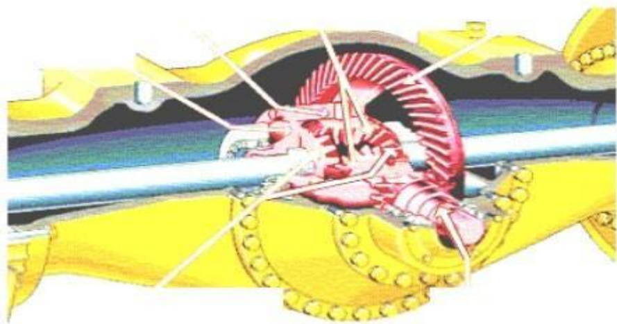
Figura 6. Componentes internos de diferencial Tomada del sistema de transmisión scooptram (14)
