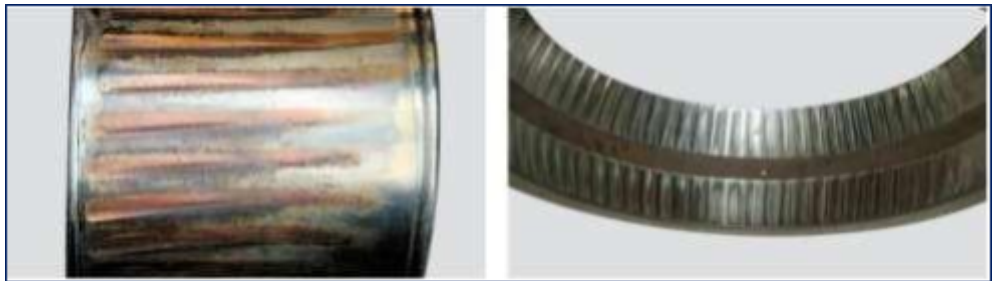
Figura 138. Deformación de superficie de aros.
