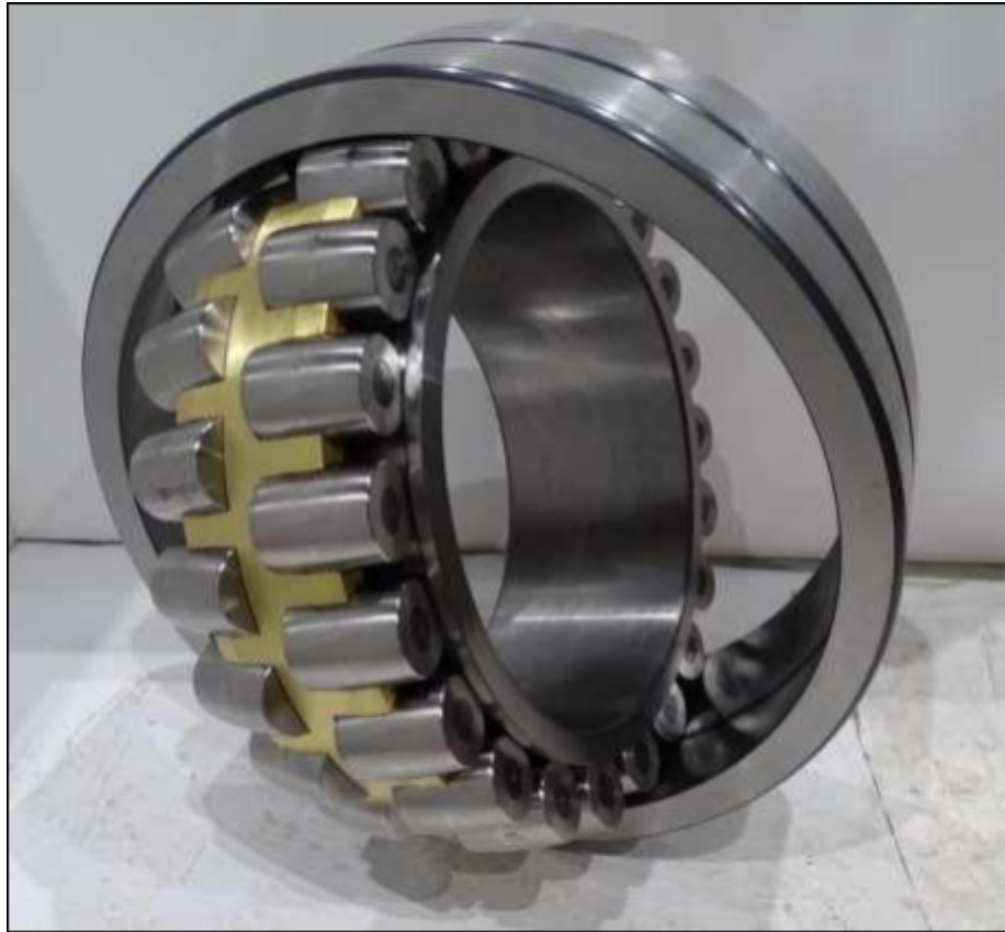
Figura 129. Estado de rodamiento recuperado después de limpieza.
