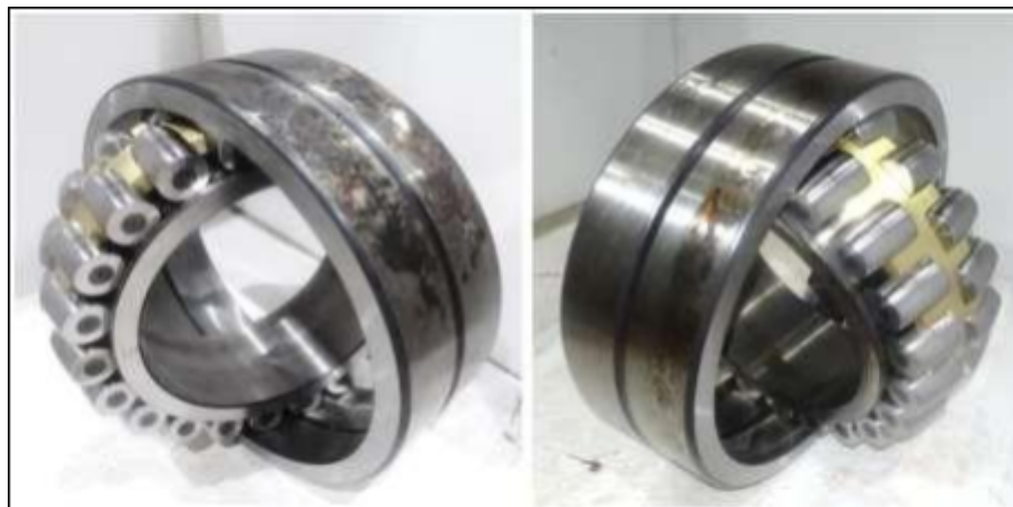
Figura 114. Rodamientos 231/560 aprobados para recuperación.
