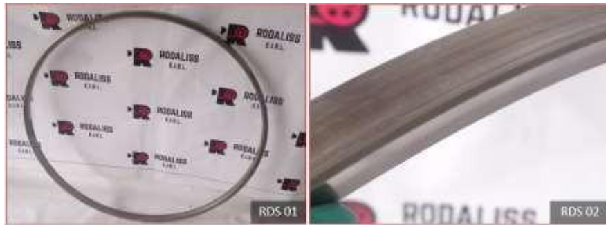
Figura 66. Estado final de anillo Nota. Reporte de remanufactura de rodamiento (18)
