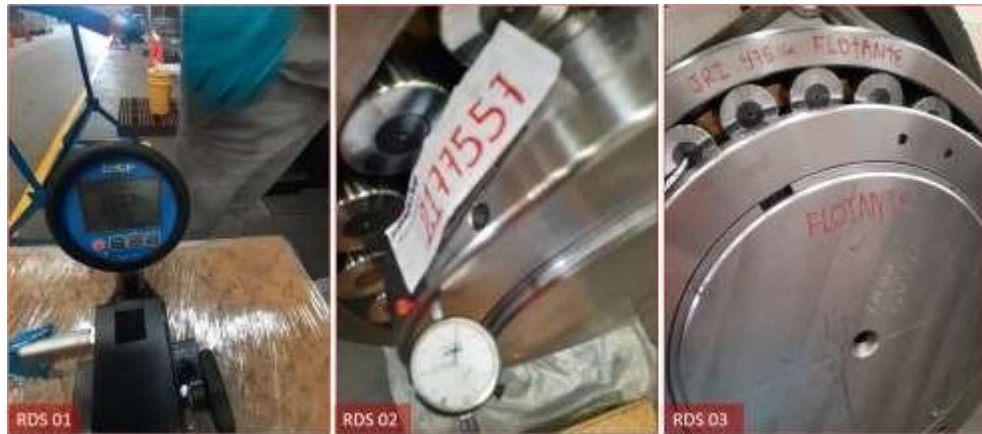
Figura 102. Calado de rodamiento Nota. Reporte de montaje de rodamientos (19)
