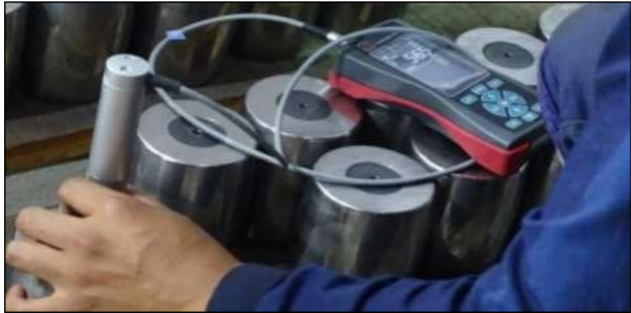
Figura 115. Medición de dureza y ultrasonido de elementos rodantes.
