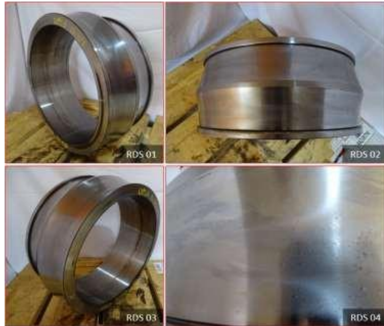
Figura 61. Estado inicial de aro interior Nota. Reporte de remanufactura de rodamiento (18)
