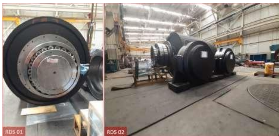
Figura 100. Rodamiento montado Nota. Reporte de montaje de rodamientos (19)
