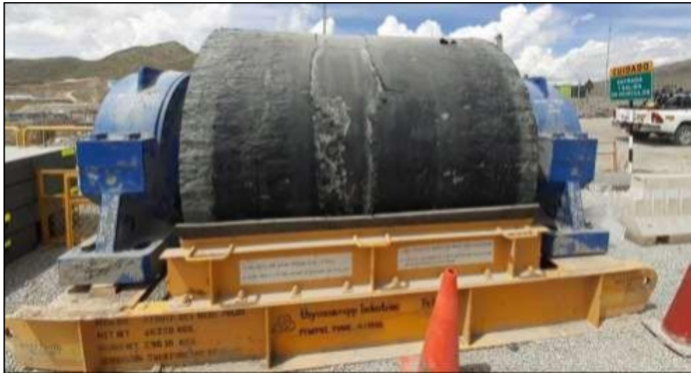
Figura 11. Polea ND2 retirada para mantenimiento.
