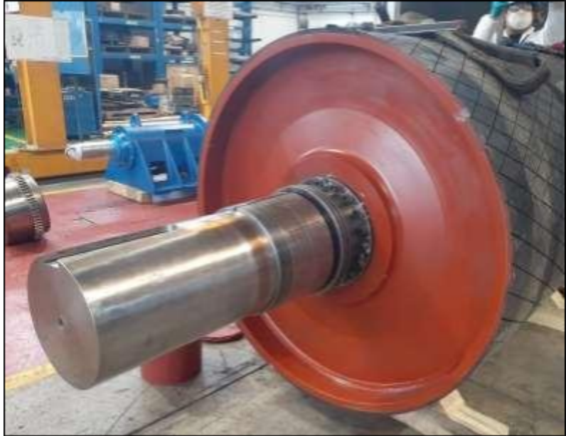
Figura 20. Eje montado en polea motriz, se observa que tiene una sección extra para el montaje de acople de alta.
