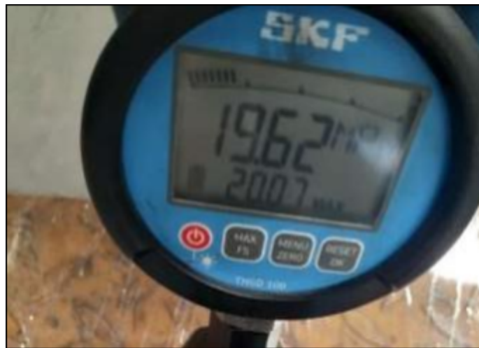
Figura 125. Primer ajuste para posición cero del rodamiento.
