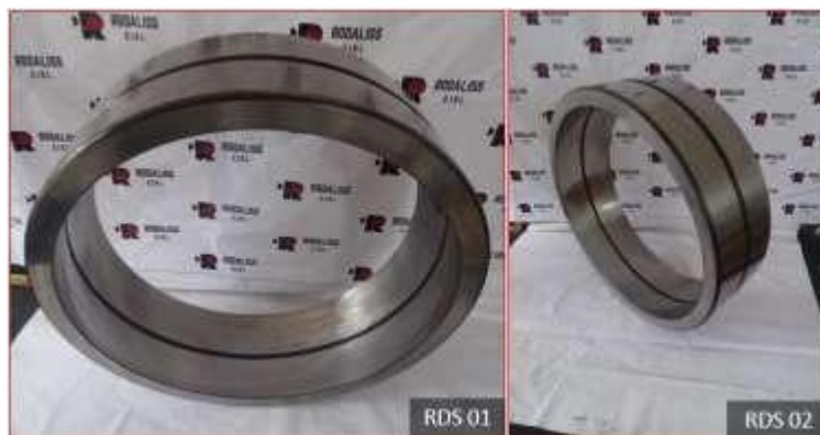
Figura 70. Estado final de aro exterior Nota. Reporte de remanufactura de rodamiento (18)
