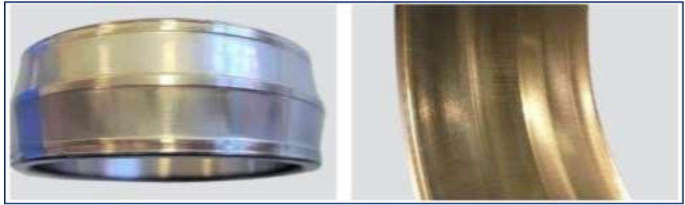
Figura 137. Desgaste abrasivo sobre superficie camino de rodadura de rodamiento.
