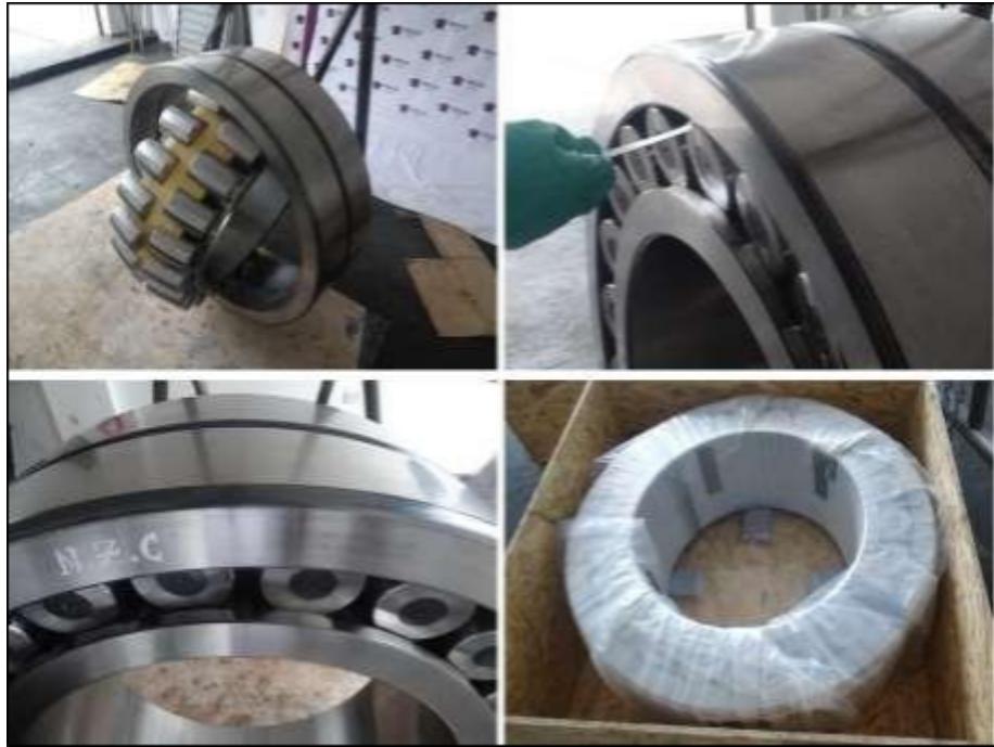
Figura 122. Proceso completo de recuperación de rodamientos.
