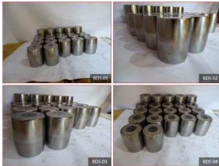
Figura 77. Estado inicial de elementos rodantes Nota. Reporte de remanufactura de rodamiento (18)
