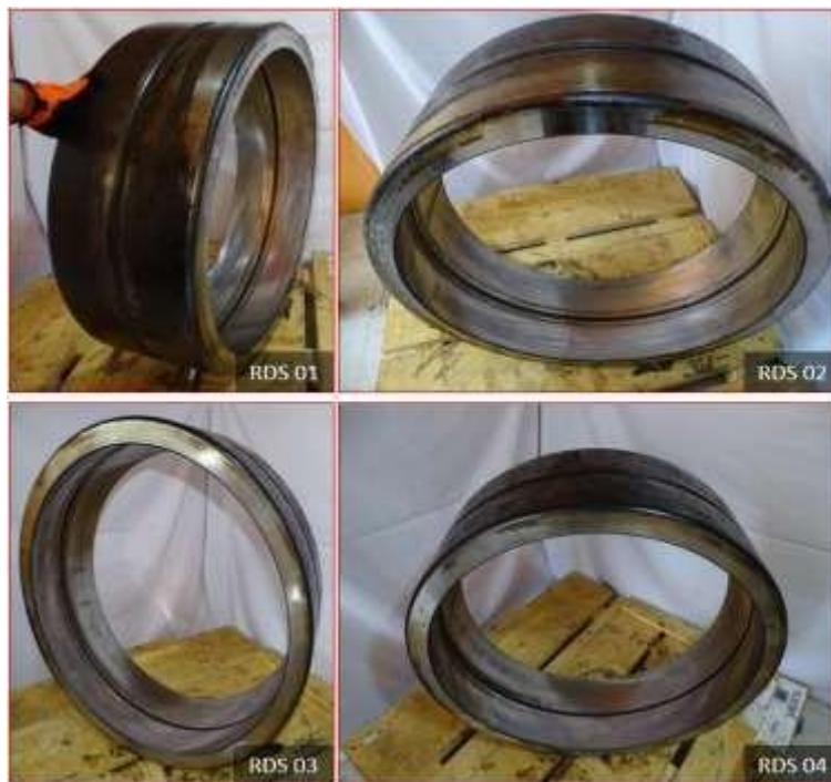
Figura 59. Estado inicial de aro exterior Nota. Reporte de remanufactura de rodamiento (18)
