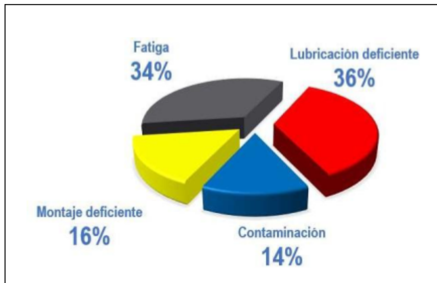
Figura 34. Porcentaje de 4 modos de falla en rodamientos a nivel mundial.
