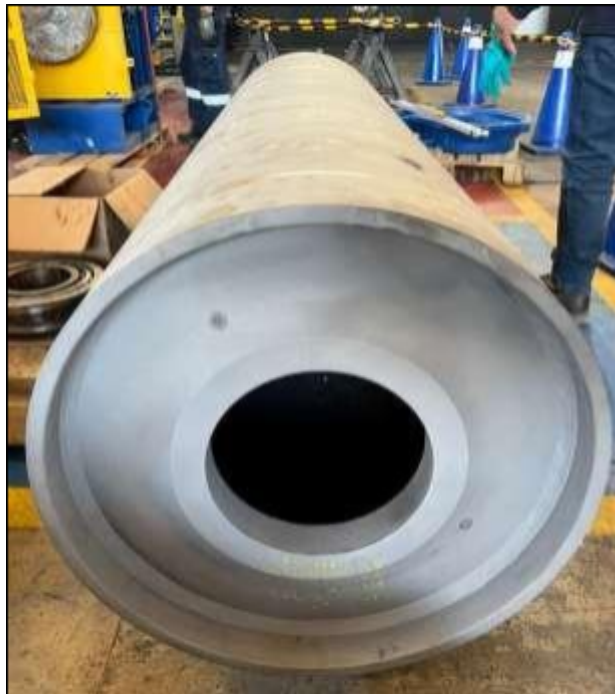
Figura 19. Tambor de polea granallada lista para pegado de lagging nuevo.
