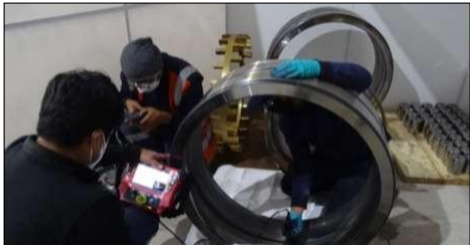
Figura 117. Medición de dureza y ultrasonido de aros.
