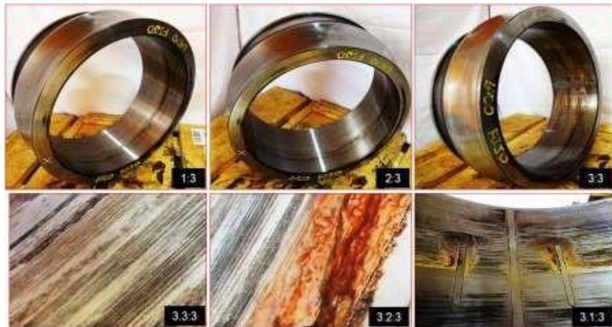
Figura 52. Agujero interior de aro exterior de rodamiento 231/560 Nota. Informe de inspección (17)
