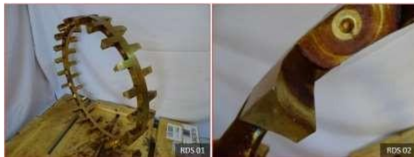
Figura 73. Estado inicial de jaula Nota. Reporte de remanufactura de rodamiento (18)
