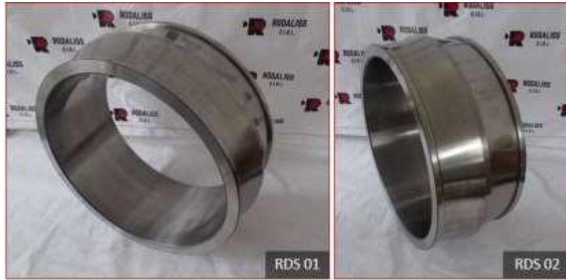
Figura 72. Estado final de aro interior Nota. Reporte de remanufactura de rodamiento (18)
