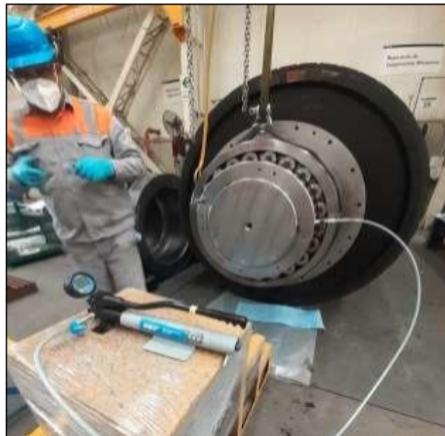
Figura 44. Herramientas para el montaje de rodamientos por inyección de aceite sobre pistón hidráulico.
