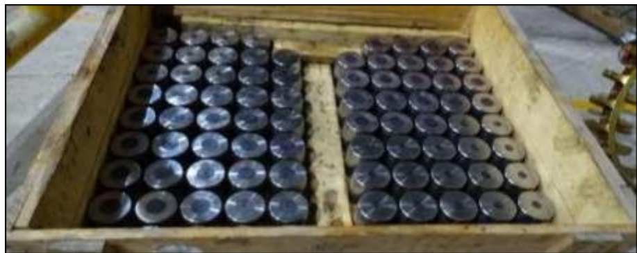
Figura 116. Ubicación de elementos rodantes por hilera para el pulido.
