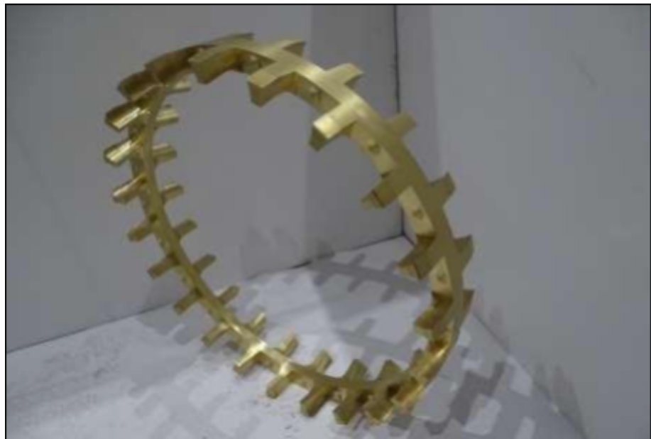
Figura 132. Estado de jaula después de limpieza.
