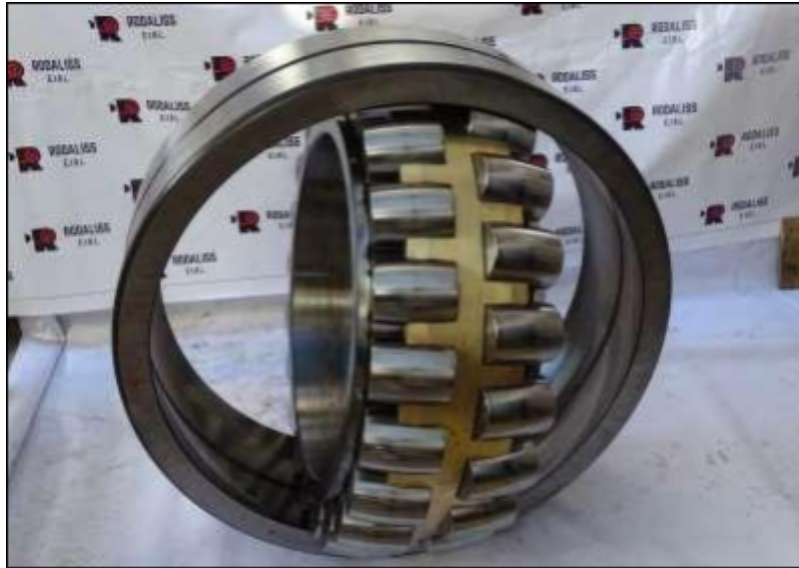
Figura 13. Estado de rodamiento SRB usado 231/560.
