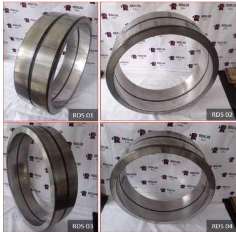
Figura 60. Estado final de aro exterior Nota. Reporte de remanufactura de rodamiento (18)
