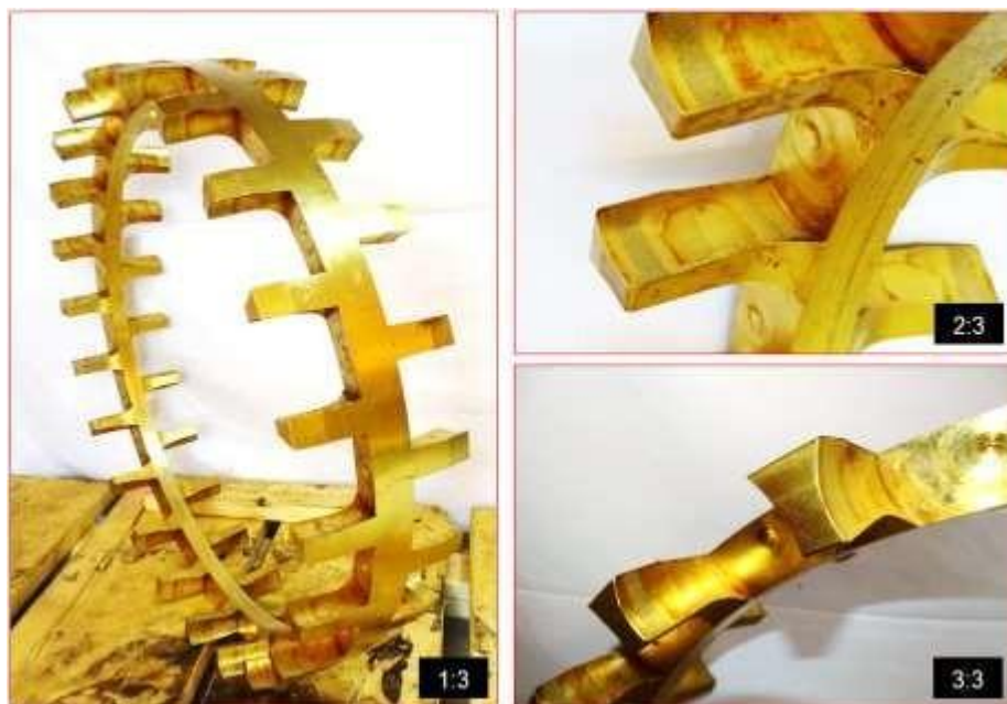
Figura 53. Jaula de bronce de rodamiento 231/560 Nota. Informe de inspección (17)
