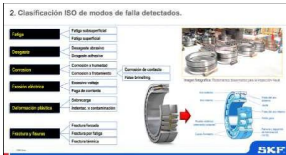
Figura 110. Modos de falla de rodamientos según ISO Nota. Web site SKF (2)
