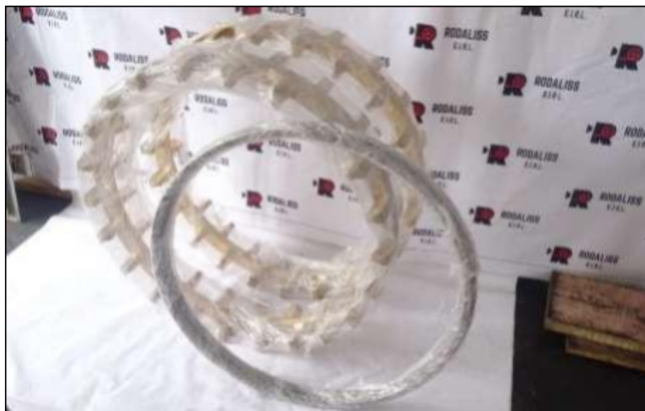
Figura 119. Aro interno pulido y listo para montaje.
