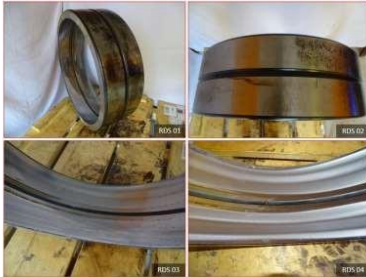
Figura 69. Estado inicial de aro exterior Nota. Reporte de remanufactura de rodamiento (18)
