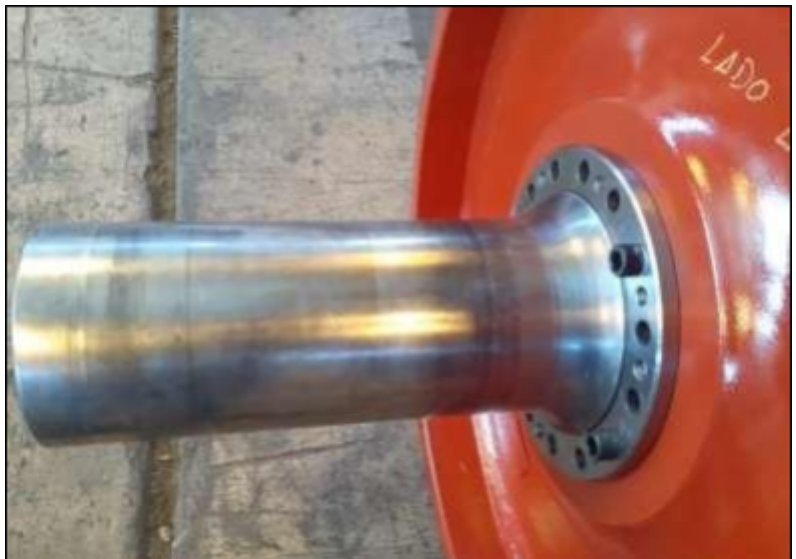
Figura 21. Montaje de B Loc que sujeta a tambor y eje de la polea.
