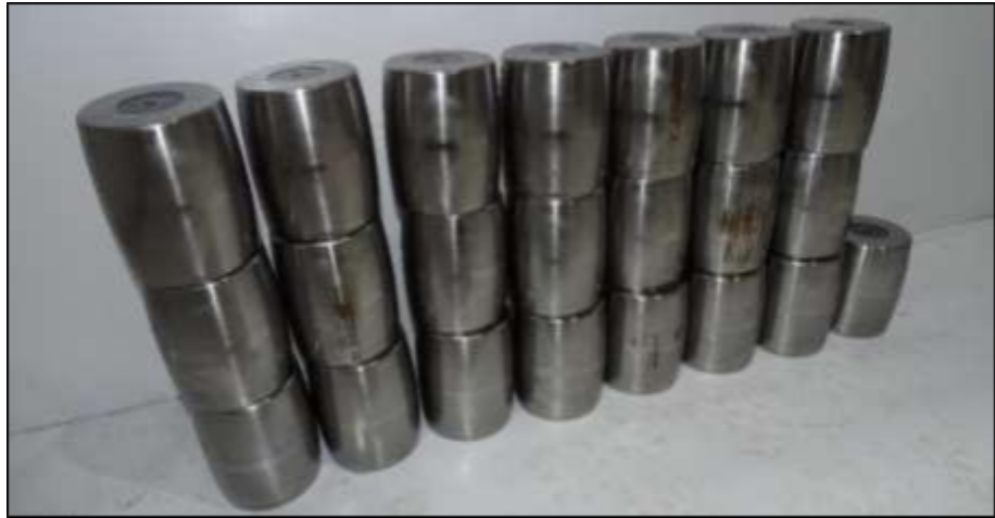
Figura 131. Estado de elementos rodantes después de inspeccionarlos.
