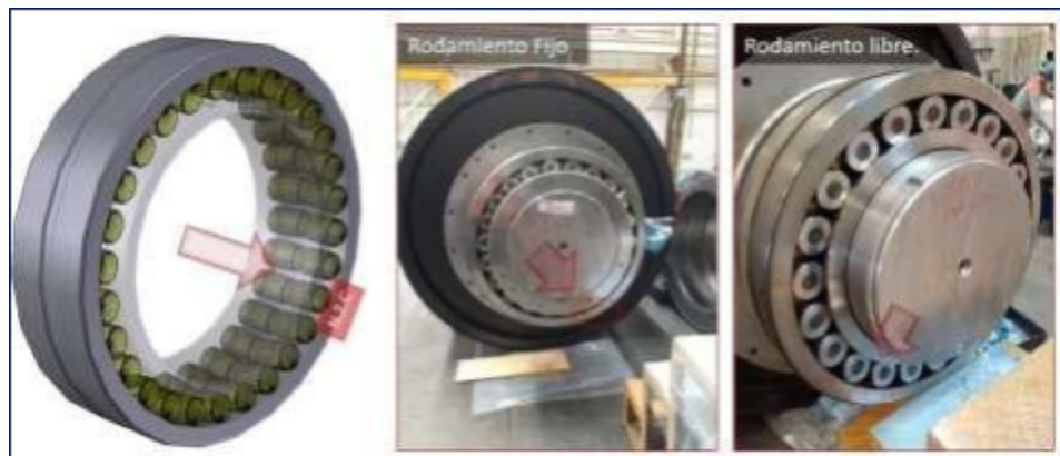
Figura 104. Designación de nuevo patrón de carga Nota. Reporte de montaje de rodamientos (19)
