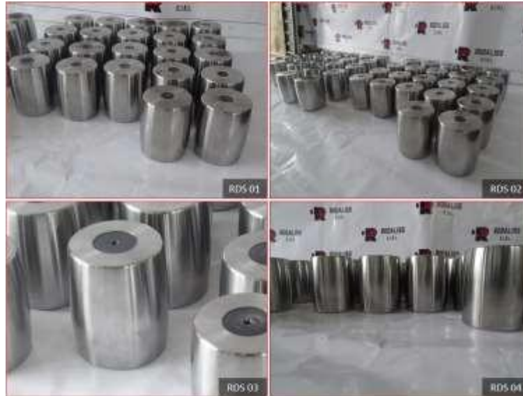
Figura 68. Estado final de elementos rodantes Nota. Reporte de remanufactura de rodamiento (18)
