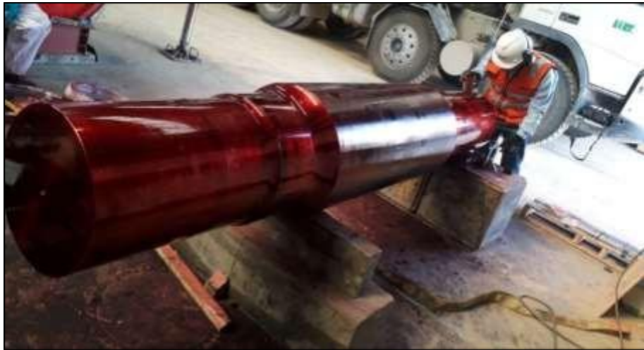
Figura 8. Ensayo no destructivo a eje de polea.
