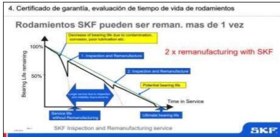
Figura 108. Curva de desgaste rodamientos SRB. Nota. Web site SKF (2)
