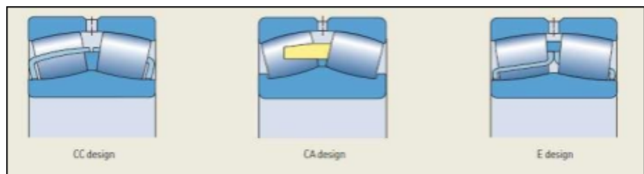
Figura 29. Jaulas CC. de tipo ventana con material de acero, CA Jaulas tipo espina con material de latón y E jaula de tipo ventana con material de acero.
