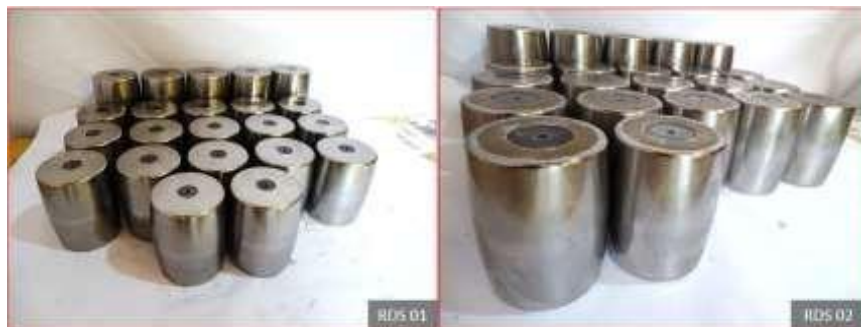
Figura 67. Estado inicial de elementos rodantes Nota. Reporte de remanufactura de rodamiento (18)
