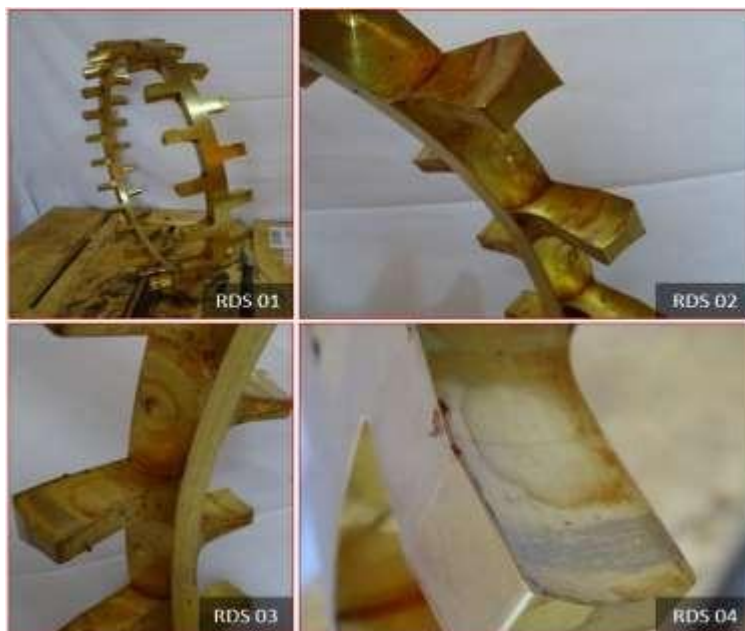
Figura 63. Estado inicial de jaula Nota. Reporte de remanufactura de rodamiento (18)
