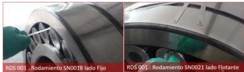
Figura 96. Medición de juego radial de rodamientos Nota. Reporte de montaje de rodamientos (19)
