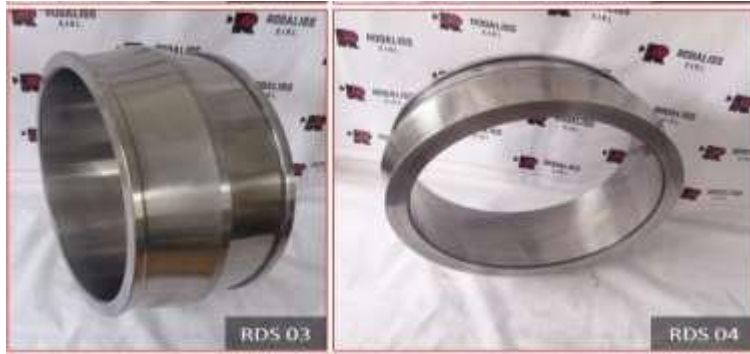
Figura 62. Estado final de aro interior Nota. Reporte de remanufactura de rodamiento (18)
