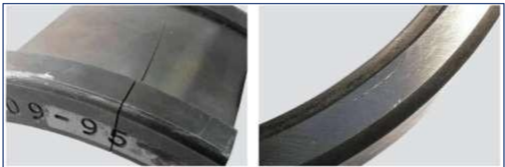
Figura 136. Fractura de aros de rodamientos. Nota.: Libro daño de rodamientos y análisis de falla (21)
