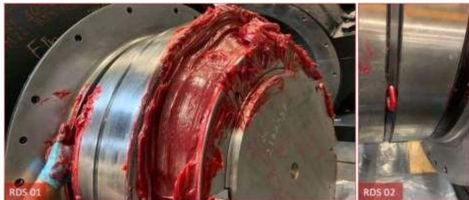
Figura 105. Lubricación de rodamientos Nota. Reporte de montaje de rodamientos (19)
