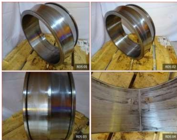
Figura 71. Estado inicial de aro interior Nota. Reporte de remanufactura de rodamiento (18)
