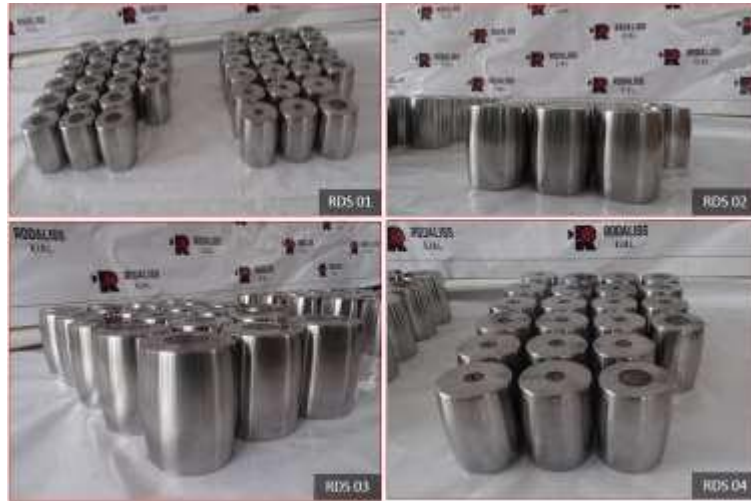
Figura 78. Estado final de elementos rodantes Nota. Reporte de remanufactura de rodamiento (18)
