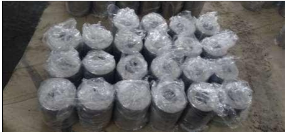
Figura 121. Elementos rodantes pulidos y listos para montaje.
