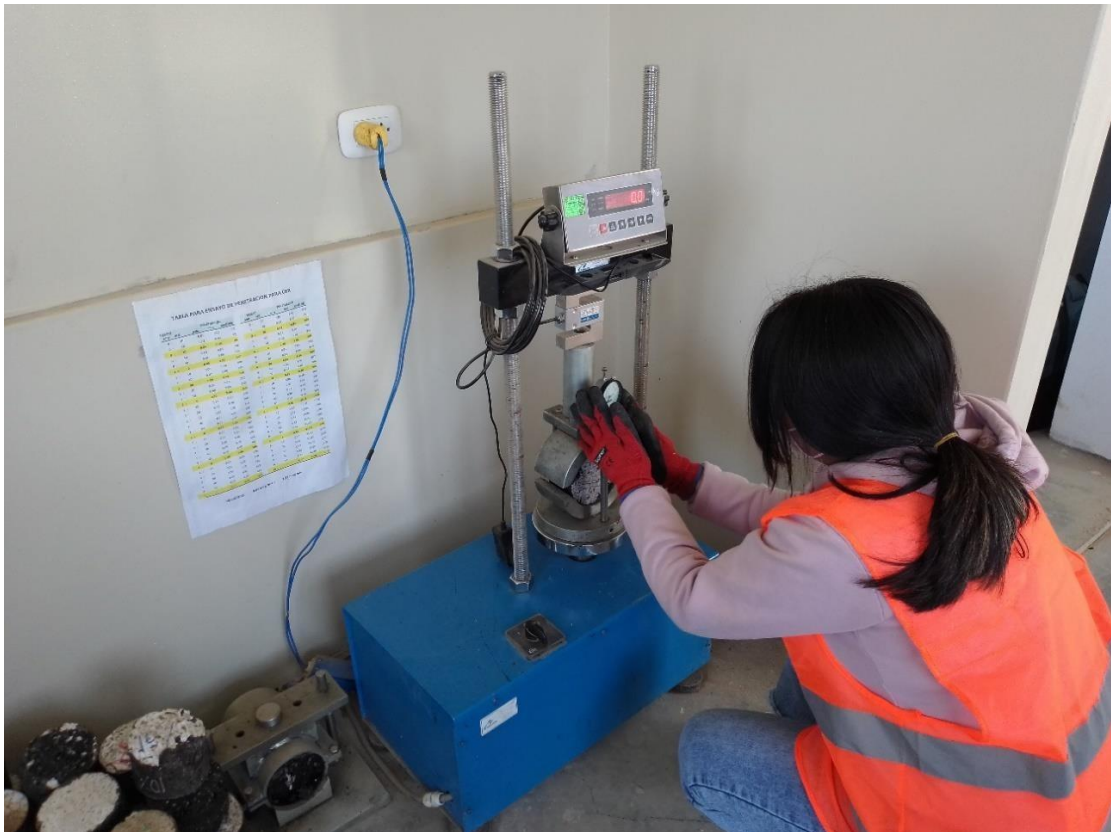
Anexo 42: Colocado del dial para la medición del flujo o deformación.
