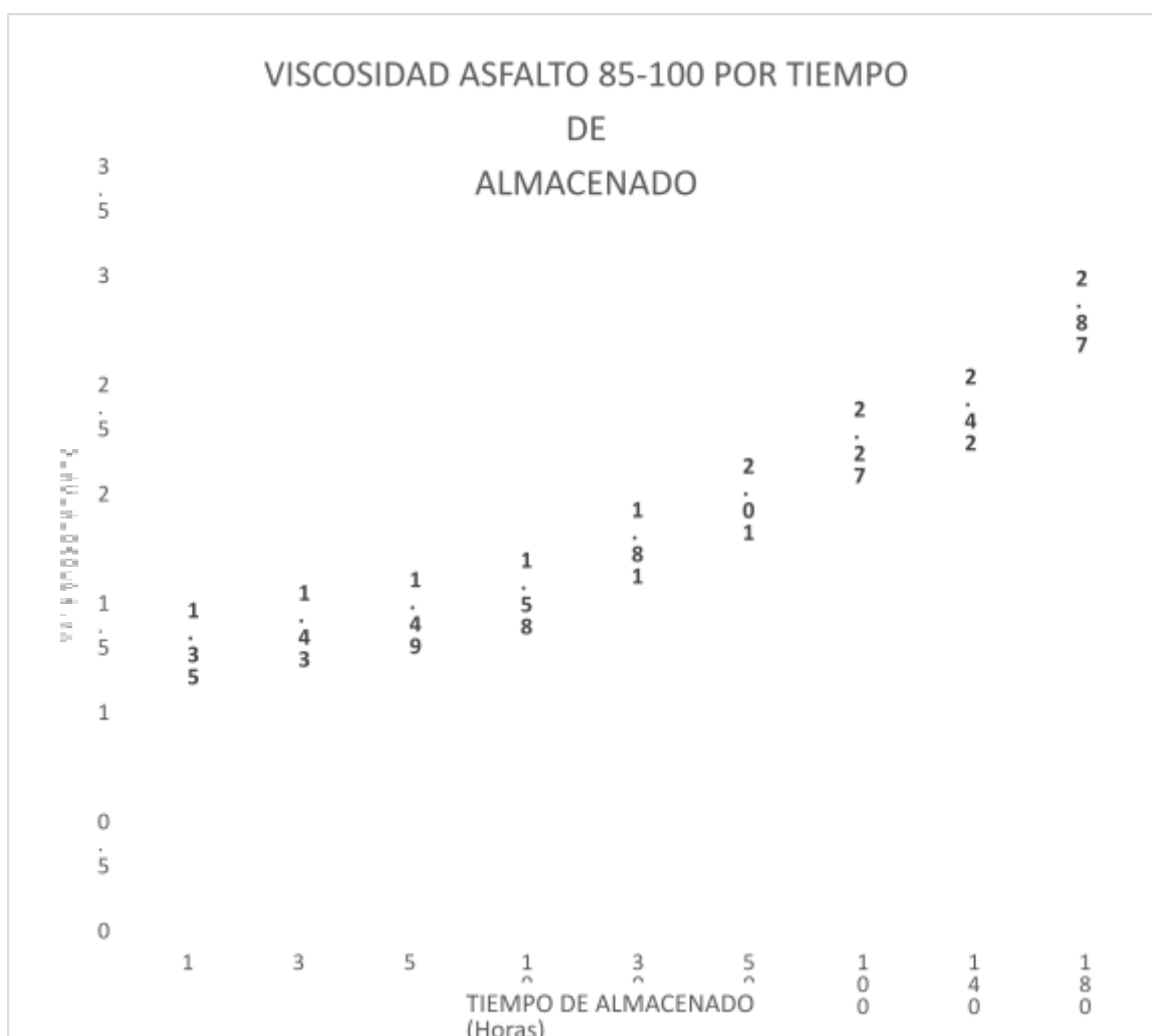
Figura 11: Viscosidad del asfalto PEN 85-100 con almacenado en horas
