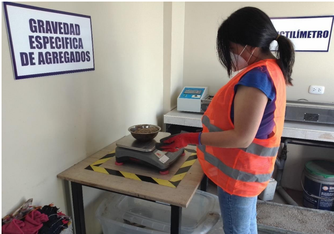
Anexo 22: Pesado de la arena para realizar el ensayo de granulometría
