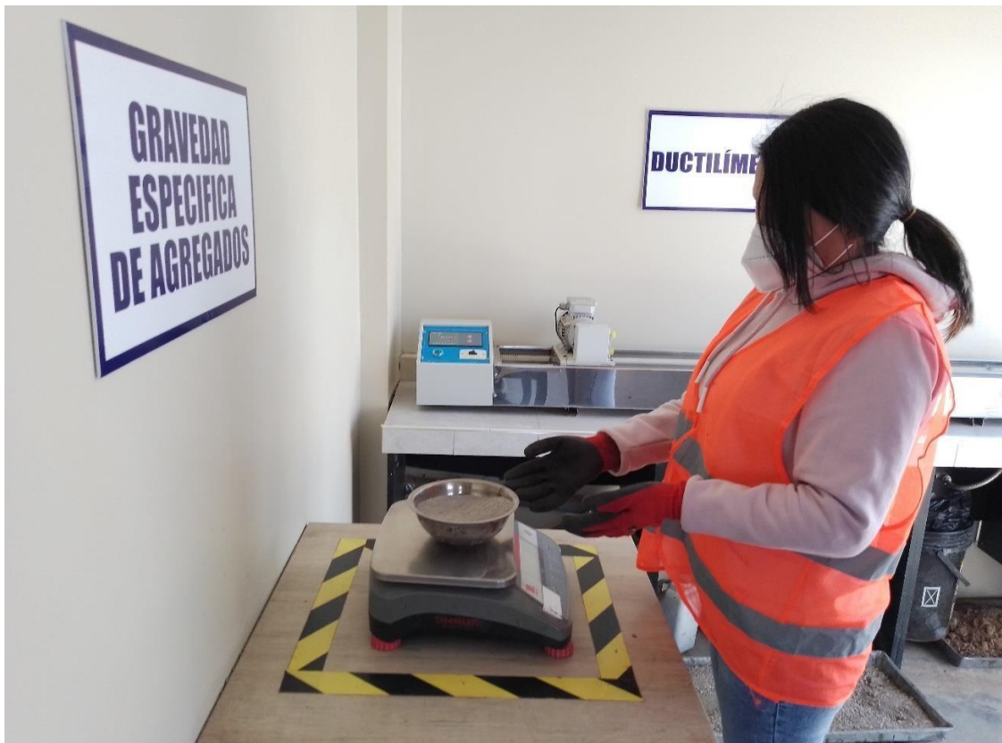
Anexo 26: Pesado del cemento para realizar el ensayo de granulometría
