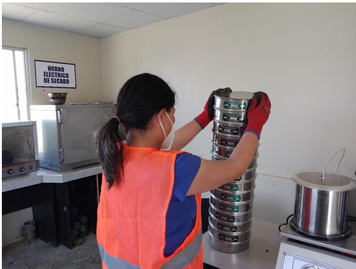
Anexo 24: Pesado de las muestras retenidas del ensayo de granulometría
