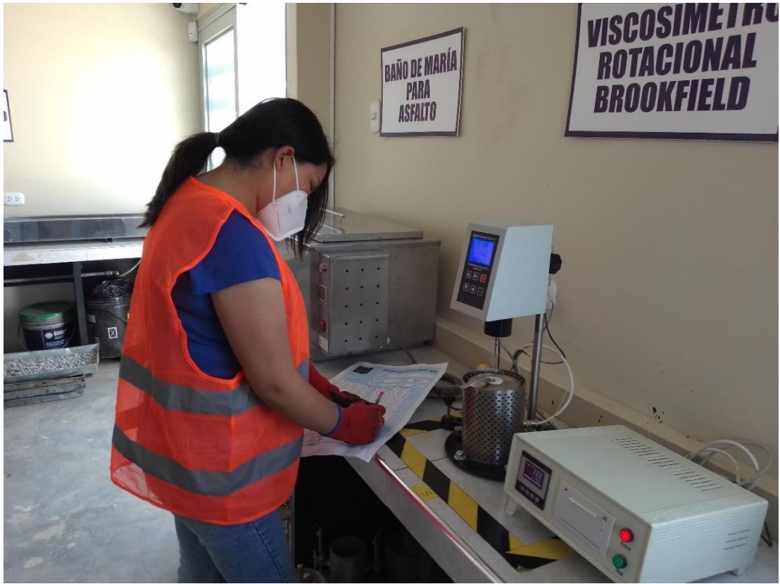
Anexo 18: Término del ensayo de viscosidad
