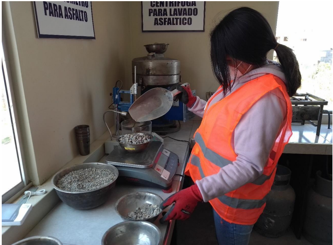
Anexo 30: Calentado de las muestras con el diseño de mezclas a una temperatura de 135°C
