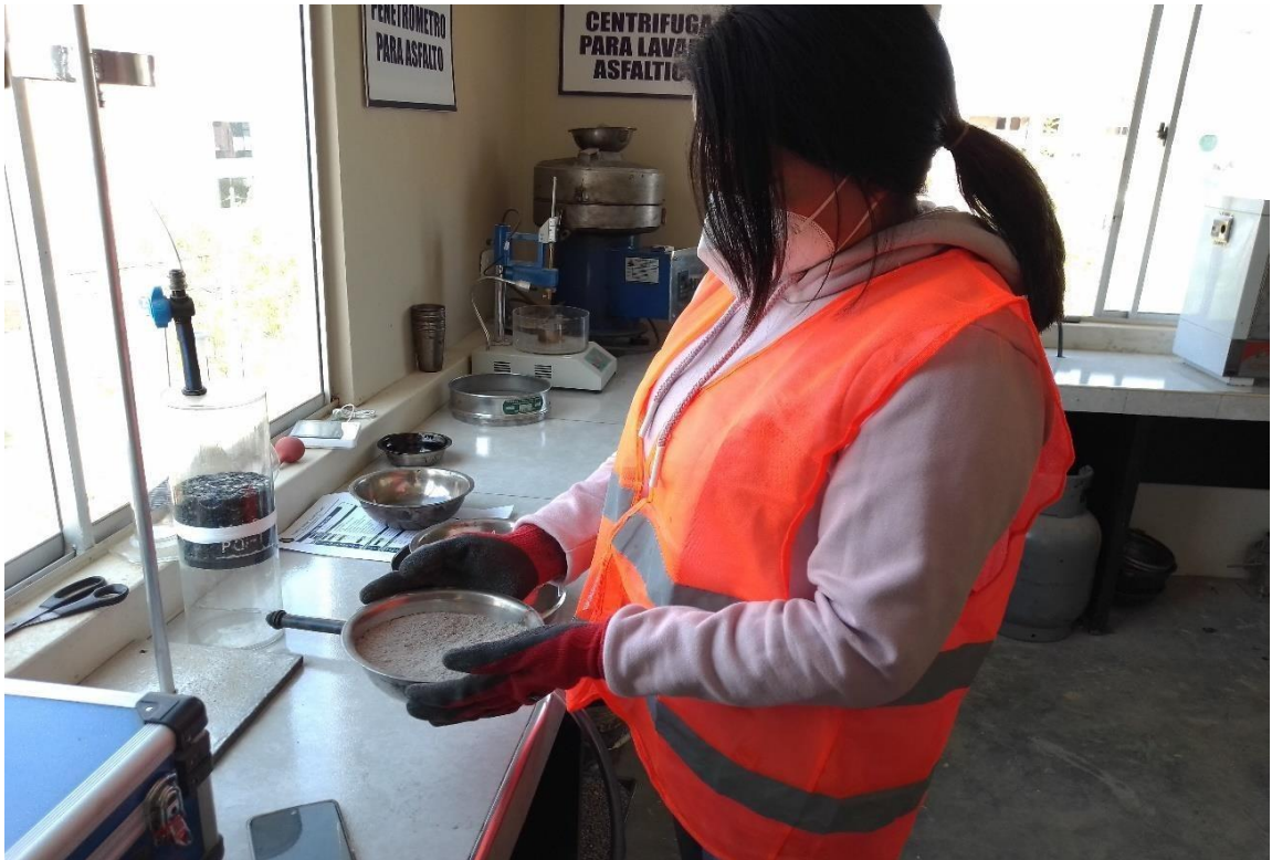
Anexo 26: Pesado del cemento para realizar el ensayo de granulometría
