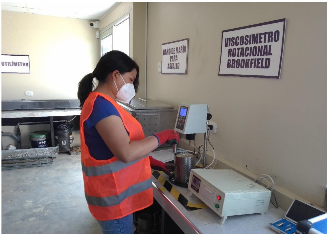
Anexo 18: Término del ensayo de viscosidad
