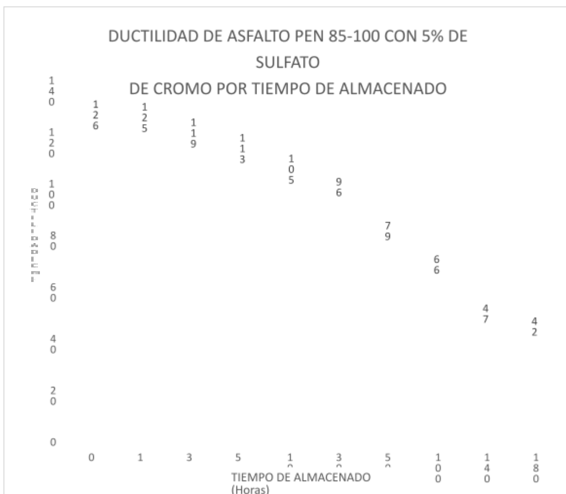
Figura 27: Resultados de Ductilidad del cemento asfáltico 85-100+ 5% de sulfato de cromo
