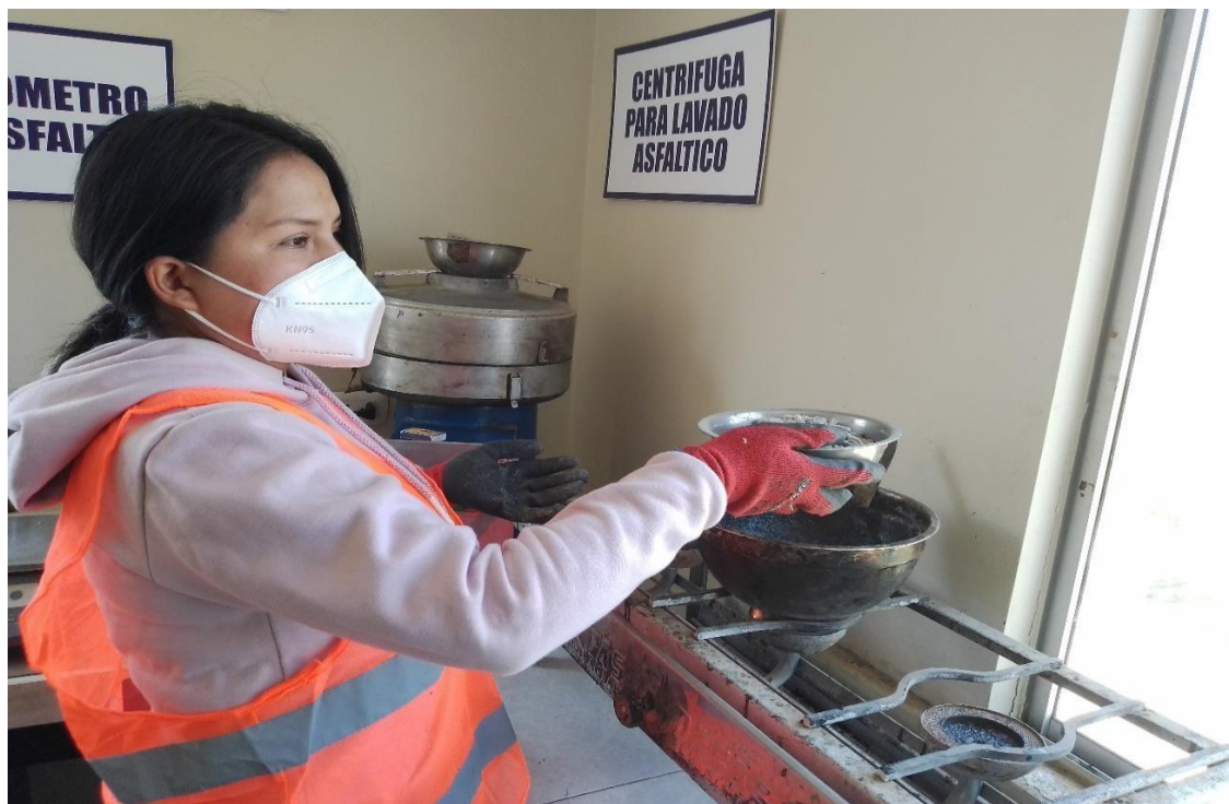
Anexo 30: Calentado de las muestras con el diseño de mezclas a una temperatura de 135°C
