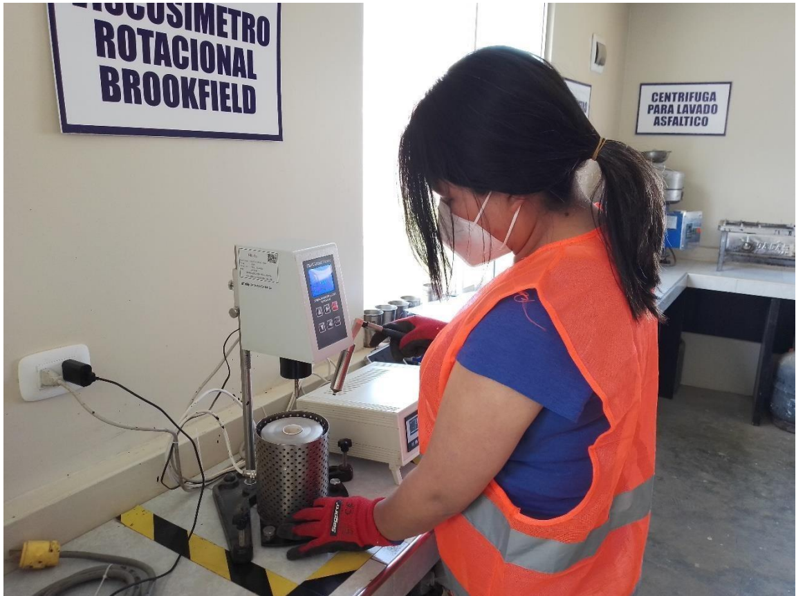
Anexo 14: Colocación de la aguja del viscosímetro en la cápsula.
