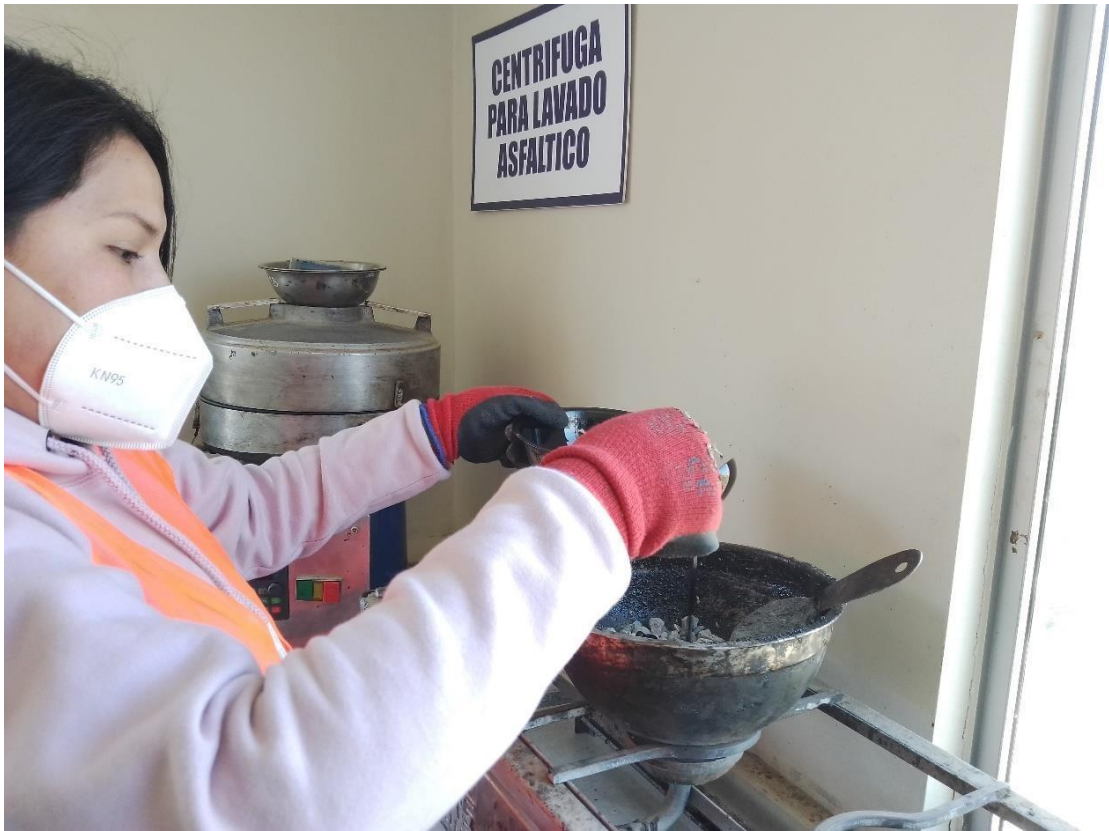
Anexo 32: Mezclado del cemento asfáltico con los agregados hasta obtener una mezcla homogénea
