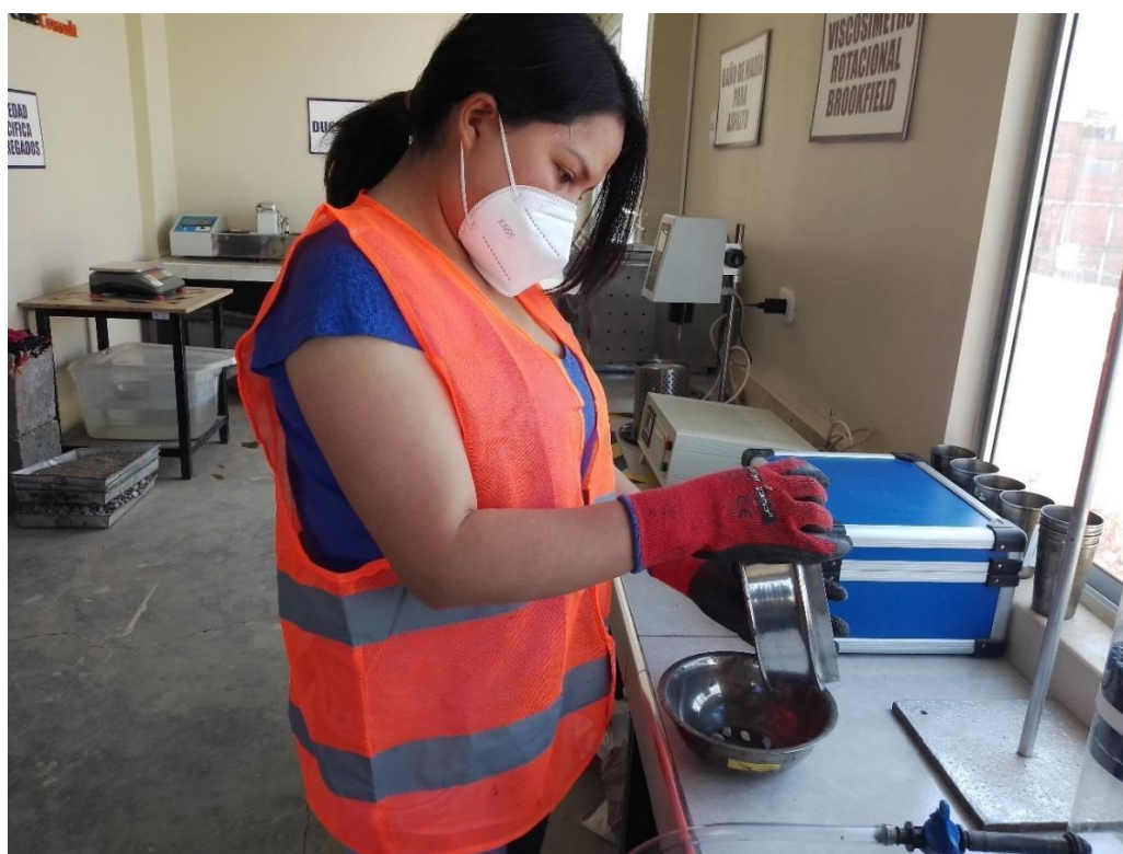
Anexo 24: Pesado de las muestras retenidas del ensayo de granulometría
