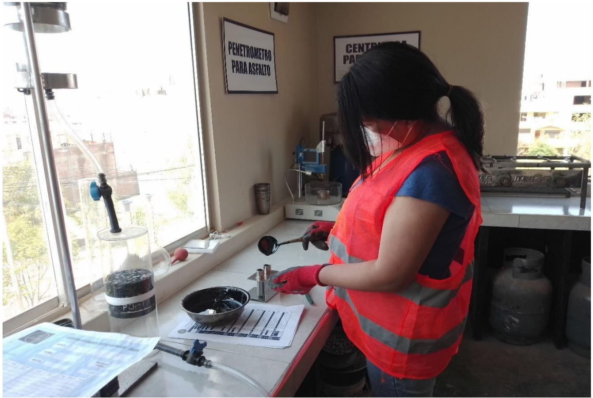
Anexo 12: Traslado de la cápsula con ayuda de la pinza al viscosímetro
