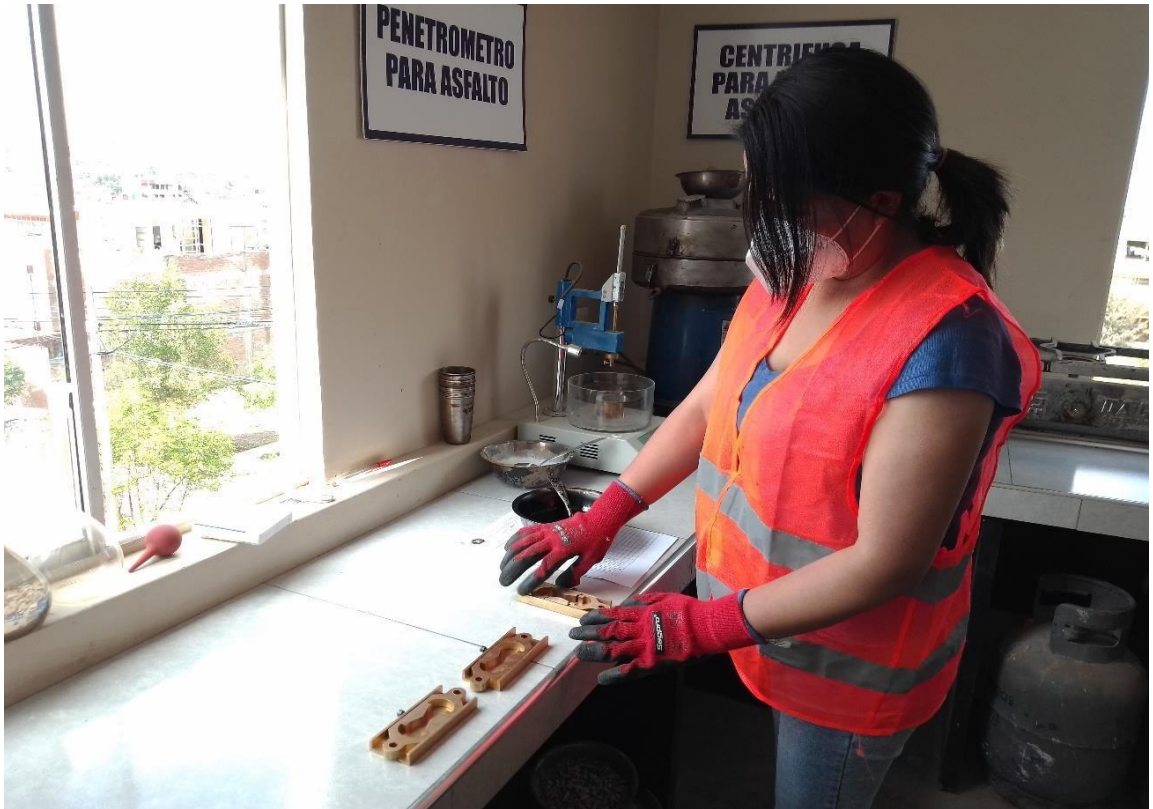
Anexo 4: Vaciado del cemento asfáltico al molde del ductilómetro
