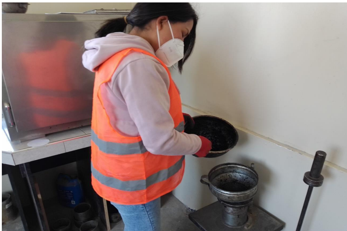
Anexo 35: Faciendo de la mezcla asfáltica en el molde
