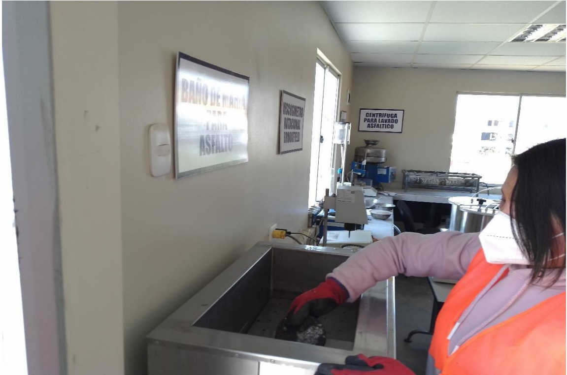
Anexo 40: Retirado y secado de la muestra para ensayar Marshall.
