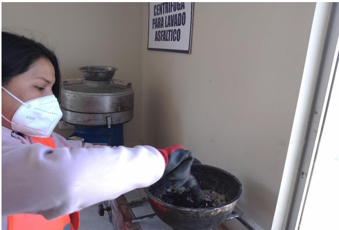
Anexo 32: Mezclado del cemento asfáltico con los agregados hasta obtener una mezcla homogénea
