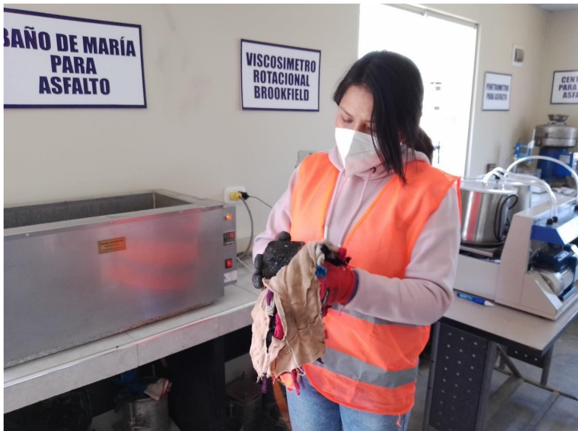
Anexo 40: Retirado y secado de la muestra para ensayar Marshall.
