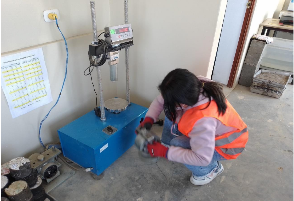
Anexo 43: Retirada de la muestra compactada de la prensa Marshall
