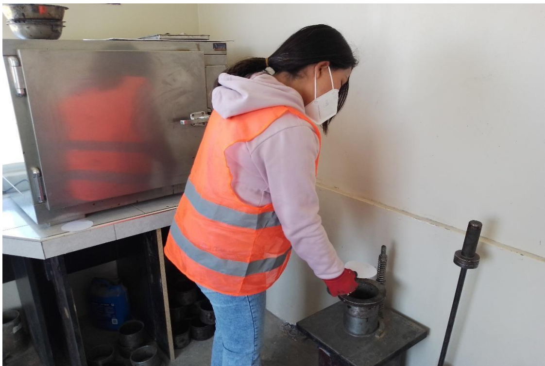
Anexo 34: Colocado del papel filtro sobre la base del molde
