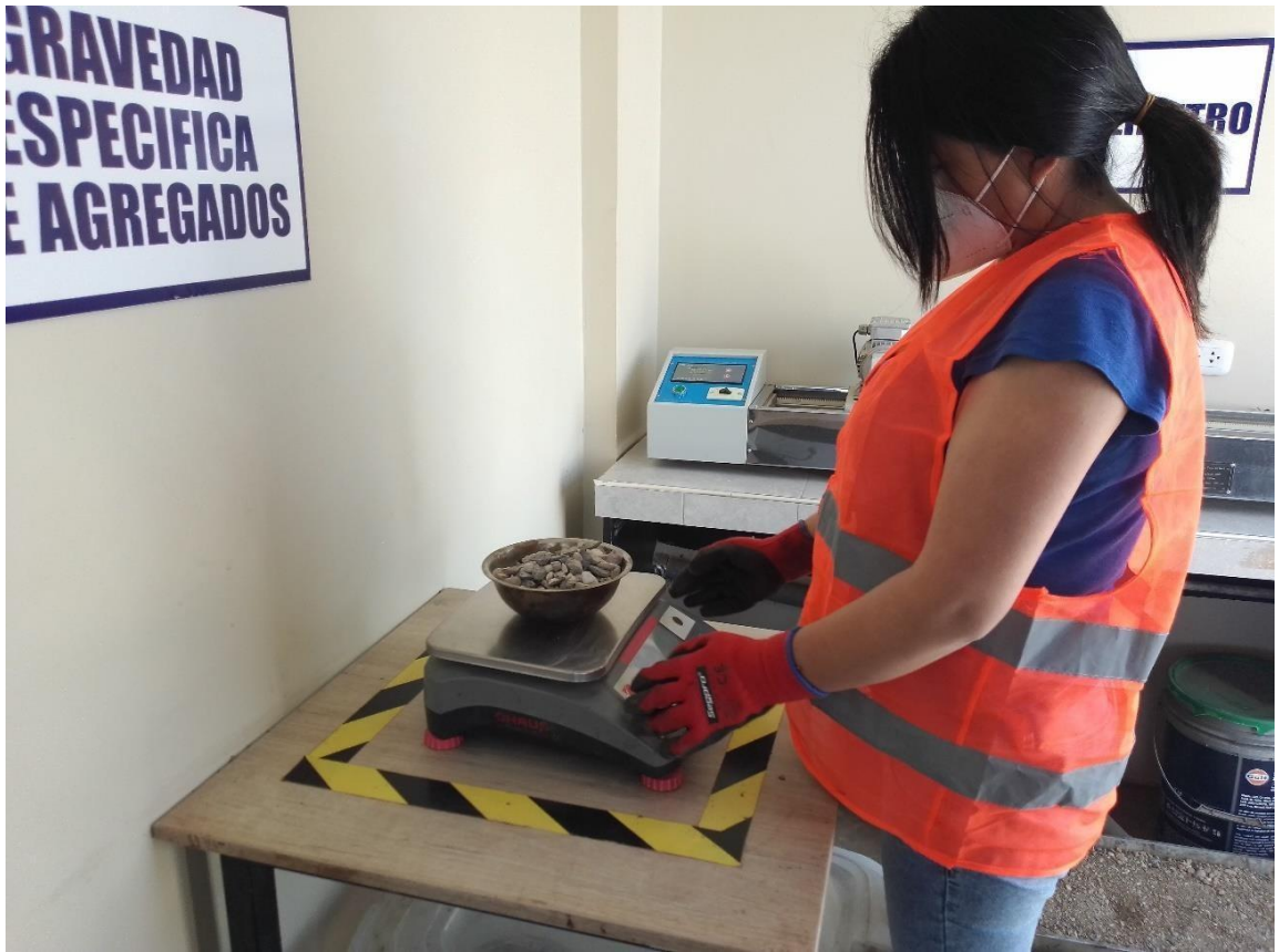
Anexo 22: Pesado de la arena para realizar el ensayo de granulometría
