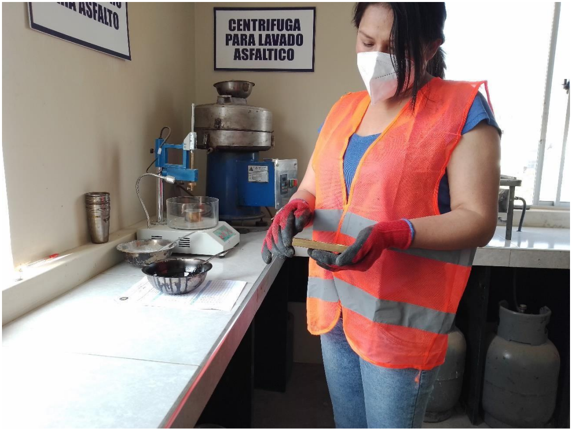
Anexo 6: Colocado del molde en el ductilómetro
