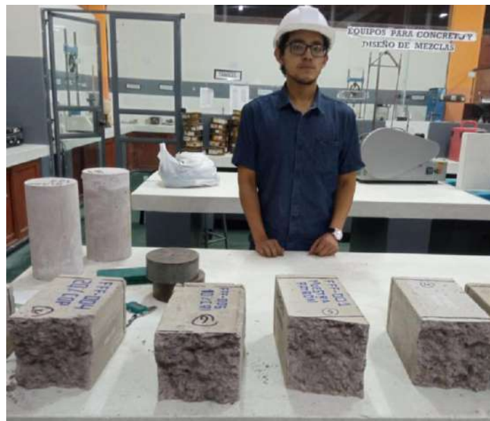
Ensayo de resistencia a la flexión en vigas de concreto.
