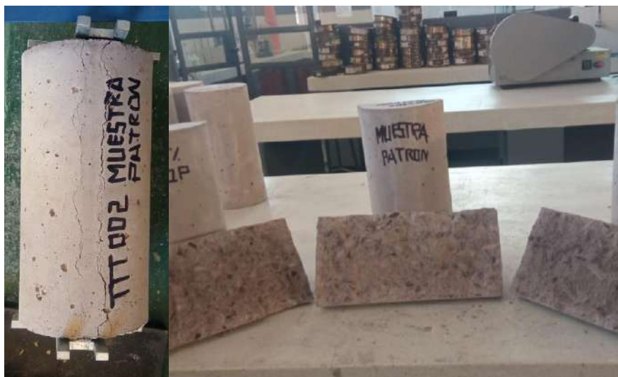
Ensayo de resistencia a la tracción indirecta del concreto.
