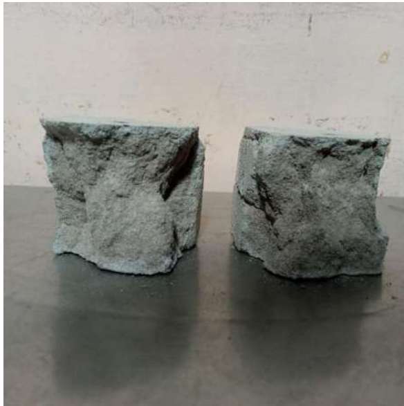
Morteros de cemento tipo I con ceniza co-pliniana después de la falla.
