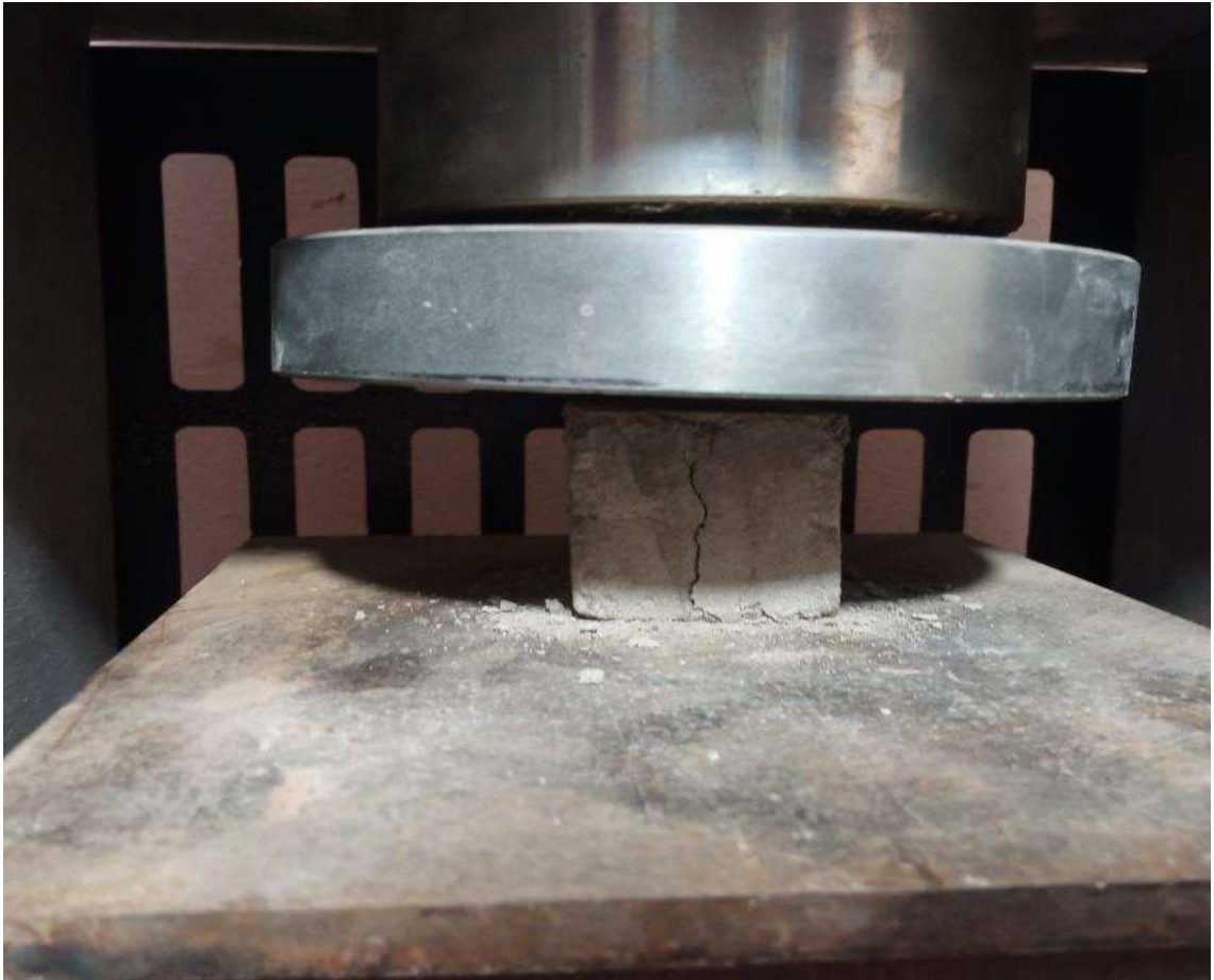
Ensayo de compresión para morteros.
