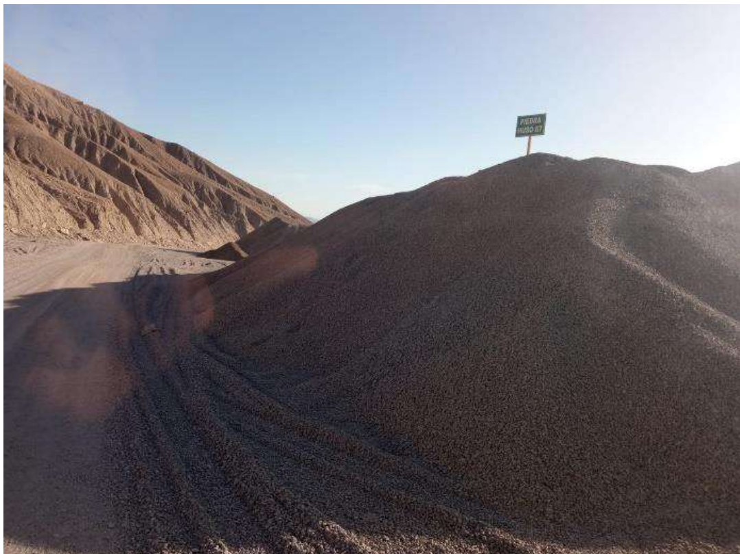
Figura 20. Agregado grueso - HUSO 67 de la cantera Radcom 3.
