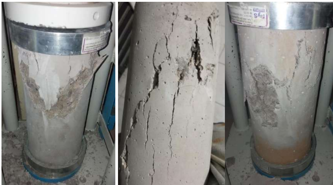
Fallas en probetas de concreto después de ser sometidas a esfuerzos de compresión.
