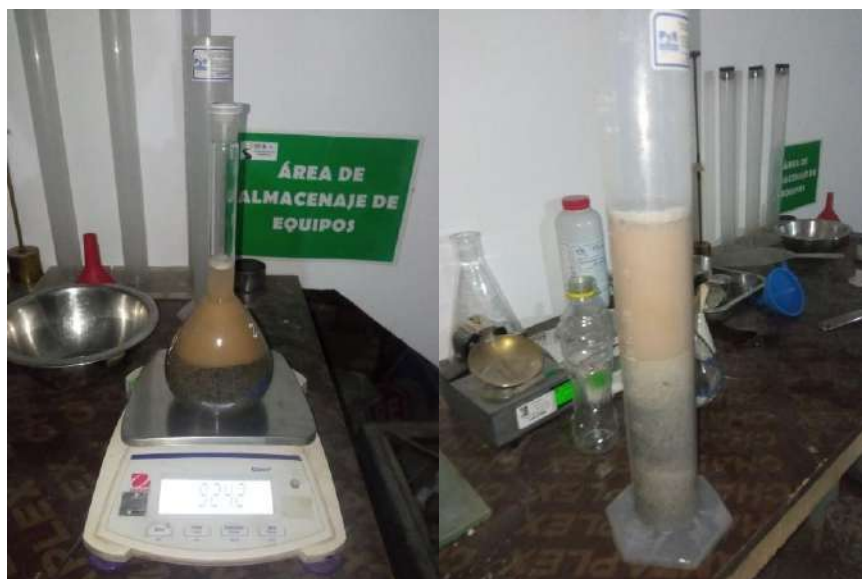
Figura 17. Matraz / ceniza de cristal y picnómetro / ceniza co-pliniana.
