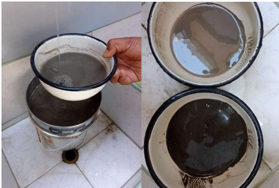
Lavado de cenizas en un tamiz No. 325 (45 \mu m).
