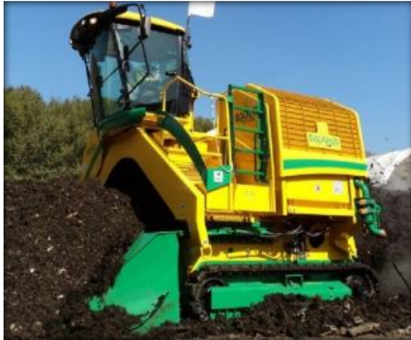
Figura 3. Volteo mecanizado de compost (29)
