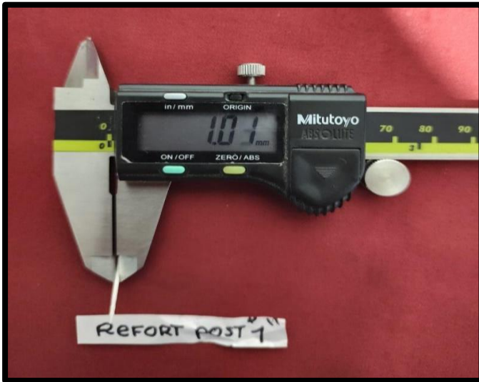
Imagen 8. Calibrador con el poste de fibra de vidrio REFORPOST 1
