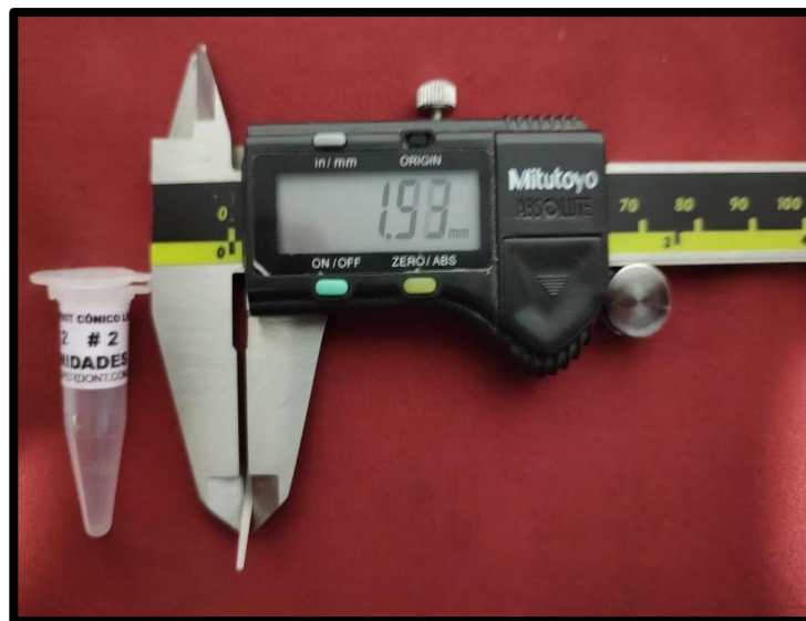
Imagen 6. Calibrador con el poste de fibra de vidrio Superpost 2
