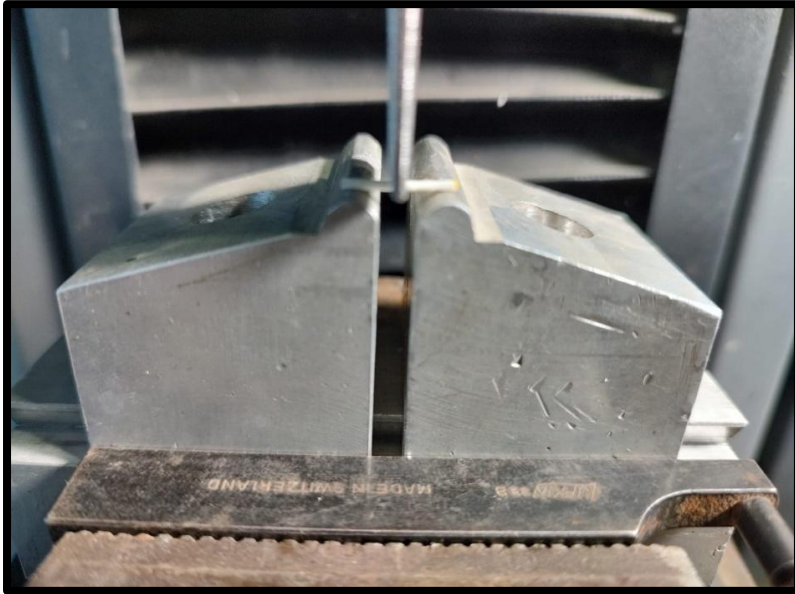
Imagen 11. Comienzo del ensayo de Resistencia del poste de fibra de vidrio REFORPOST 1
