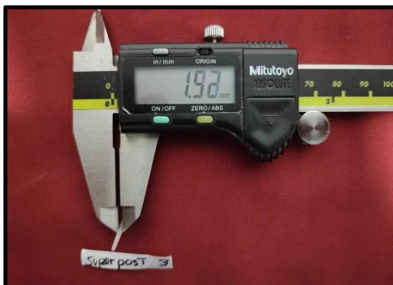
Imagen 7. Calibrador con el poste de fibra de vidrio SUPERPOST 3
