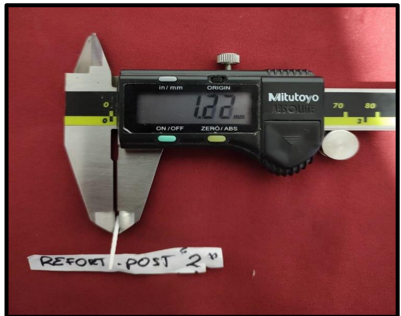
Imagen 9. Calibrador con el poste de fibra de vidrio REFORPOST 2
