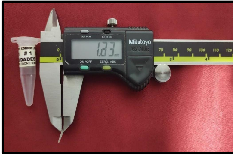
Imagen 5. Calibrador con el poste de fibra de vidrio SUPERPOST 1
