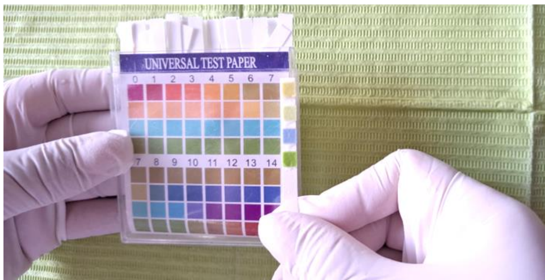
Lectura de la tira reactiva del pH salival obtenida de la muestra con la comparación con la cartilla indicadora de pH Universal Test Paper.
