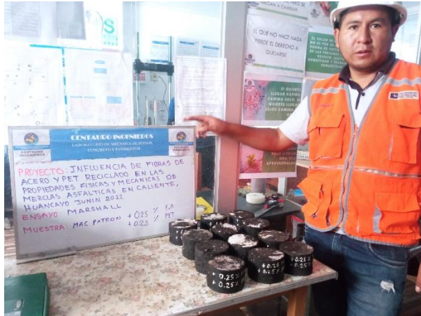
Fotografía N 13: Muestra de briquetas con las distintas adiciones de fibras de acero y PET reciclado.
