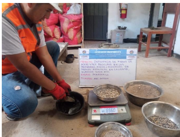
Fotografía N 08: Mezclado de agregados, asfalto y aditivos según dosificación.
