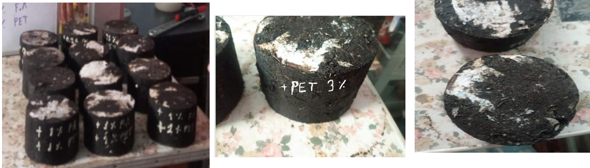
Fotografía N 14-15-16: Muestra de briquetas con las distintas adiciones de fibras de acero y PET reciclado.
