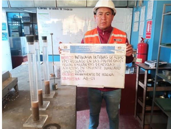
Fotografía N 03: Equivalente de Arena, según NTP 339.146.
