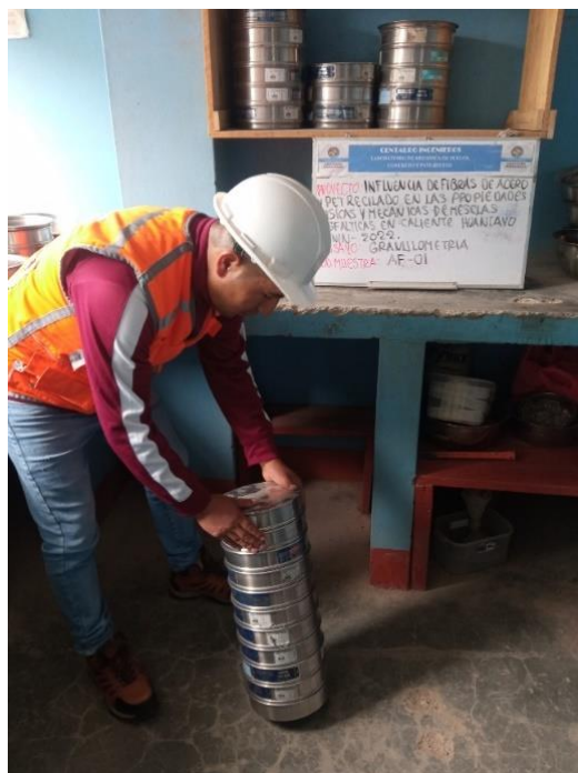
Fotografía N 02: Granulometría de los agregados, según MTC E504.
