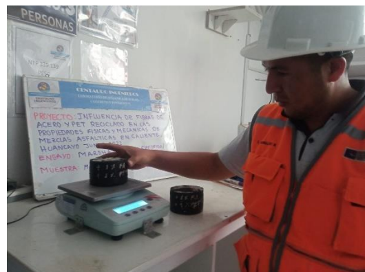
Fotografía N 11-12: Peso volumétrico de las briquetas.
