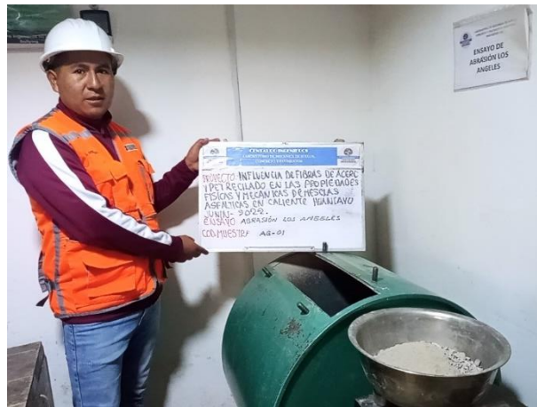
Fotografía N 04: Abrasión los ángeles, según MTC E207.
