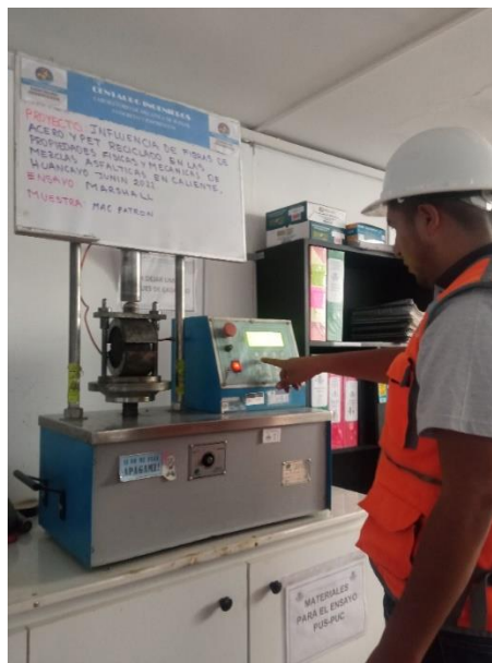
Fotografía N 17: Ejecución del ensayo Marshall para las briquetas y lectura del dial para obtención de resultados, según MTC E504.
