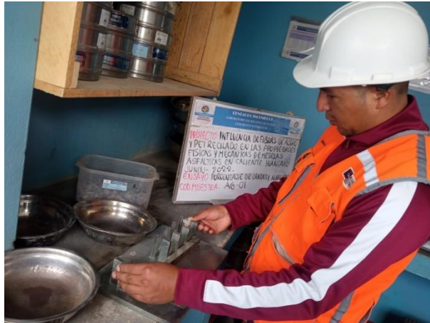
Fotografía N 06: Porcentajes de chatas y alargadas (grosso), según MTC E223.
