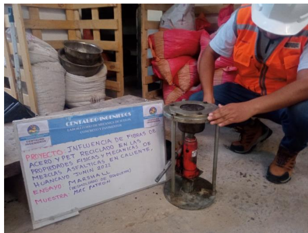
Fotografía N 10: Desmoldado de briquetas con ayuda de gata hidráulica, según MTC E504.
