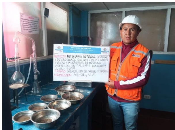
Fotografía N 05: Durabilidad al sulfato de magnesio, según NTP 209-2016.
