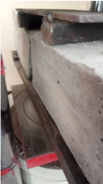
Rotura de viga sin Microfibra de Polipropileno
