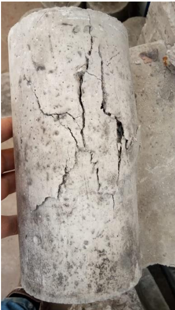
Rotura de probeta de concreto con adición de 300 g/m 3 de microfibra de polipropileno
