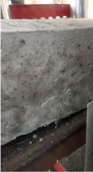
Rotura de viga de concreto con adición de 600 g/m 3 de microfibras de polipropileno
