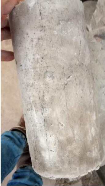
Rotura de probeta de concreto con adición de 1200 g/m 3 de microfibra de polipropileno
