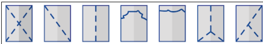
Figura 5 Tipos de fracturas generadas por el ensayo de compresión
