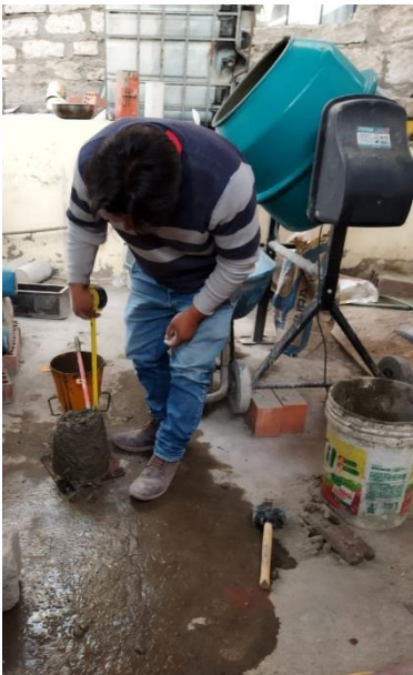
Verificación del Revenimiento
