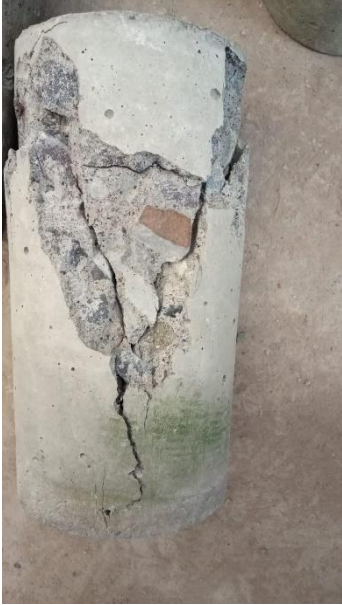
Rotura de probeta de concreto Sin fibra
