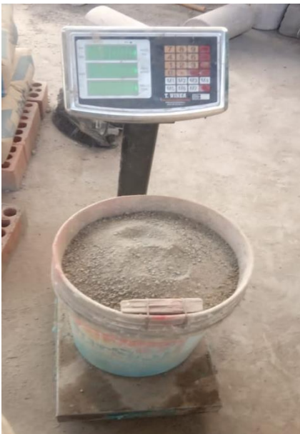
Dosificación de Agregados en Laboratorio
