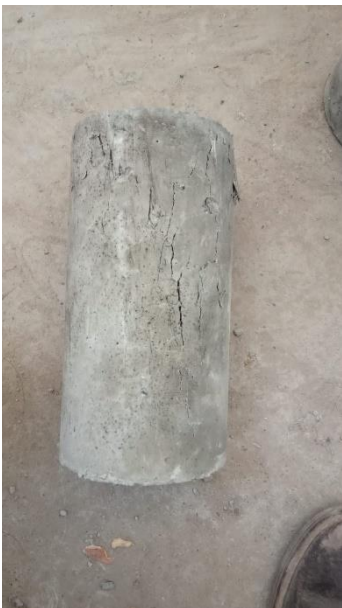
Rotura de probeta de concreto con adición de 600 g/m 3 de microfibra de polipropileno
