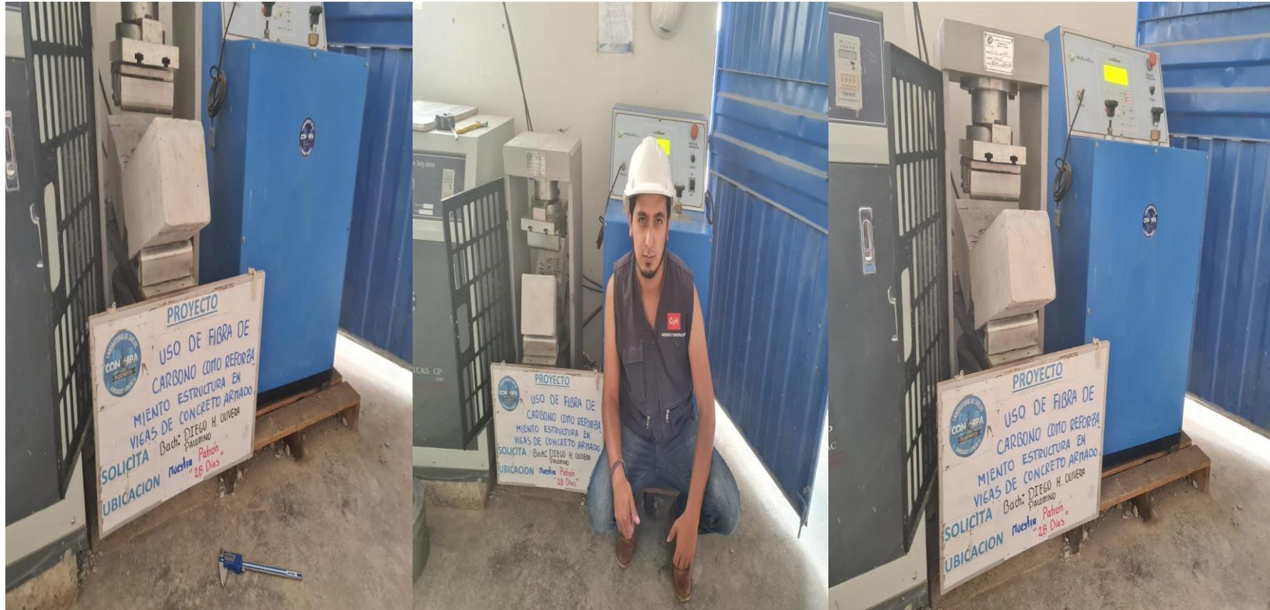
Maquina para ensayos de compresion y flexion
