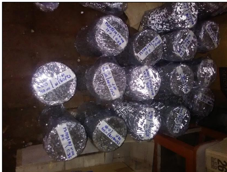
Muestra de curado de briquetas con plástico.
