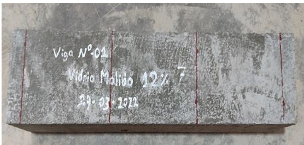
Figura 53. Muestra del prisma con respectivos trazos para el ensayo
