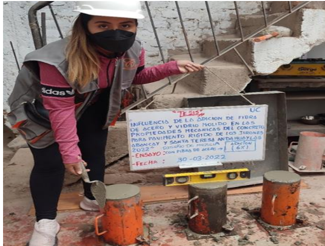
Figura 38. Manufactura de probetas con adición de fibra de acero
