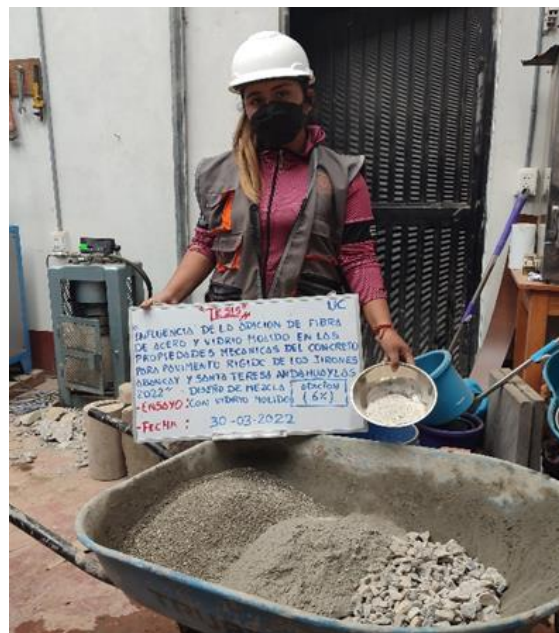
Figura 36. Mezcla de los materiales con adición de vidrio molido
