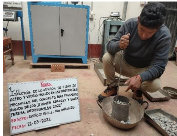
Figura 26. Varillado del agregado grueso
