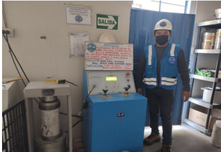
Figura 45. Ensayo a compresión con adición de fibra de acero
