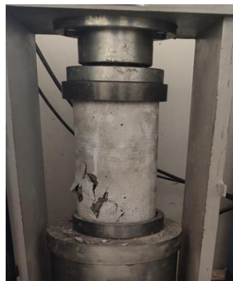
Figura 49. Fractura con adición de fibra de acero
