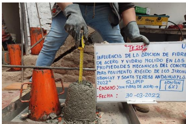
Figura 43. Slump con adición de fibra de acero
