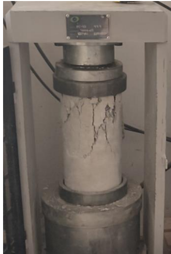
Figura 50. Fractura del concreto patrón
