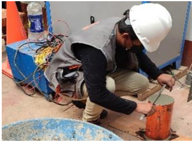
Figura 37. Manufactura de probetas cilíndricas del concreto patrón
