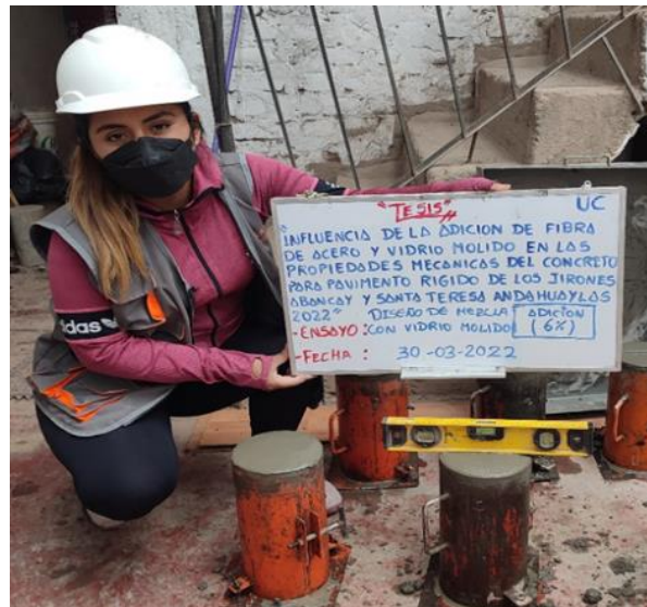
Figura 39. Manufactura de probetas con adición de vidrio molido
