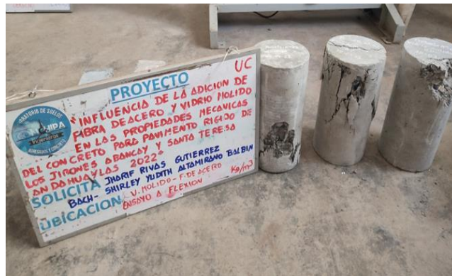
Figura 48. Fractura con adición de vidrio molido
