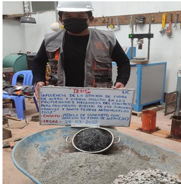
Figura 35. Mezcla de los materiales con la adición de fibra de acero
