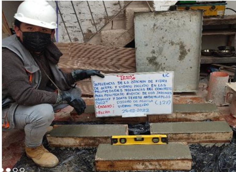
Figura 41. Manufactura de probeta prismática con adición de vidrio molido
