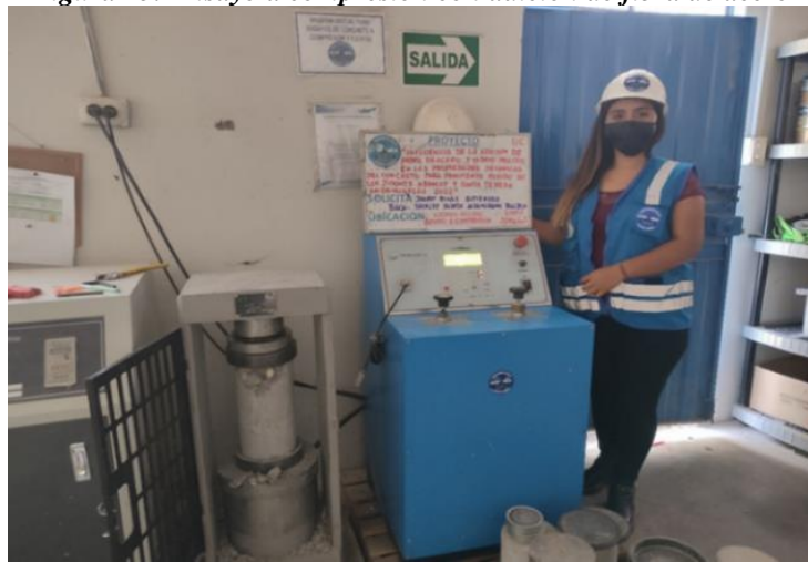
Figura 46. Ensayo a compresión con adición de vidrio molido
