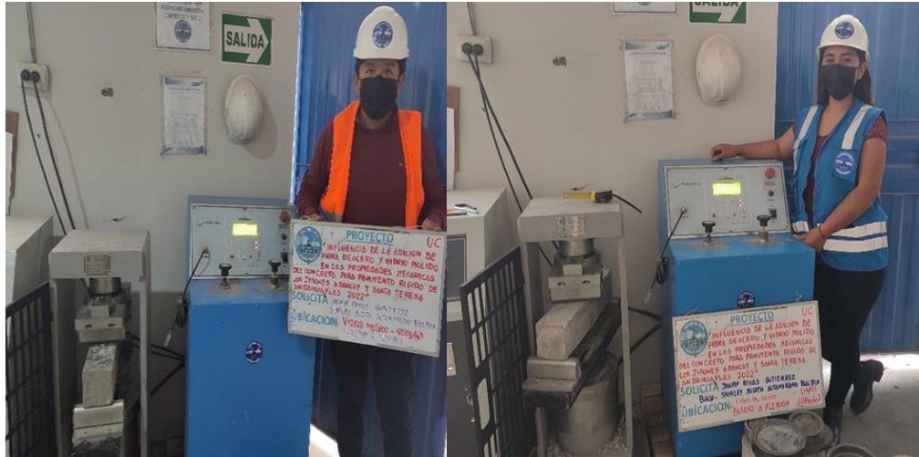
Figura 54. Rotura del ensayo a flexión
