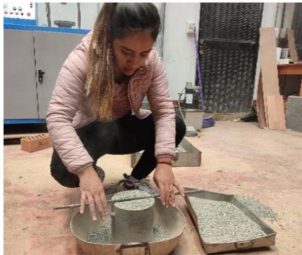
Figura 24. Varillado del agregado fino
