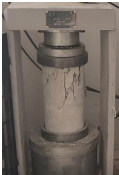
Figura 14. Rotura de la probeta cilíndrica (18)
