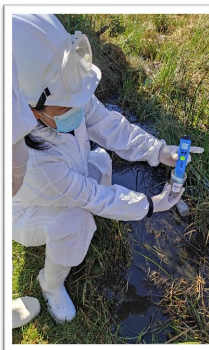
Figuras 8, 9 y 10. Medición de parámetros de campo (temperatura, conductividad eléctrica y oxígeno disuelto). Nota: Elaboración propia
