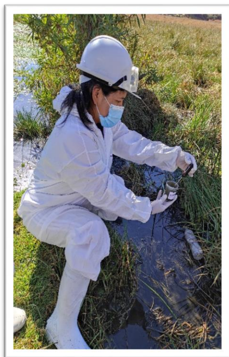
Figuras 8, 9 y 10. Medición de parámetros de campo (temperatura, conductividad eléctrica y oxígeno disuelto). Nota: Elaboración propia
