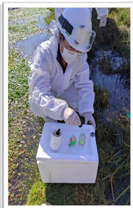
Figuras 8, 9 y 10. Medición de parámetros de campo (temperatura, conductividad eléctrica y oxígeno disuelto). Nota: Elaboración propia
