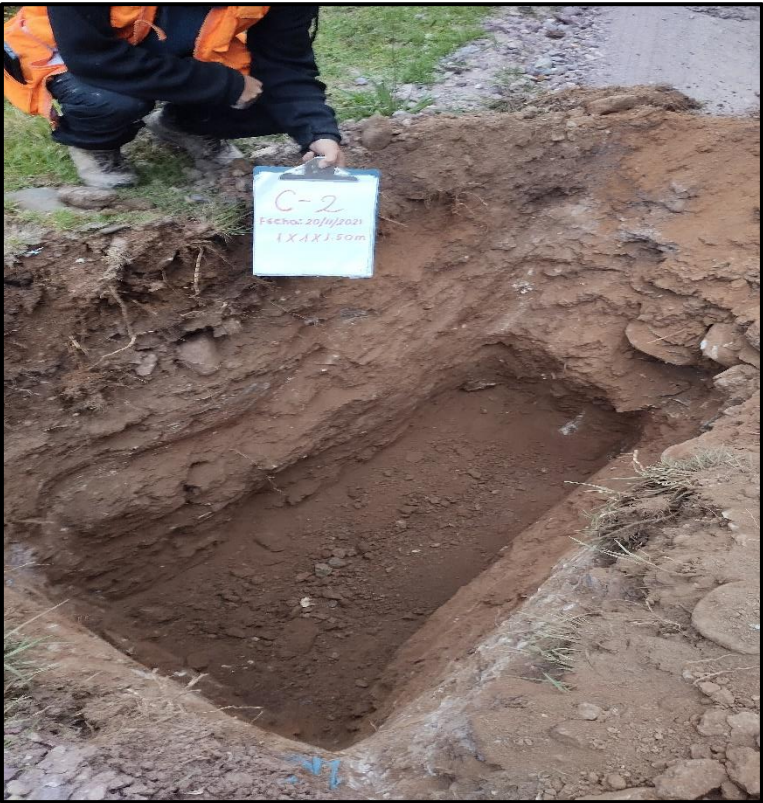
Retrato15: Excavación de la Calicata 02 para su próxima extracción de muestra
