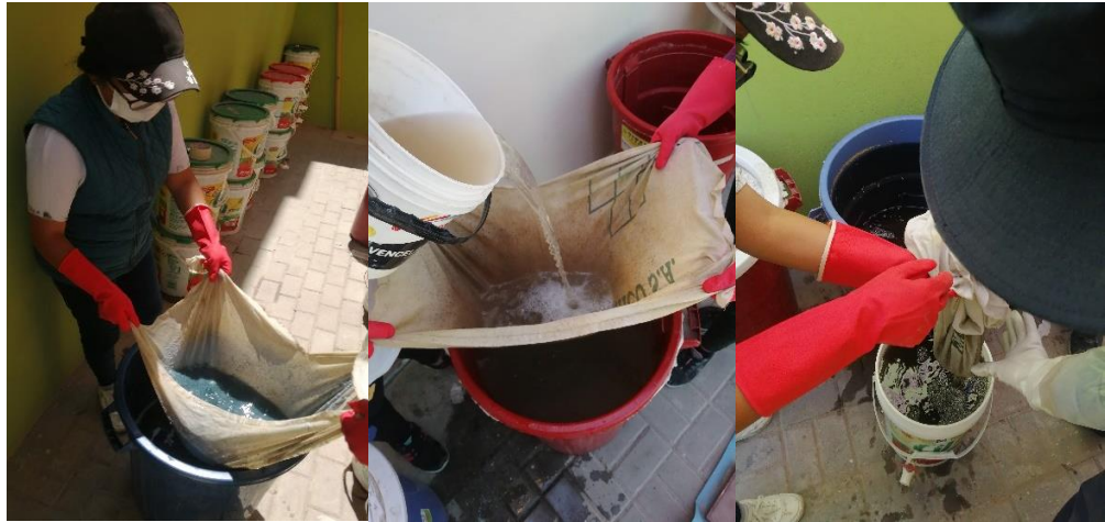
Figura 9. Tamizado y homogenización de efluentes, 2021.
