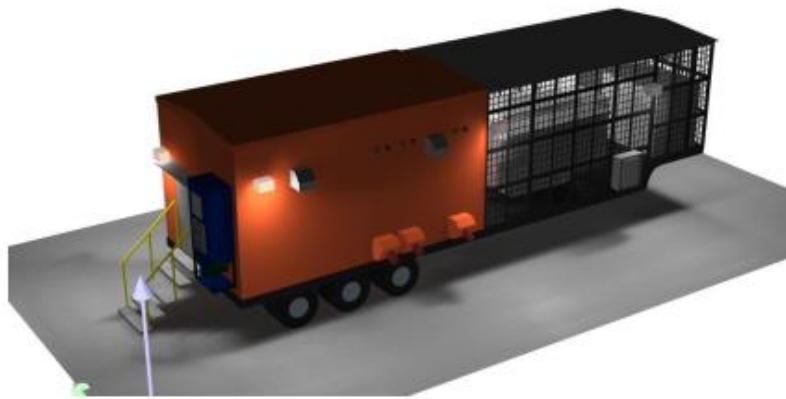
Figura 51. Imagen renderizada Subestación móvil.
