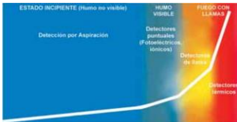
Figura 33. Tecnologías existentes para la detección de incendios según sus diferentes etapas.
