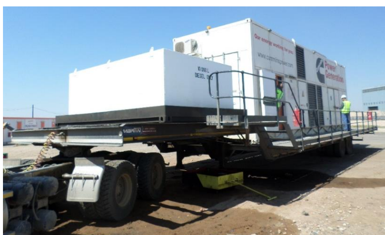
Figura 16. Motivator Cummins C2250 D que alimenta una Bucyrus 495 en una mina de diamantes en South Africa.
