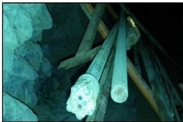
Figura 5. Barrenos 6' y brocas 38mm Tomado de Pablo Cesar Salcedo Choque (2020, p. 34)
