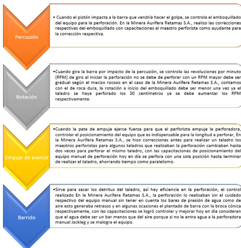
**Figura 13. Parámetros de perforación con el equipo manual Jackleg, en la minera aurífera Retamas S. A.**
