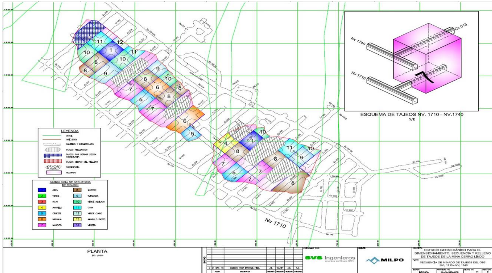
Figura 20. Plano en planta, esquema de tajeos en el Nv 1710 en la UM Cerro Lindo
