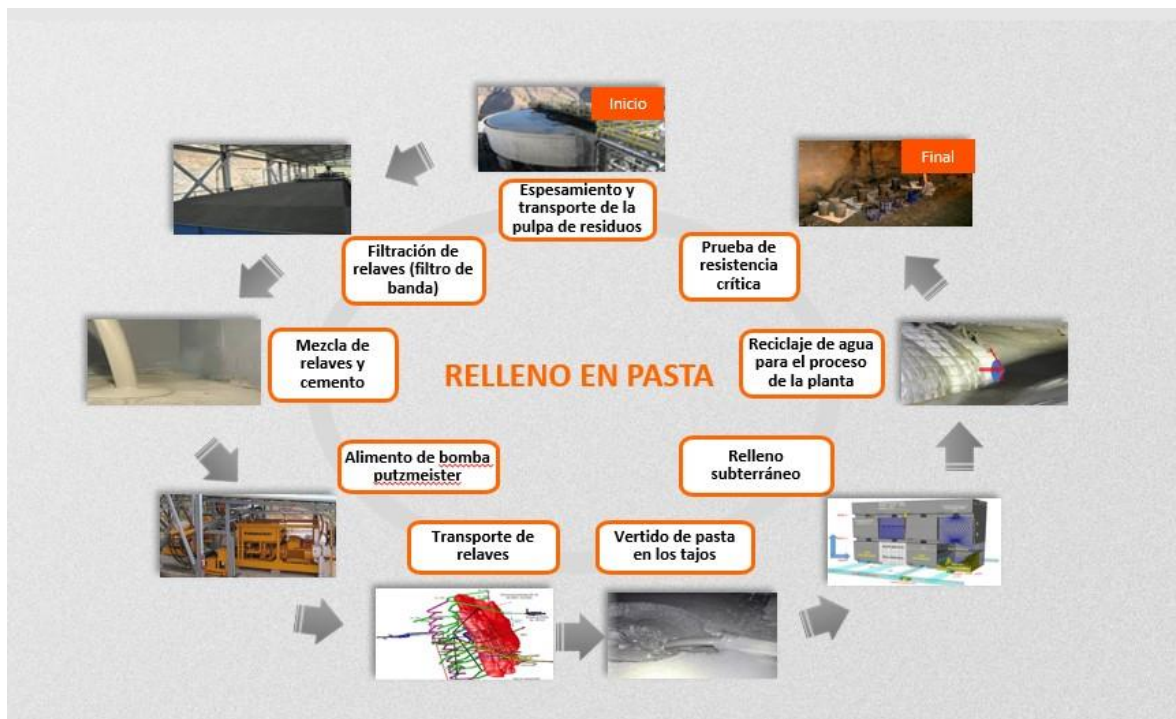
Figura 7. Proceso de relleno en pasta, UM Cerro Lindo Tomada del Departamento de Planeamiento
