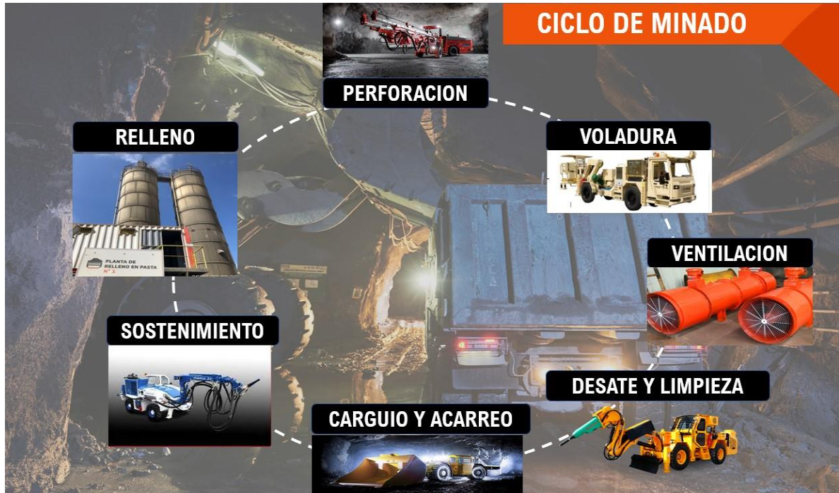
Figura 6. Ciclo de minado en la UM Cerro Lindo. Tomada del Departamento de Planeamiento
