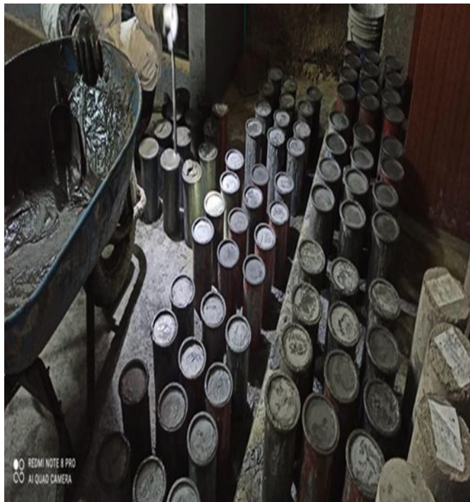
Figura 19. Muestras tomadas para el ensayo de resistencia.
