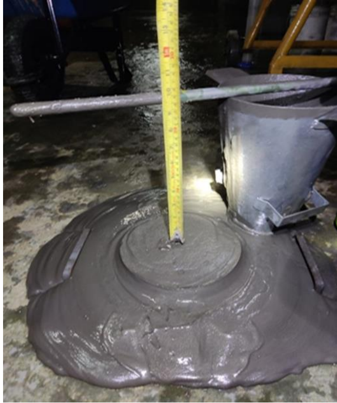
Figura 18. Prueba del slump antes de la toma de la muestra
