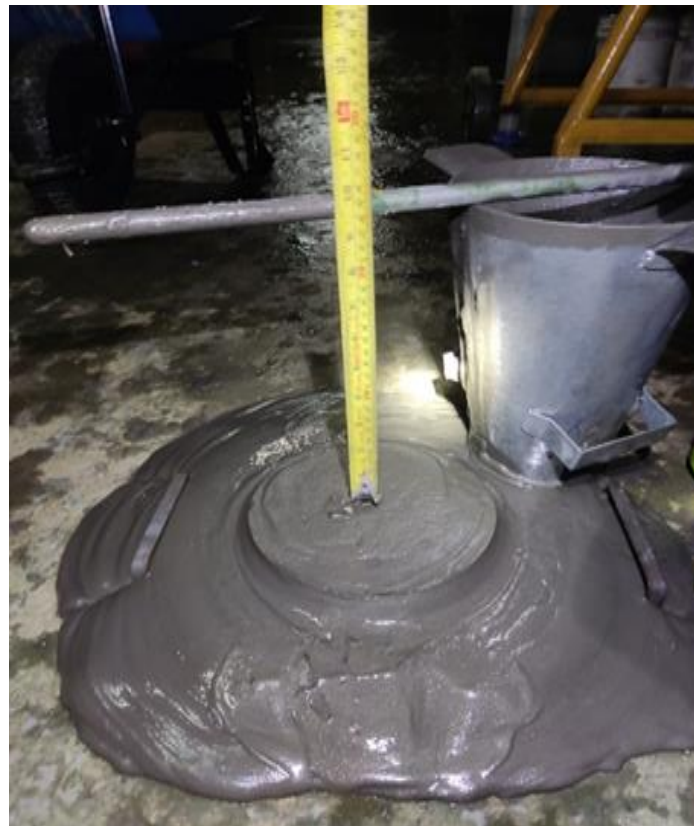
Figura 18. Prueba del slump antes de la toma de la muestra
