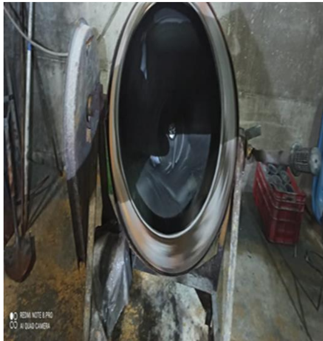
Figura 17. Mezcla del aditivo Immozem y cemento.
