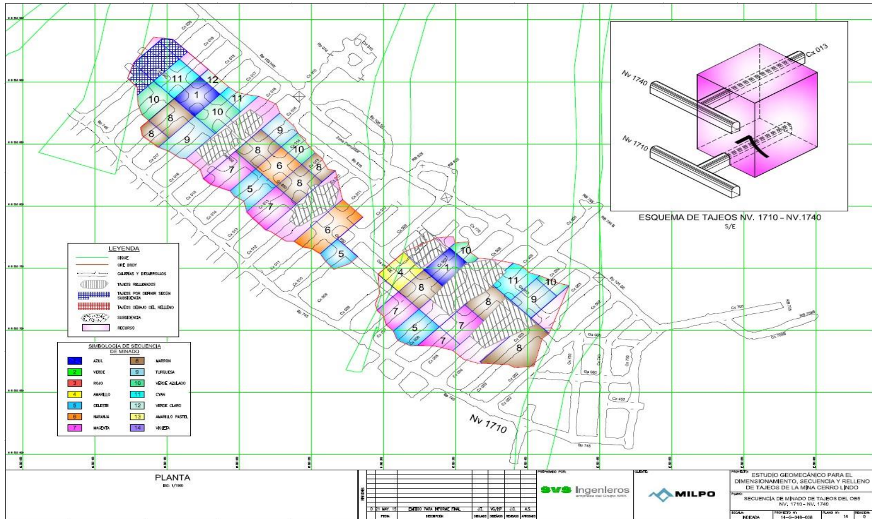
Figura 20. Plano en planta, esquema de tajeos en el Nv 1710 en la UM Cerro Lindo Tomada del Departamento de Planeamiento
