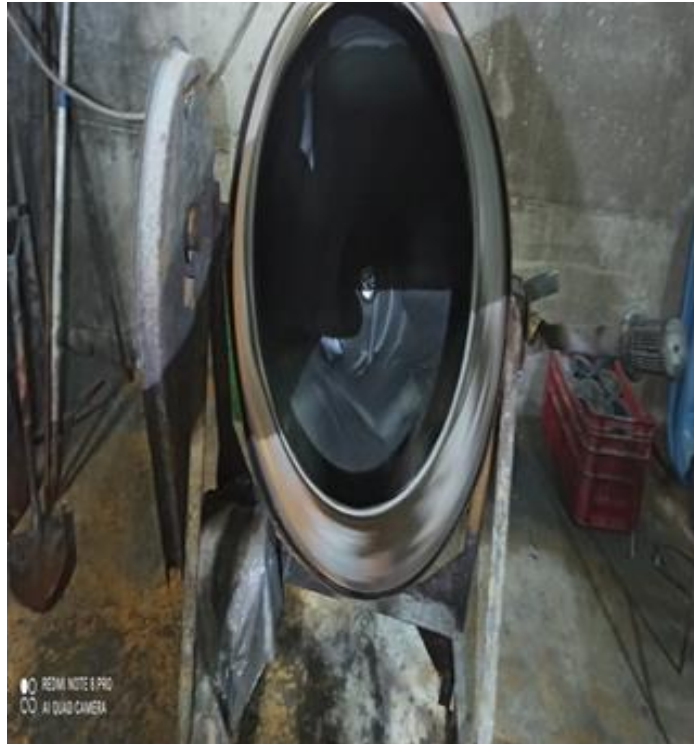
Figura 17. Mezcla del aditivo Immozem y cemento
