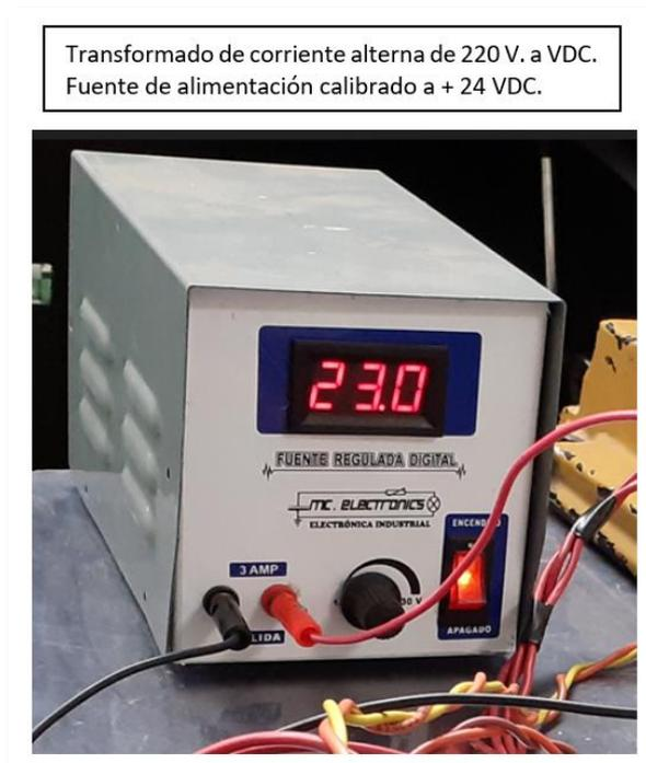
Figura N° 93. Transformador de corriente alterna a +24 VDC.
