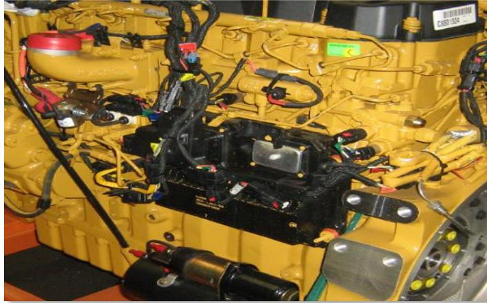
*Figura N° 46. Módulo de control electrónico del motor.*
