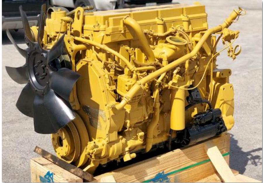
*Figura N° 1. Motor diésel C11.*
