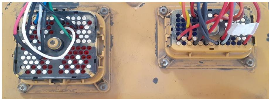
Figura N° 91. Ajuste de los conectores deutsch J1 – J2.
