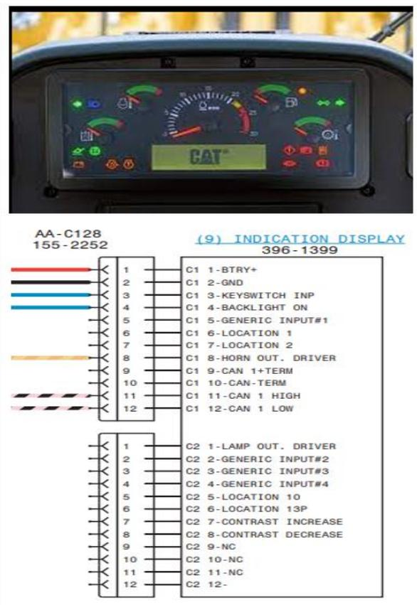
Figura N° 36. Esquema de tablero de indicadores de nivel.
