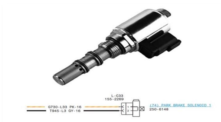
Figura N° 30. Esquema de solenoide del freno de parqueo.
