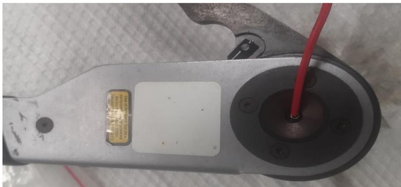
**Anexo 03. Prensador Caterpillar para terminales socket.**
