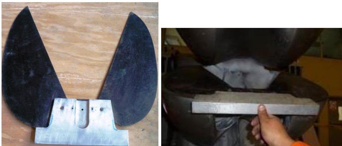
Figura 35: Uso de la plantilla de Espesor de copa.
