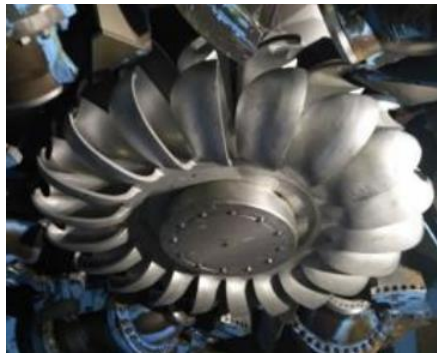
Figura 19: Inspección Visual de la Turbina Pelton.
