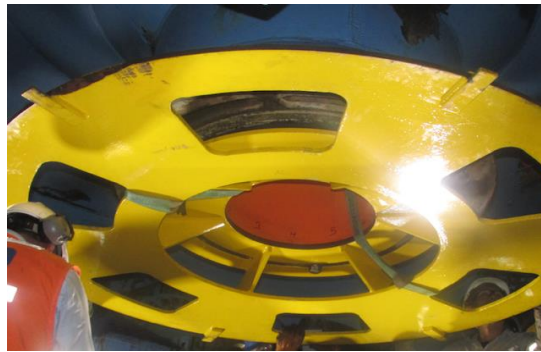
Figura 41: Posicionamiento y fijación de disco.
