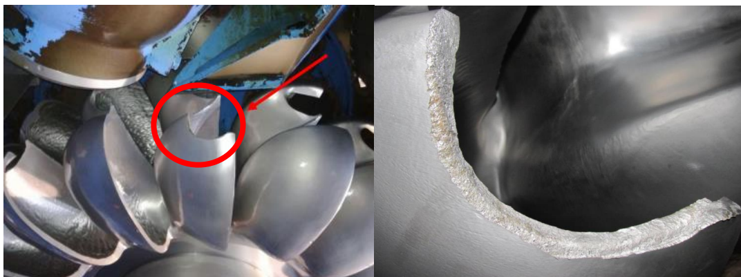
Figura 20: Ruptura de un segmento de la cuchara 9.
