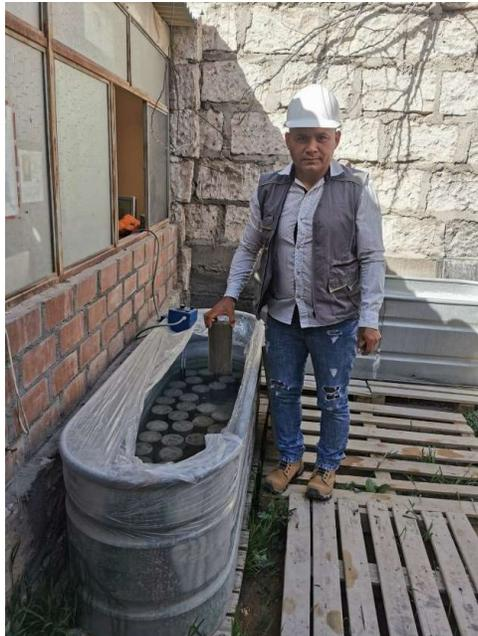
**FOTO N° 16:** colocación de muestras en la cisterna para el curado correspondiente del concreto.
