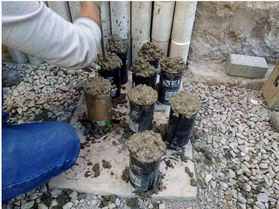
FOTO N° 14: llenado de briquetas con las muestras del concreto.
