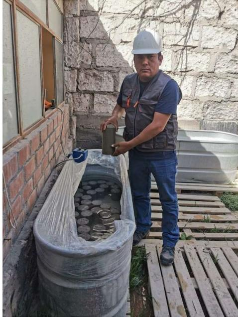
**FOTO N° 15:** colocación de muestras en la cisterna para el curado correspondiente del concreto.
