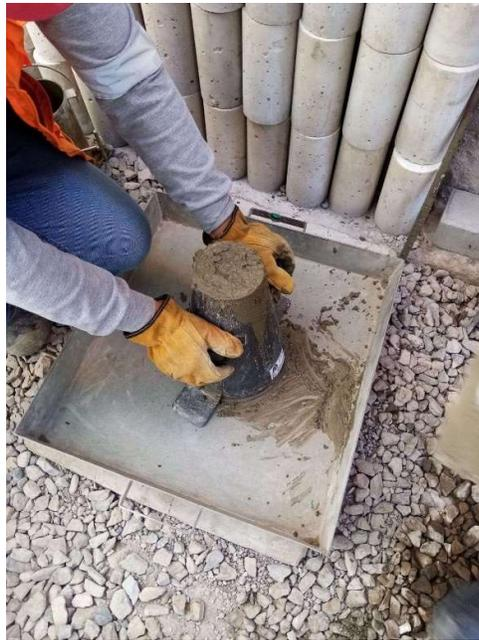
**FOTO N° 08:** llenado de concreto al Cono de Abrams.
