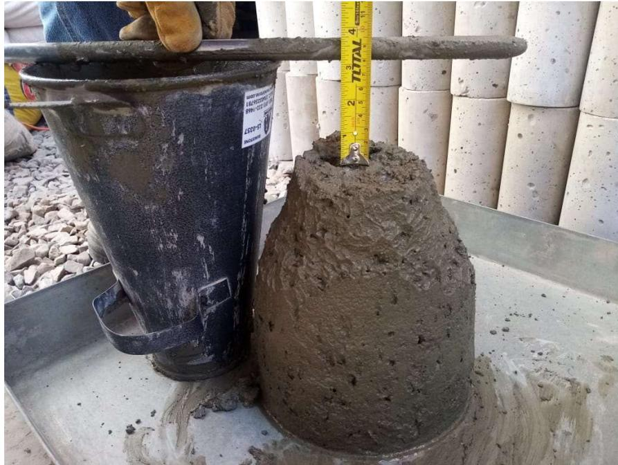
**FOTO N° 09:** realizando prueba de asentamiento o Slump.
