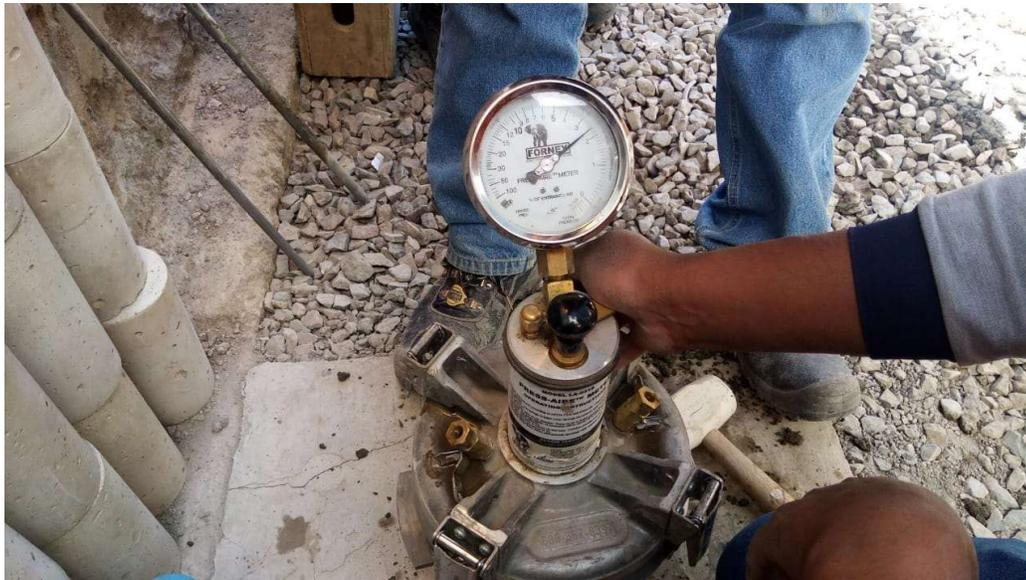
**FOTO N° 12:** determinación de contenido de aire en el concreto con un Medidor de Aire Tipo B.
