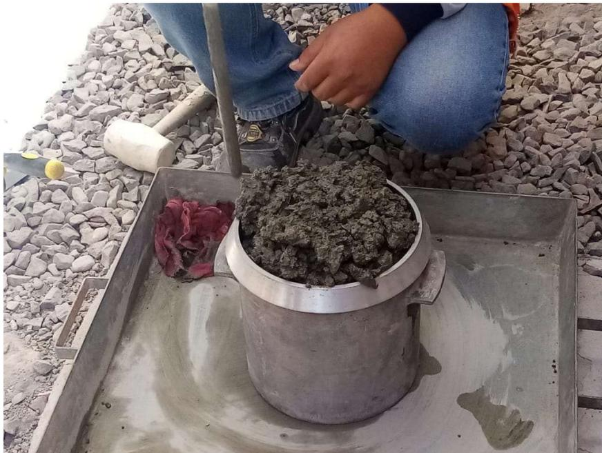
**FOTO N° 10:** realizando llenado de recipiente para la determinación de contenido de aire en el concreto.
