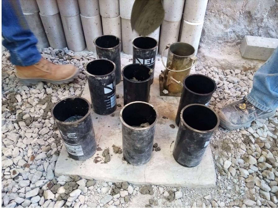
FOTO N° 13: briquetas para la toma de muestras del concreto.
