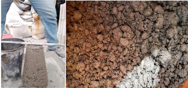
**Figura 9.** Consistencia y asentamiento del concreto con 5 % de CCA.
