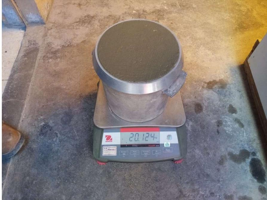
**FOTO N° 11:** recipiente listo para la determinación de contenido de aire en el concreto.
