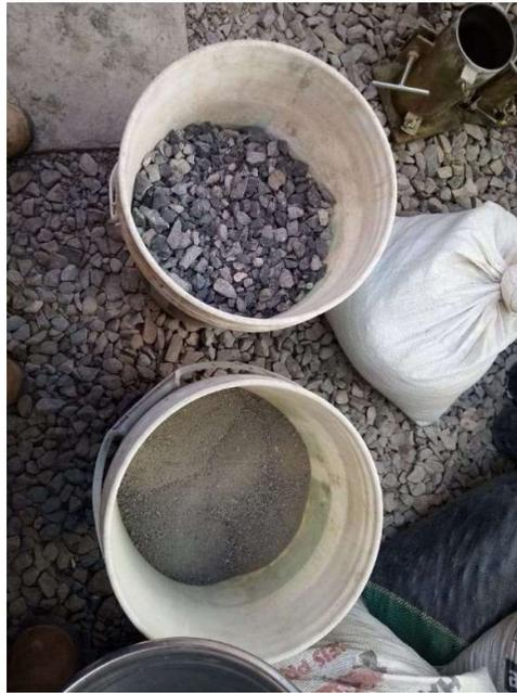
**FOTO N° 04:** dosificación de agregado fino y agregado grueso.
